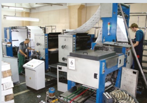
Часть производственного парка рулонного офсетного оборудования для изготовления однокрасочной многополосной продукции
