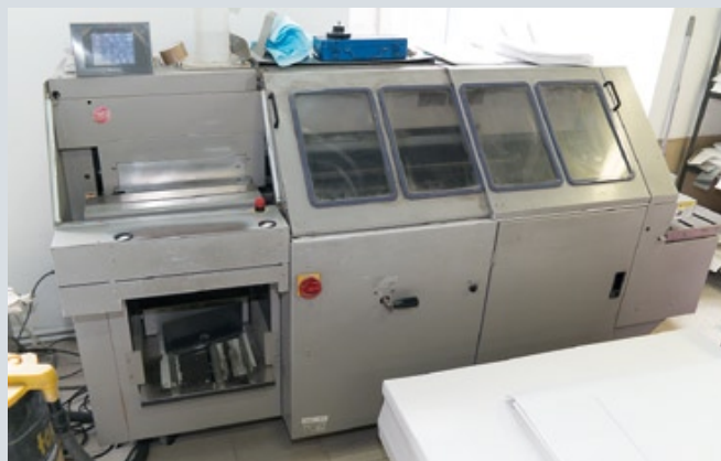
Послепечатный комплекс для изготовления многополосной печатной продукции (каталоги, брошюры, журналы, книги)
