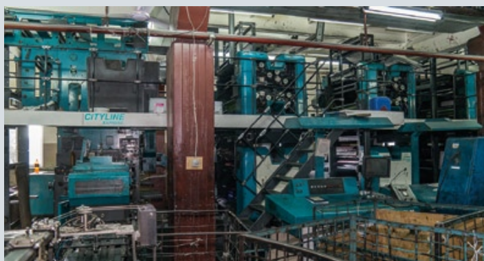
Часть производственного парка рулонного офсетного оборудования для изготовления однокрасочной многополосной продукции
