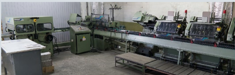
ВЛШРА от компании Muller Martini и японской Osako для автоматизированного изготовления журналов, брошюр и книг, подобранных «внакидку» и сшитых проволокой
