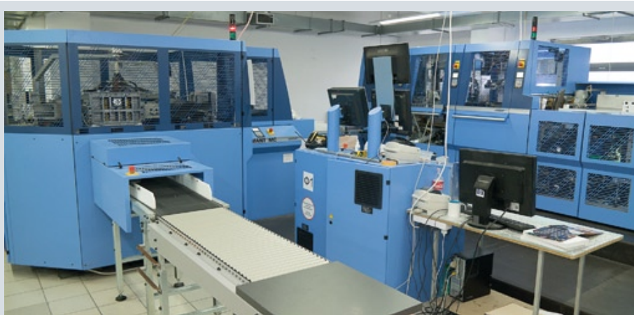
Цифровая автоматизированная линия Muller Martini Diamant MC Book Of One для производства книг в твердом переплете. Оборудование предоставляет возможность изготавливать единичные экземпляры книг (причем каждую последующую с индивидуальными характеристиками) с высоким профессиональным качеством
