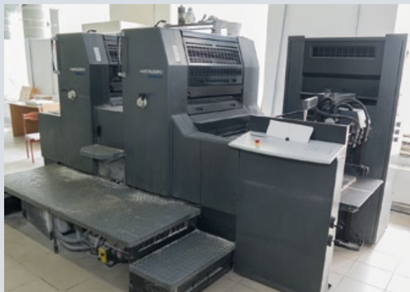
Машина третьего формата четырехкрасочная Printmaster 52 и Printmaster 74-2 с секцией переворота листа
