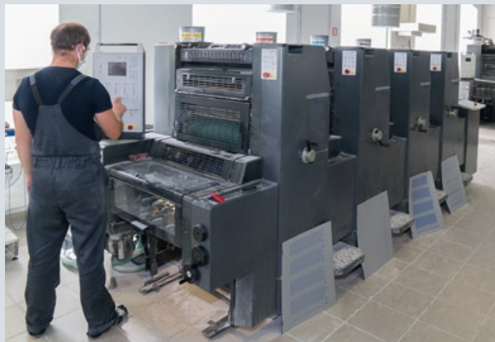
Машина третьего формата четырехкрасочная Printmaster 52 и Printmaster 74-2 с секцией переворота листа
