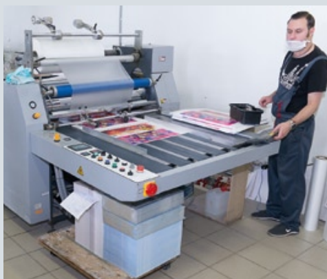
Часть оборудования типографии для декоративной отделки отпечатанных листов — пресс для тиснения фольгой и машина для ламинирования
