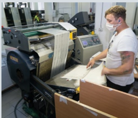
Часть оборудования типографии для декоративной отделки отпечатанных листов — пресс для тиснения фольгой и машина для ламинирования
