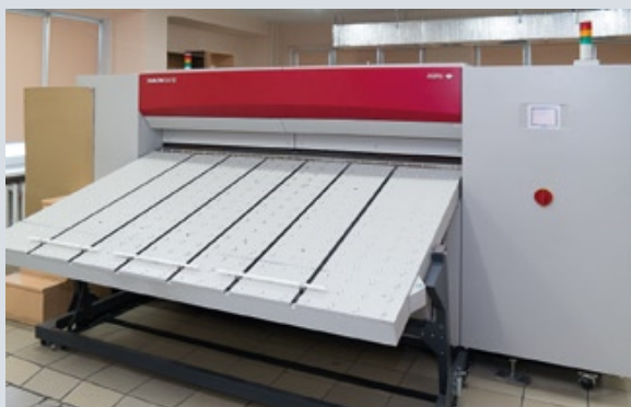
Комплекс допечатного оборудования состоит преимущественно из CtP-устройств компании Agfa
