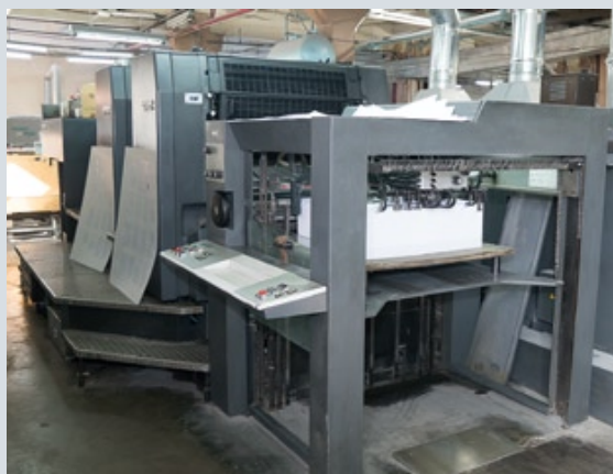
Для производства продукции в одну-две краски на предприятии используют машины Heidelberg с секцией переворота листа
