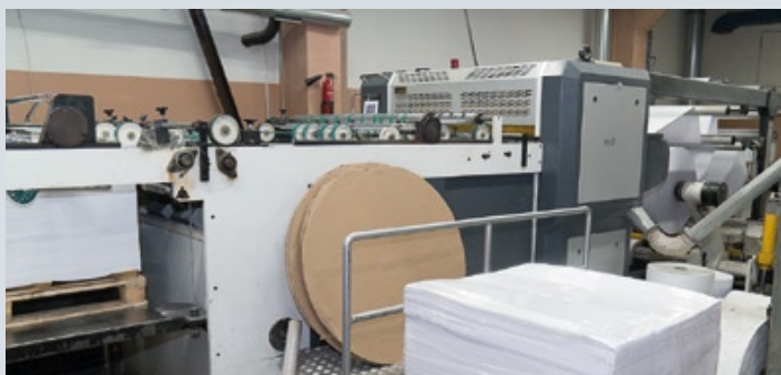
Размотка рулонов осуществляется на флорезальном оборудовании, поставленном компанией «ВИП-Системы»
