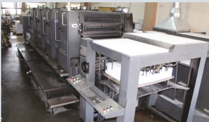
Для производства продукции в одну-две краски на предприятии используют машины Heidelberg с секцией переворота листа
