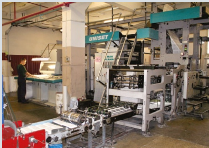
Рулонная печатная машина Uniset 84 компании manroland позволяет печатать книжные блоки «двойником»
