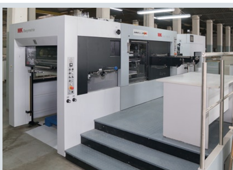
В начале этого года на производственной площадке полиграфического холдинга X-PRESS был инсталлирован новый вырубной пресс МК Easymatrix 106 CS первого формата с функцией удаления облоя. Оборудование приобретено с целью увеличения мощностей для производства упаковочной продукции
