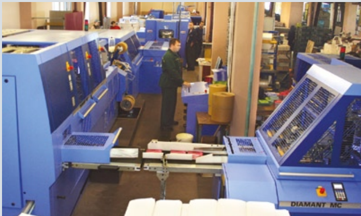
Крышкоделательная машина BDM Universal. На предприятии насчитывается 8 единиц оборудования для изготовления различных переплетных крышек
