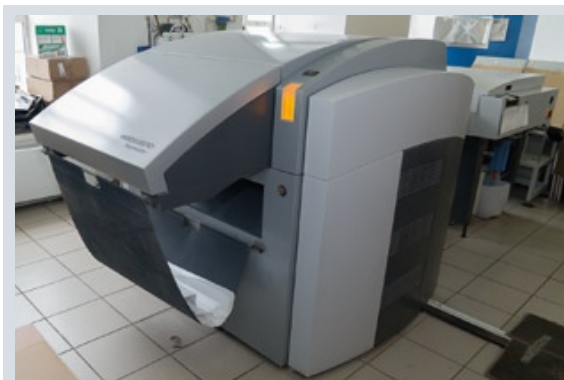
Печатные формы для всех трех офсетных машин выводятся на CtP-устройстве Suprasetter A75
