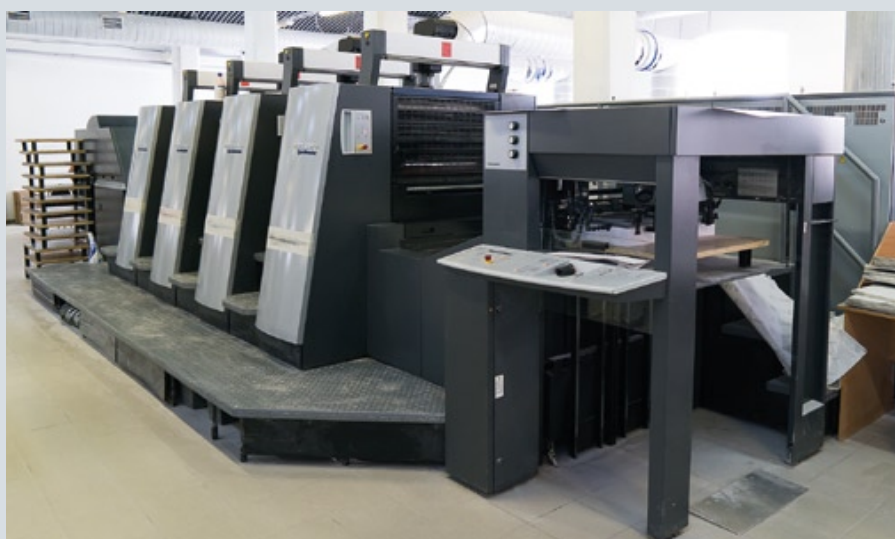
Печатный парк типографии X-PRESS представлен офсетными машинами компании Heidelberg. На фото: четырехкрасочная машина Speedmaster XL 75, позволяющая изготавливать любую продукцию: рекламную, книжно-журнальную, упаковочную
