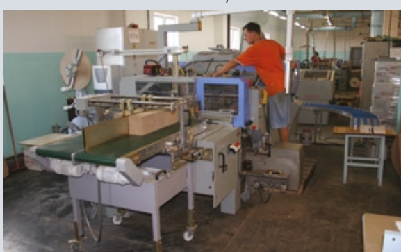
Крышкоделательная машина BDM Universal. На предприятии насчитывается 8 единиц оборудования для изготовления различных переплетных крышек
