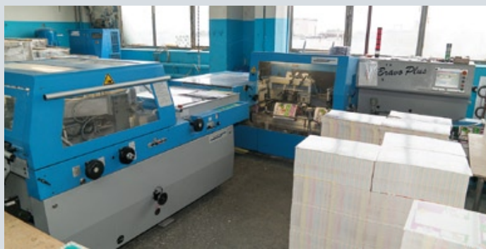
На предприятии установили несколько линий ВШРА, чтобы сократить количество переналадок с одной продукции на другую. Одна из них — Muller Martini, восстановленная и смонтированная специалистами ООО «Мюллер Мартини РУ»
