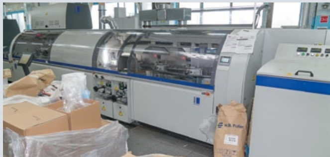
На производстве появилась и высокоавтоматизированная скоростная линия клеевого бесшвейного скрепления Kolbus (теперь это часть компании Muller Martini)
