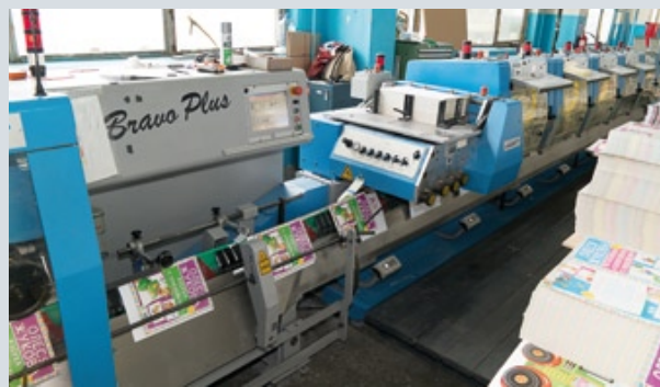
На предприятии установили несколько линий ВШРА, чтобы сократить количество переналадок с одной продукции на другую. Одна из них — Muller Martini, восстановленная и смонтированная специалистами ООО «Мюллер Мартини РУ»
