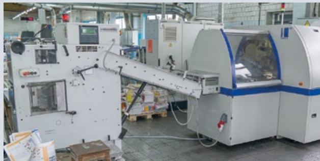
На производстве появилась и высокоавтоматизированная скоростная линия клеевого бесшвейного скрепления Kolbus (теперь это часть компании Muller Martini)
