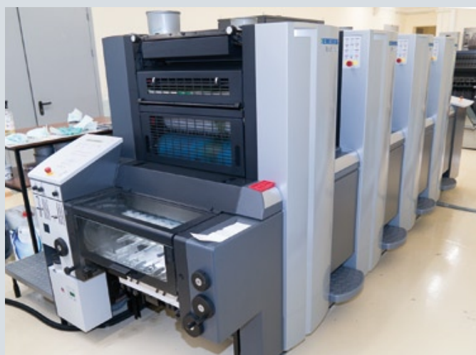
В ГБПОУ МИПК им. И. Федорова установлена четырехкрасочная печатная машина Heidelberg Speedmaster SX 52. На этом оборудовании проходила подготовка студентов к участию в мировом чемпионате по профессиональному мастерству по стандартам WorldSkills
