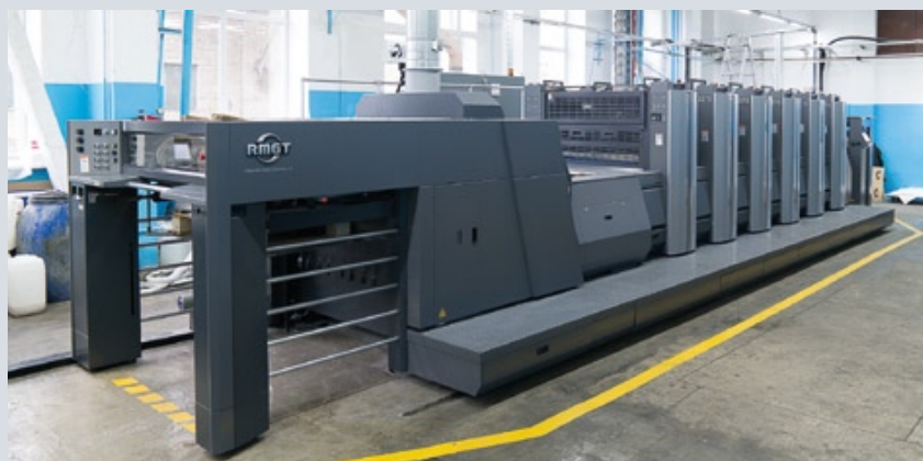
Результатом решения руководства АО «Кострома» об усилении листового подразделения стала установка новой пятикрасочной печатной машины RMGT 920ST-5 с секцией лакирования
