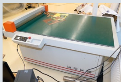
Плоттер для работы с картоном и раскрой упаковки
