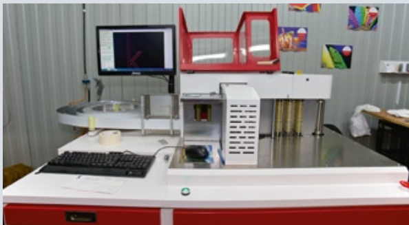
Оборудование для изготовления объемных букв из алюминиевого профиля с использованием технологии жидкого акрила
