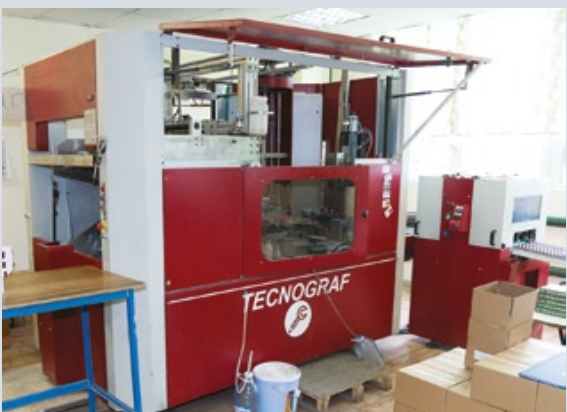
Книгоставочная машина (слева), ручная книгоставочная машина (справа) для единичных тиражей
