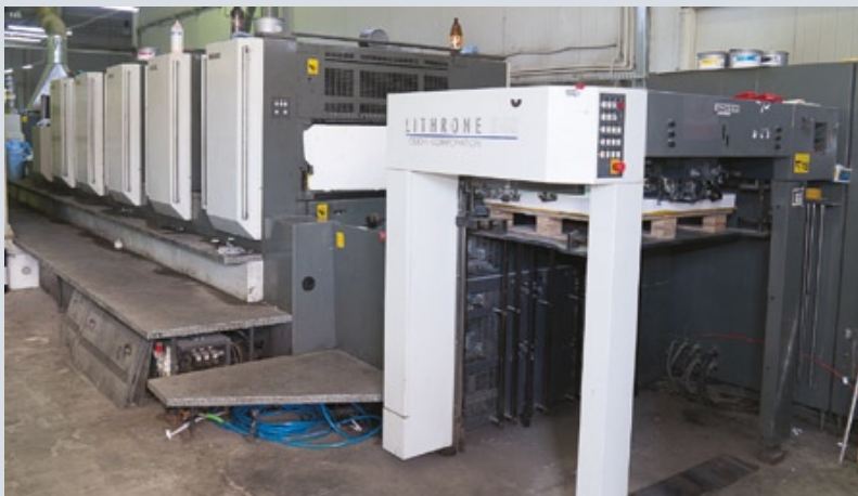
Основной специализацией Forte Press является производство высококачественной многостраничной периодики. Журнальные блоки печатаются на пятикрасочной машине Komori Lithrone S40 с секцией лакирования
