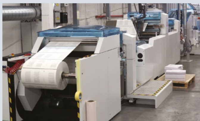
На рулонной струйной цифровой печатной машине Océ ColorStream 6500 печатают блоки черно-белых изданий тиражами до 1200 экз. Машина интегрирована в линию с послепечатным оборудованием Hunkeler
