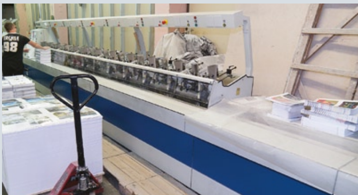
Послепечатный парк оборудования типографии выстроен для производства многополосной продукции: листоподборочная линия, фальцевальная машина, резальное оборудование и другое
