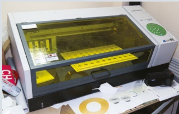
УФ-плоттер для печати на различных поверхностях. Используется для брендинга сувенирной продукции
