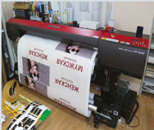
Оборудование для широкоформатной печати. На этих устройствах в типографии изготавливают самоклеящиеся этикетки и рекламные стикеры (причем сразу с надсечкой), а также выставочный и интерьерный декор
