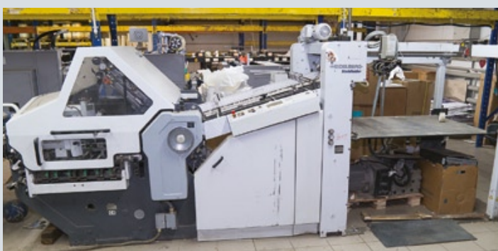
Часть комплекса послепечатного оборудования для производства журнальной продукции: листоподборочная линия, машина для клеевого бесшвейного скрепления, фальцевальная машина
