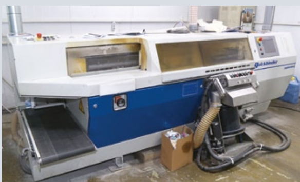
Часть комплекса послепечатного оборудования для производства журнальной продукции: листоподборочная линия, машина для клеевого бесшвейного скрепления, фальцевальная машина
