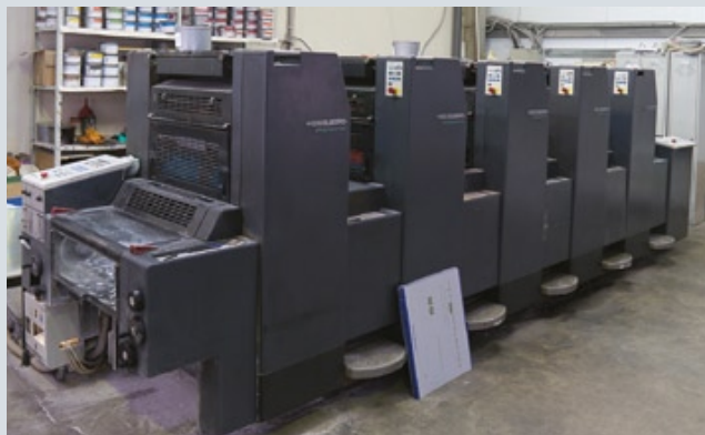
Печатный парк типографии Forte Press представлен как полуформатными машинами, так и оборудованием первого формата. На пятикрасочной Heidelberg Speedmaster 74, оснащенной секцией лакирования и УФ-сушкой для работы с высокорективными УФ-красками и лаками (на фото справа), здесь изготавливают обложки журналов, а в перспективе — упаковочную продукцию
