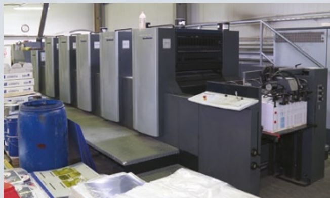
Печатный парк типографии Forte Press представлен как полуформатными машинами, так и оборудованием первого формата. На пятикрасочной Heidelberg Speedmaster 74, оснащенной секцией лакирования и УФ-сушкой для работы с высокорективными УФ-красками и лаками (на фото справа), здесь изготавливают обложки журналов, а в перспективе — упаковочную продукцию
