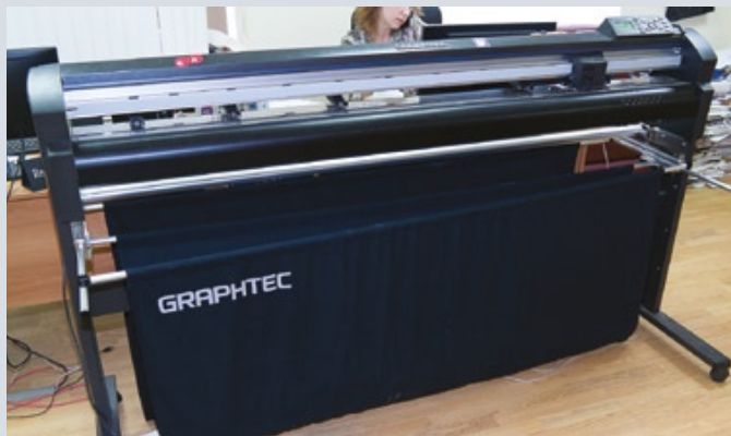
Оборудование для широкоформатной печати. На этих устройствах в типографии изготавливают самоклеящиеся этикетки и рекламные стикеры (причем сразу с надсечкой), а также выставочный и интерьерный декор
