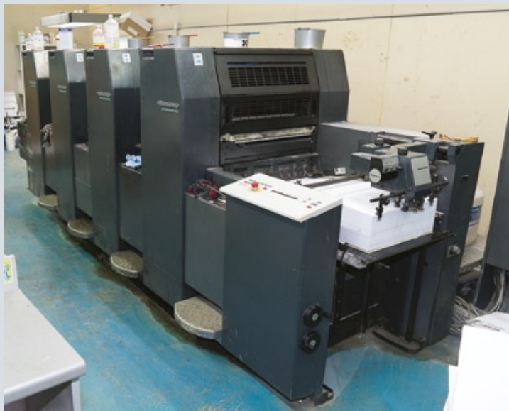
В типографии самым оптимальным образом сочетают возможности офсетной и цифровой печати. Для изготовления печатных форм используется StP-устройство Heidelberg и пластины Agfa
