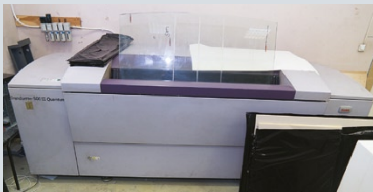
Для вывода форм на CtP-устройстве Kodak используются термальные пластины Fujifilm
