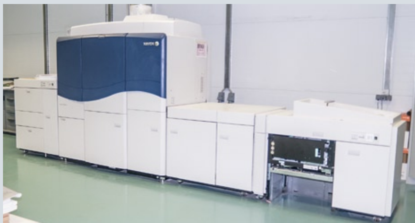
Для печати некоторых малотиражных черно-белых книг используется машина Xerox Nuvera (вверху), а для печати высококачественных обложек или покровного материала для переплетных крышек применяется Xerox iGen 150
