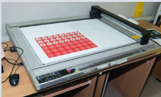
В типографии есть дополнительное оборудование, в частности, еще одно небольшое печатное устройство, а также режущий плоттер, позволяющий изготавливать упаковку или самоклеящиеся этикетки и наклейки
