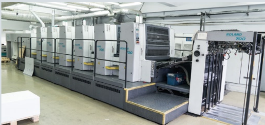
Гибридный шестикрасочный Roland 700 используется в типографии «МДМ-Печать» для изготовления обложек журналов и каталогов, в том числе с использованием сплошного или выборочного twin-лакирования
