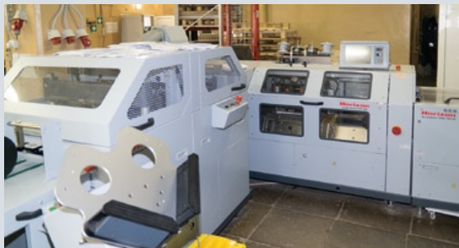
Комплекс послепечатного оборудования Horizon: машина бесшвейного скрепления, автомат ротационной высечки, комплекс для скрепления проволоочными скобами
