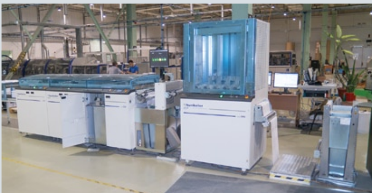
Для преобразования запечатанного бумажного полотна в подобранные комплекты будущей книги используются автоматизированные послепечатные комплексы компании Hunkeler, которые могут работать как в линию с печатной машиной, так и отдельно, обрабатывая готовые рулоны бумаги (осуществляют фальцовку, рубку, подборку, выклад готовых к дальнейшей обработке комплектов)
