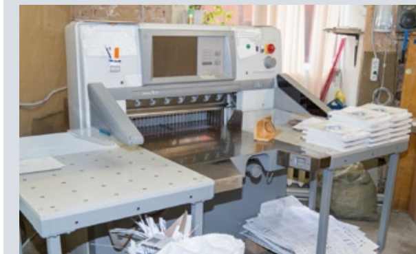
Помимо Horizon, в типографии работает и другое послепечатное оборудование: фальцовка MBO, ниткошвейная машина Smyth, резак Polar
