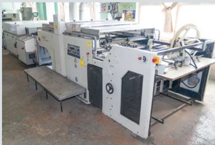
Линия трафаретной печати используется, как правило, для выборочного лакирования различными видами лака
