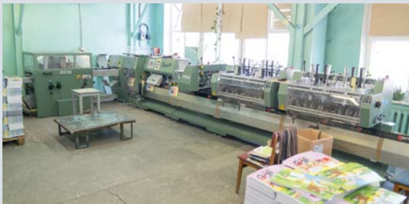
Для изготовления изданий на скобе используется вкладочно-швейно-резальный агрегат производства компании Muller Martini
