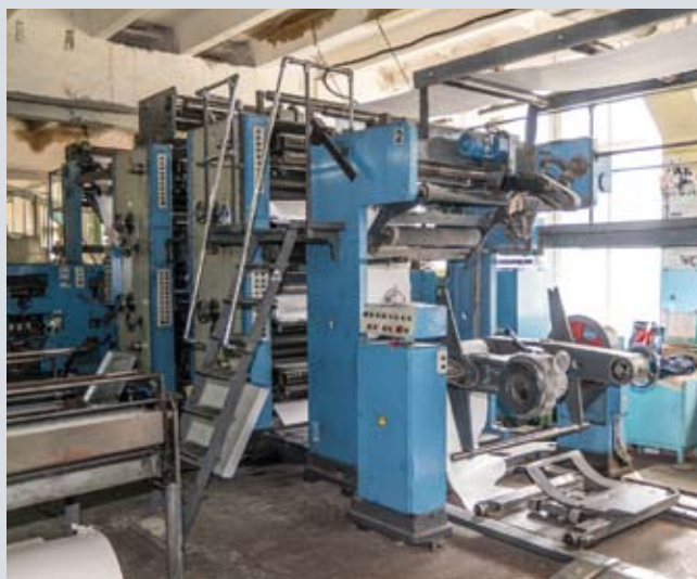
Основу печатного парка типографии составляют рулонные офсетные одно- и двухкрасочные машины производства Рыбинского завода и листовая четырехкрасочная машина KBA Rapida 105
