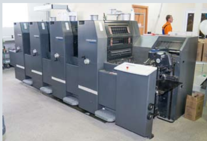
Эти машины серии Heidelberg Printmaster 52 уже несколько лет работают в типографии «Константа»...
