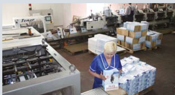
Для изготовления брошюр на скрепке применяется вкладочно-швейно-резальный автомат Osaka Tener-L
