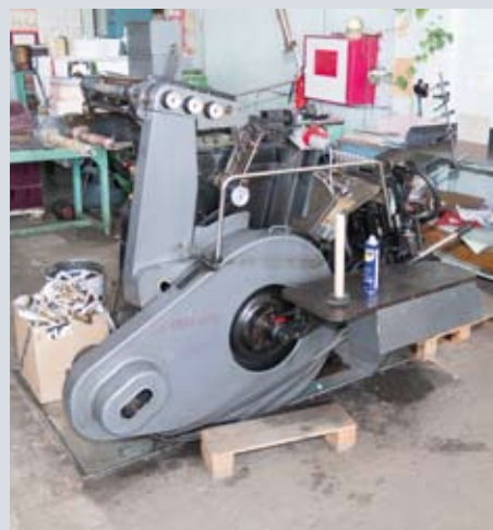
Тиснение фольгой на переплетных крышках осуществляется на тигельных прессах Heidelberg с автоматической подачей заготовок
