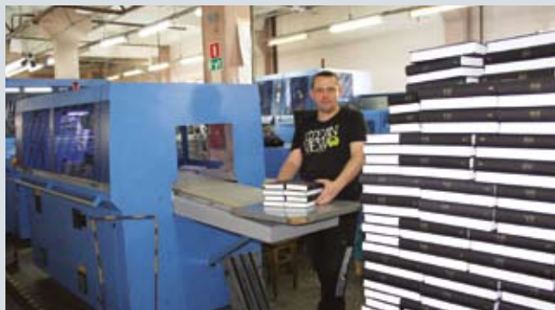
Линия Muller Martini Diamant MC 60 появилась в типографии в 2010 г. Она предназначена для эффективного производства книг в твердом переплете, с возможностью успешно работать на малых тиражах с высоким качеством
