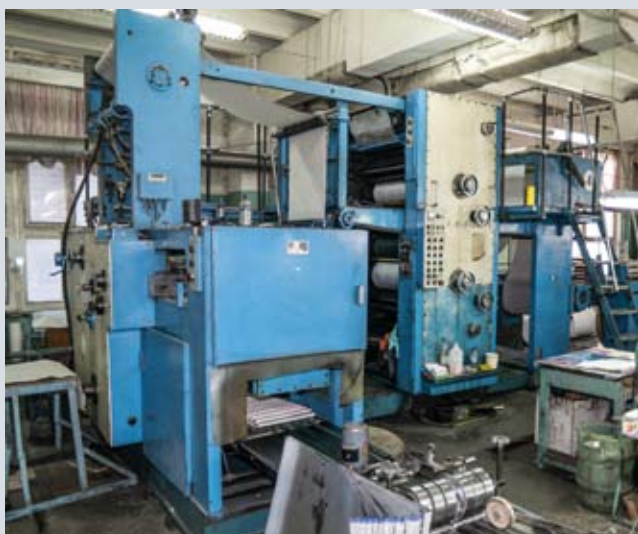
Основу печатного парка типографии составляют рулонные офсетные одно- и двухкрасочные машины производства Рыбинского завода и листовая четырехкрасочная машина KBA Rapida 105
