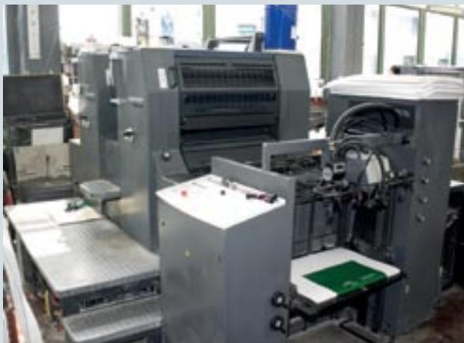
Парк офсетной печатной техники в типографии «ФС-Принт» весьма разнообразен — машины разных производителей и разных годов выпуска. Флагманская модель — четырехкрасочная Shinohara полулиственного формата. В «ФС-Принт» умеют автоматически подбирать наиболее оптимальные заказы для каждой печатной машины
