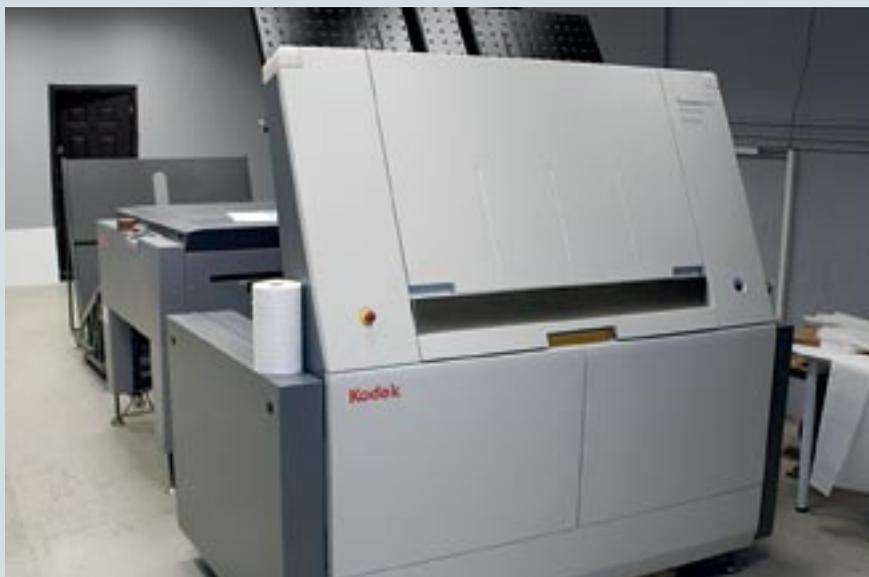
*В типографии установлено высокопроизводительное устройство CtP Kodak Trendsetter 800 с форматом пластин более 70x100 см*
