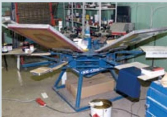
Как в любой универсальной типографии, в «ФС-Принт» много вспомогательного и отделочного оборудования, в том числе для вырубки (в частности, разверток упаковки) и трафарета для декорирования оттисков как с офсетных, так и с цифровых машин
