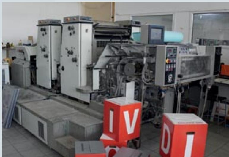
Одна из приобретенных в прежние годы машин Adast Dominant пока еще в строю, в настоящее время она используется для печати несложной продукции в одну-две краски
