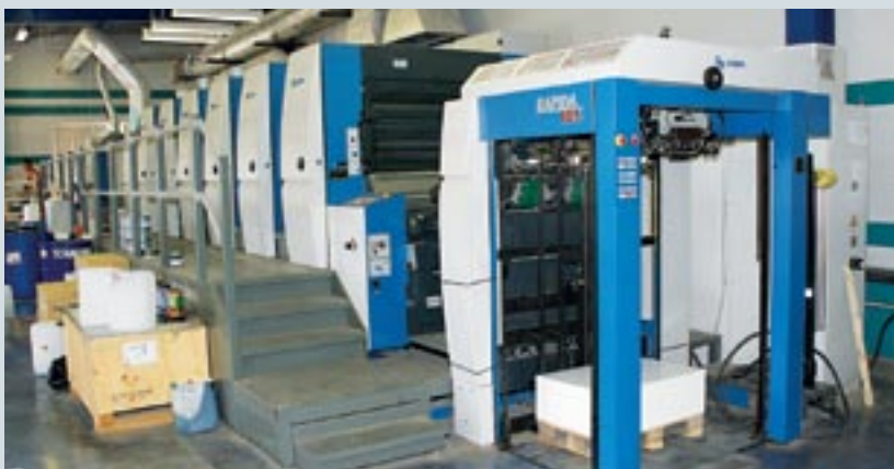
Шестикрасочная офсетная машина с лаковой секцией KBA Rapida 105 используется в основном для печати тетрадных обложек на сложных материалах
