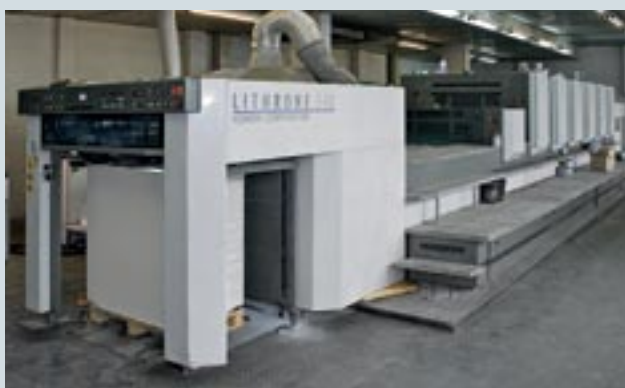
Парк печатного оборудования в ОАО «Упаковка» составляют машины Komori формата 70x100 см разных поколений, в том числе новая шестикрасочная машина с лаковой секцией Lithrone S40 в УФ-исполнении (вверху)
