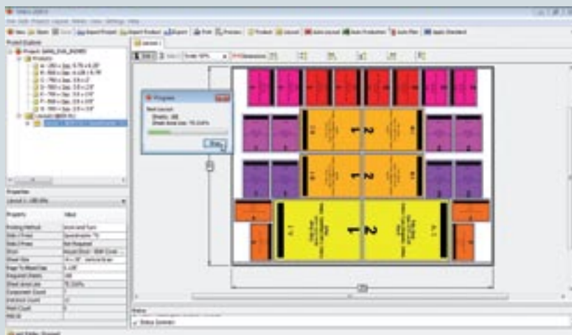
Рис. 2. Условный спуск полос на формат листа 70x100 см, на котором собраны сразу несколько типовых заказов
