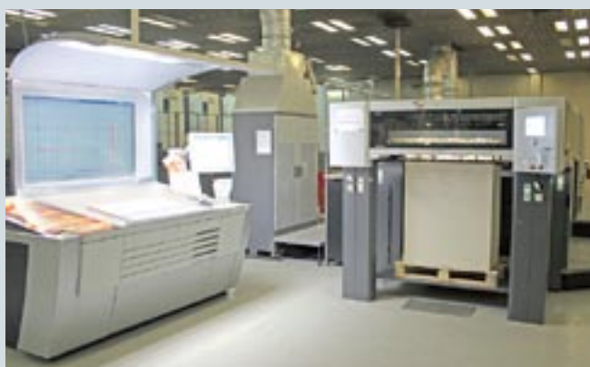
Prinect Press Center с монитором WalleScreen — пульт управления печатной машиной Speedmaster CX 102
