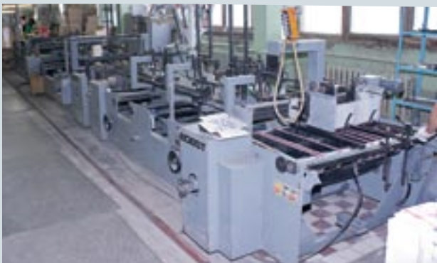
Коробки фальцуются и склеиваются на линии BOBST
