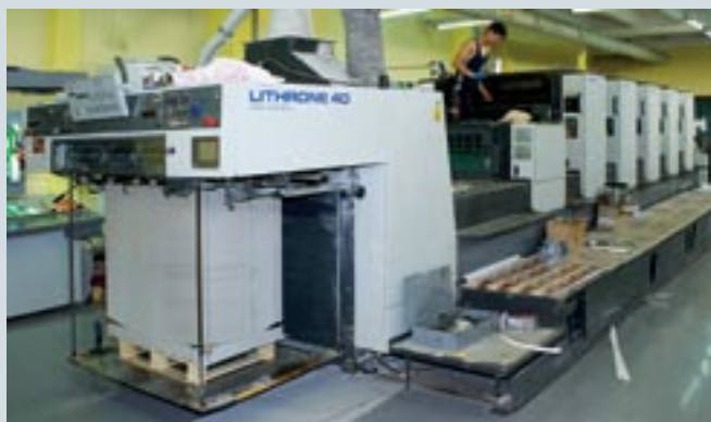
Парк печатного оборудования в ОАО «Упаковка» составляют машины Komori формата 70x100 см разных поколений, в том числе новая шестикрасочная машина с лаковой секцией Lithrone S40 в УФ-исполнении (вверху)
