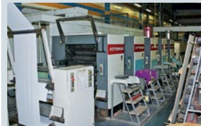
Рулонная машина Octoman используется для цветного «линования» тетрадных листов, а четырехкрасочный Heidelberg Speedmaster 102 — для печати простых обложек
