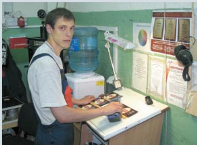
*Регулярный спектрофотометрический контроль отпечатков — основа обеспечения качества готовой продукции*
