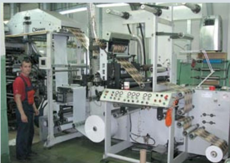
*Печатная машина для типографии «Полипринт» выполнена в специальной комплектации с большим количеством послепечатных узлов*
