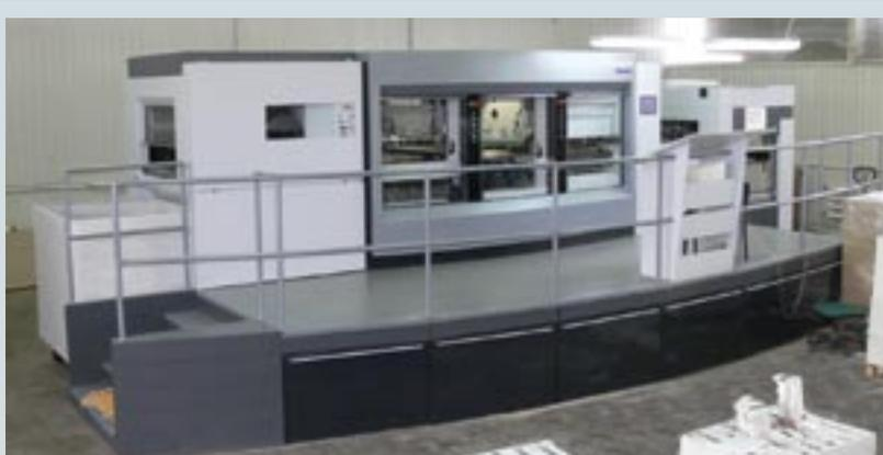
Новинка типографии «ВМС-Принт»: автоматизированный пресс для холодного тиснения и вырубки Heidelberg Dymatrix 106 CSB
