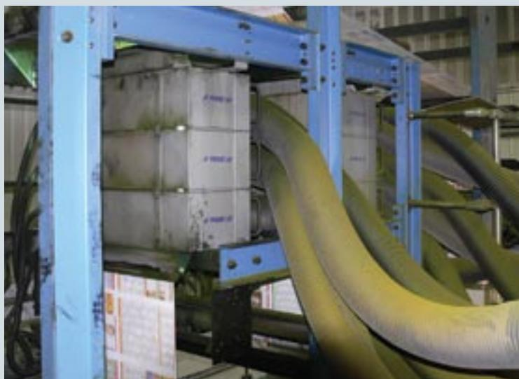
Над одной из печатных секций установлена система УФ-сушильных устройств из 6 ламп (по три с каждой стороны) и системы охлаждения
