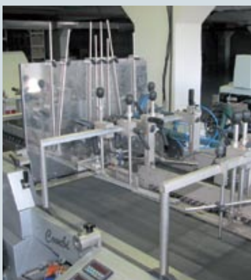
Монтаж быстросъемных дополнительных устройств на линию Fidia. Слева — собственно процесс монтажа, в центре — специальные монтажные штанги, справа — установленный на них аппарат для нанесения двусторонней липкой ленты
