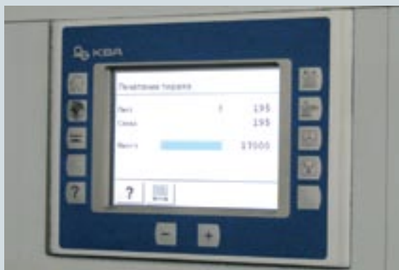
Тиражная продукция печатается почти на максимальной скорости — 17 тыс. отт/ч
