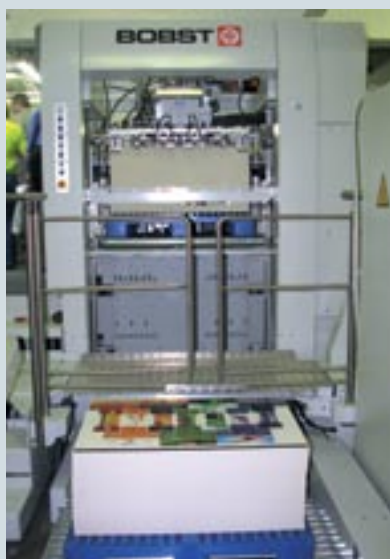
Автоматическая штапельная логистика работает и на Bobst ExpertCut 106 PER: слева — область загрузки, справа — автоматический выклад
