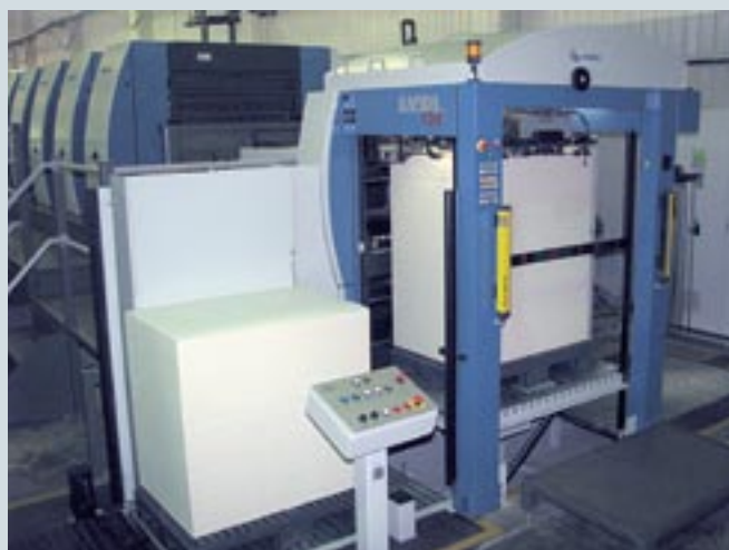
Так выглядит система непрерывной логистики на самонакладде. С одной палеты ведется печать, в то время как другая уже подготовлена для автоматической загрузки. Когда заряженная палета срабатывает до определенного уровня, вторая палета автоматически вдвигается под рабочую, после чего поддон, на котором стоит рабочая стопа бумаги, автоматически изымается
