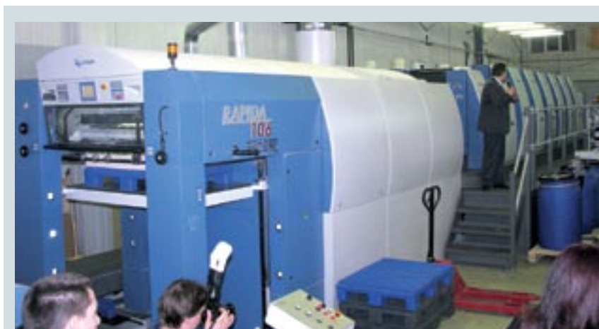
На презентации демонстрировалась печать тестового тиража коробки на новой KBA Rapida 106 с автоматической сменой палет на самонакладе и на приемке
