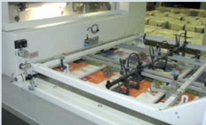
Система Power Register II выравнивает листы перед подачей на вырубку по меткам на изображении
