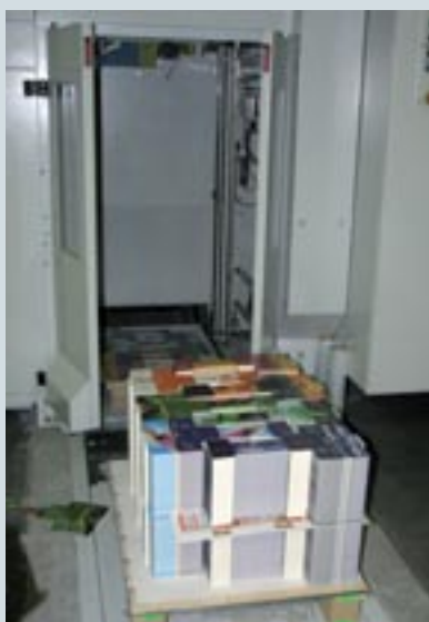
Автоматическая штапельная логистика работает и на Bobst ExpertCut 106 PER: слева — область загрузки, справа — автоматический выклад
