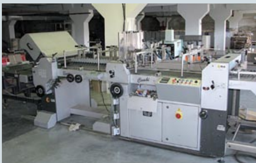
Фальцевально-склеивающая машина Fidia Combi-Unica в типографии «Борус»
