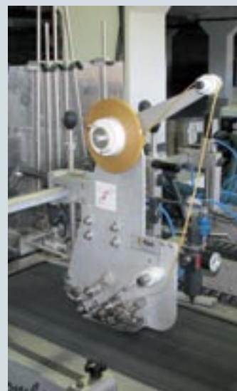
Монтаж быстросъемных дополнительных устройств на линию Fidia. Слева — собственно процесс монтажа, в центре — специальные монтажные штанги, справа — установленный на них аппарат для нанесения двусторонней липкой ленты
