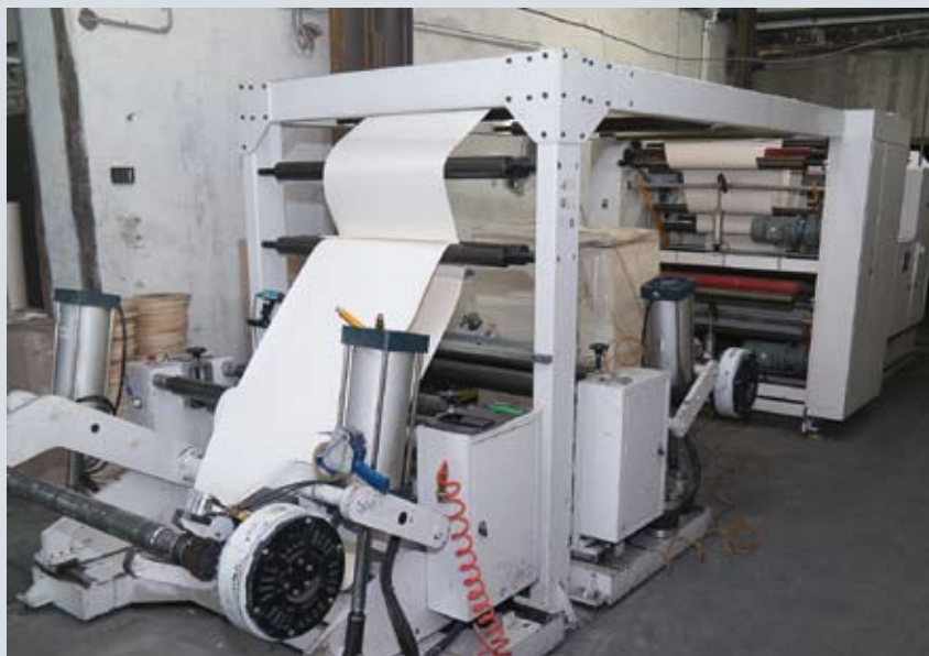
Собственная флаторезная машина позволяет оптимизировать форматы листов картона, которые запечатываются на малоформатных офсетных машинах
