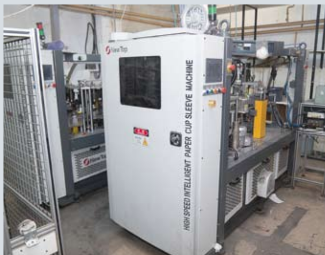
В компании ProstoKap большой парк машин китайской компании Debaо для изготовления бумажных стаканов. Конфигурация станков позволяет выпускать двухслойные стаканы
