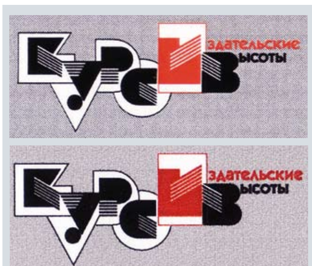
Один и тот же фрагмент, отпечатанный электрографией (вверху) и струйной печатью по мелованной бумаге (внизу)
