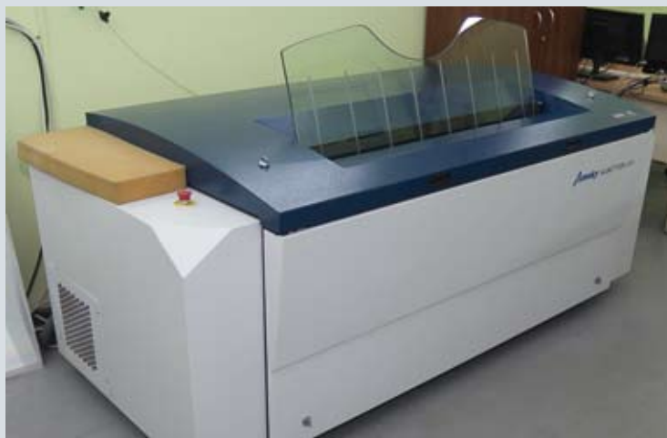
В типографии собственный допечатный участок на базе китайского устройства вывода печатных форм
