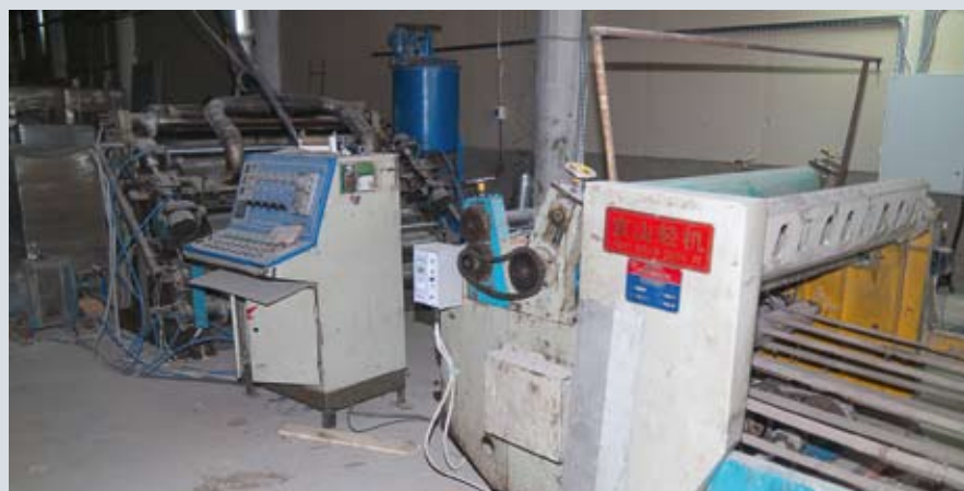
Собственный гофроагрегат в типографии позволяет изготавливать кашированную гофроупаковку
