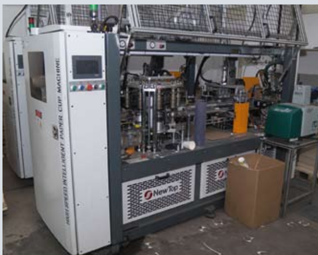
В компании ProstoKap большой парк машин китайской компании Debaо для изготовления бумажных стаканов. Конфигурация станков позволяет выпускать двухслойные стаканы
