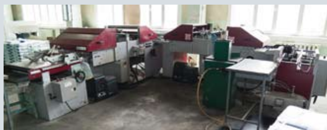
Машина для изготовления интегральных переплетных крышек
