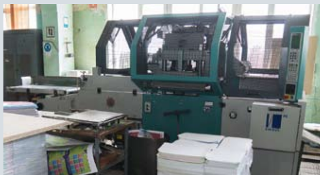
Машина для изготовления интегральных переплетных крышек
