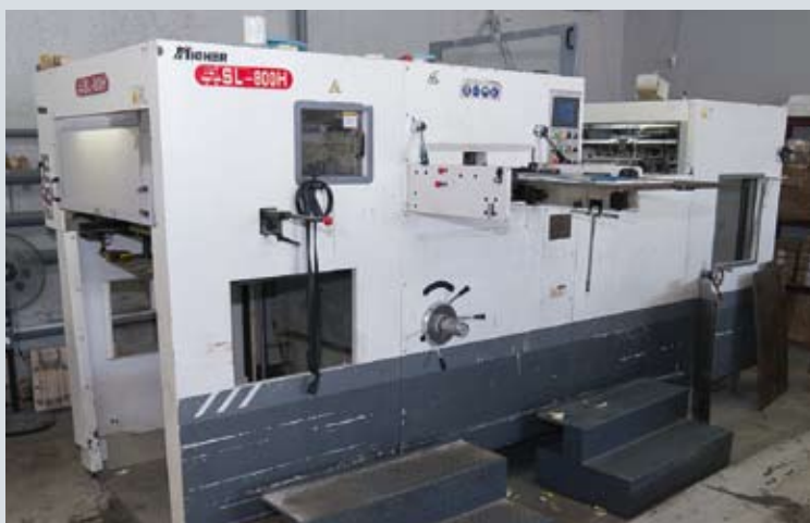
На стопцилиндровой машине типография осуществляет высококачественное тиснение фольгой или конгревное тиснение
