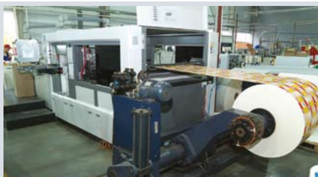
Пресс для высечки с рулонной зарядкой для получения заготовок коробок прямо из запечатанного флексографским способом рулона картона
