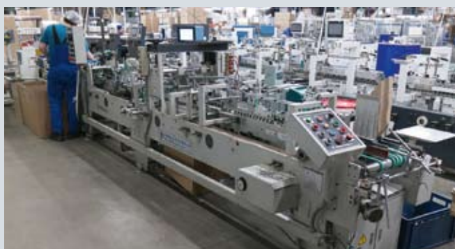
На предприятии большой парк фальцевально-склеивающих машин разных производителей
