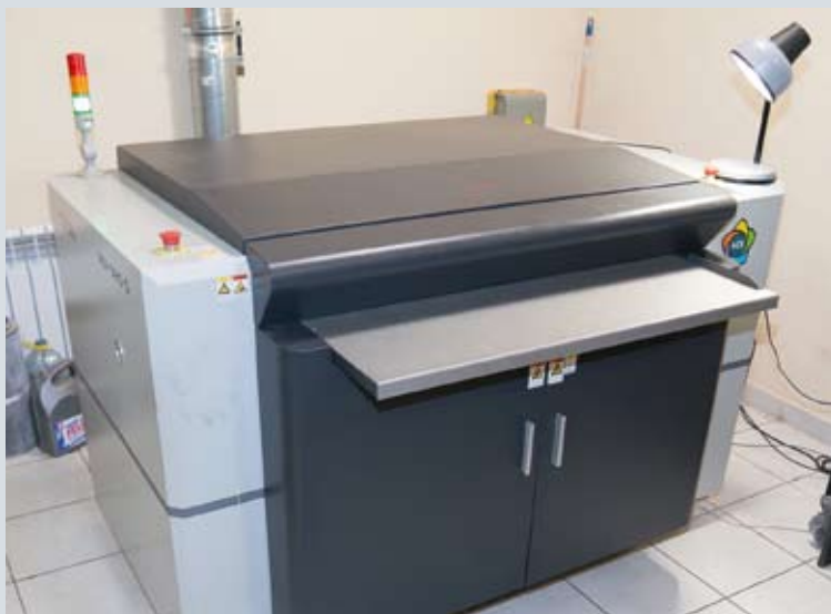
Чтобы иметь возможность самостоятельно изготавливать флексографские формы, типография «Полифлекс» приобрела в компании «Терра Принт» флексографское выводное устройство производства китайской фирмы Sgon
