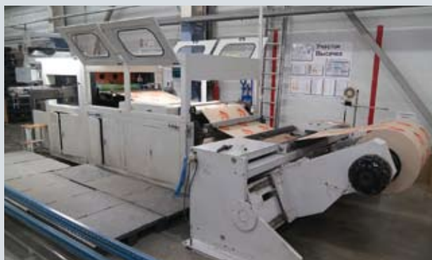
Существенный объем операций по высечке проводится прямо из рулонного материала, минуя резку на листы. Причем материал может быть как чистый, так и с нанесенным заранее изображением
