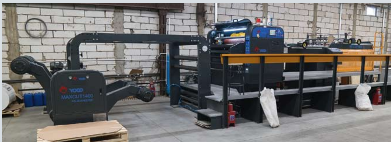
На новой площадке типографии работает цех по подготовке бумаги к печати тиража. Ее нарезают на заданный формат на новой производительной сервоприводной флаторезной машине Yoko MaxCut 1400
