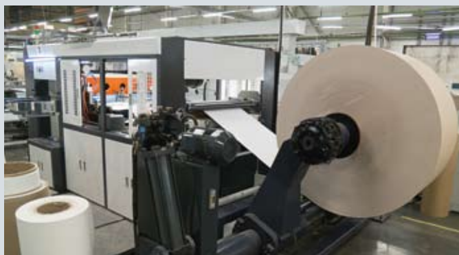
Существенный объем операций по высечке проводится прямо из рулонного материала, минуя резку на листы. Причем материал может быть как чистый, так и с нанесенным заранее изображением
