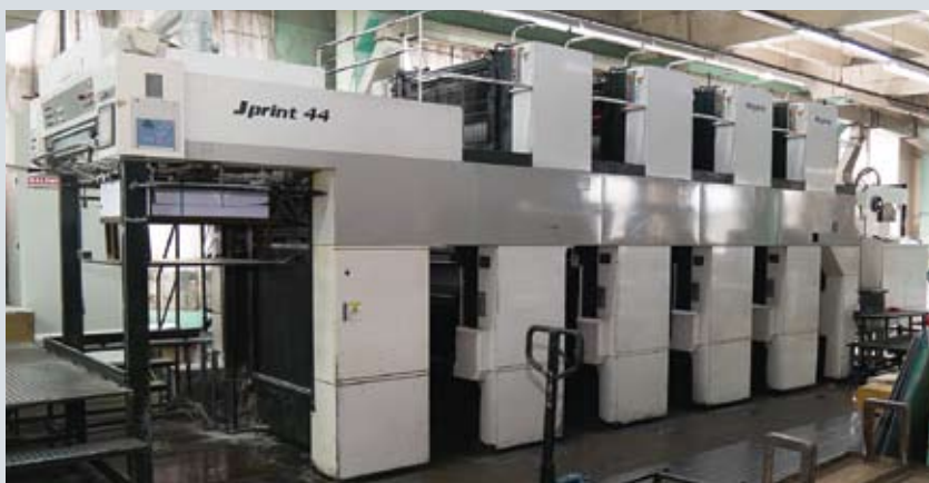
8-красочная машина Akiyama JPrint со сдвоенными вертикально секциями
