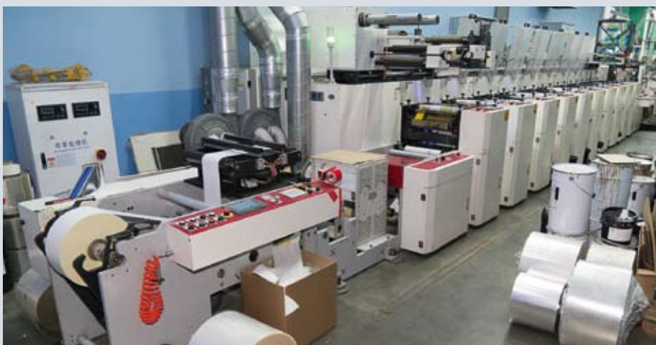
Вверху: общий вид одного из производственных цехов типографии «Полифлекс». Внизу: недавно установленная в типографии новая десятикрасочная узорулонная флексографская печатная машина DongHang
