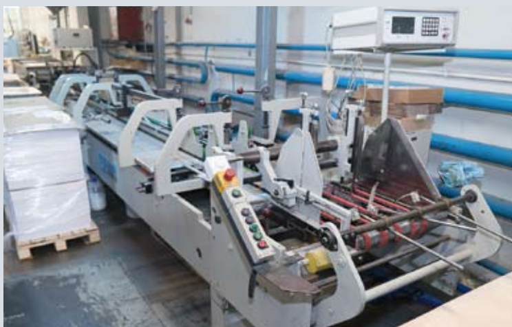
Помимо этикеточного, есть и производство картонной упаковки, для чего установлено соответствующее оборудование
