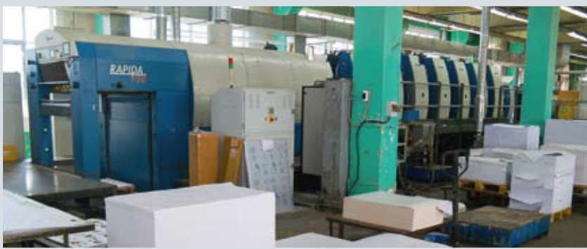
Приобретение этого года - 6-красочная гибридная Rapida 105 с лаковой секцией
