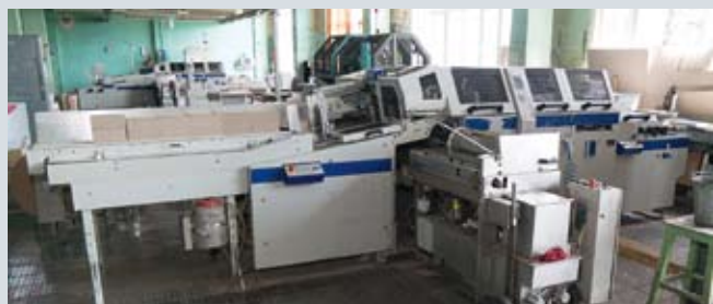
Часть оборудования для изготовления переплетных крышек производства Kolbus
