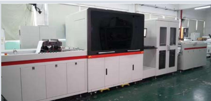
Цифровая струйная печатная машина китайского производства для печати цветных и черно-белых книг, каталогов и журналов
