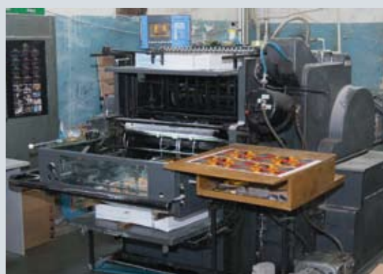
На стопцилиндровой машине типография осуществляет высококачественное тиснение фольгой или конгревное тиснение
