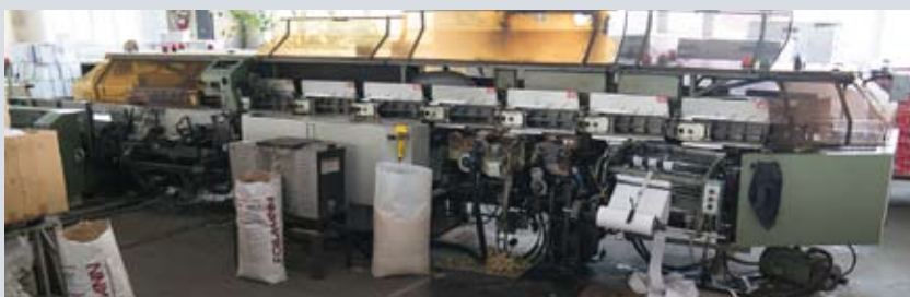
Книги и рабочие тетради в мягкой обложке изготавливают на линиях бесшвейного скрепления
