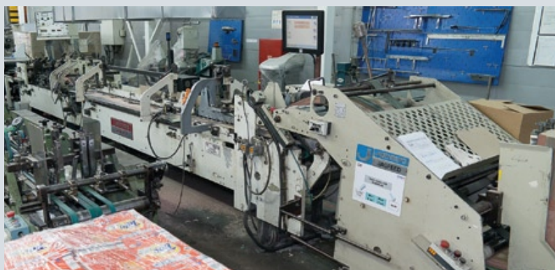
Фальцевально-склеивающие линии для производства картонной упаковки
