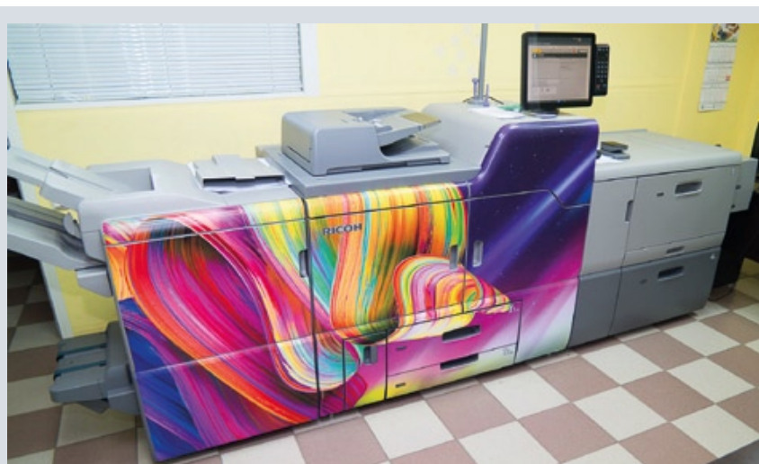
В конце прошлого года в РГ «Максимум» была установлена цифровая печатная машина Ricoh Pro C7200 SX с дополнительной пятой секцией для нанесения белого, прозрачного тонера или же пятого цвета
