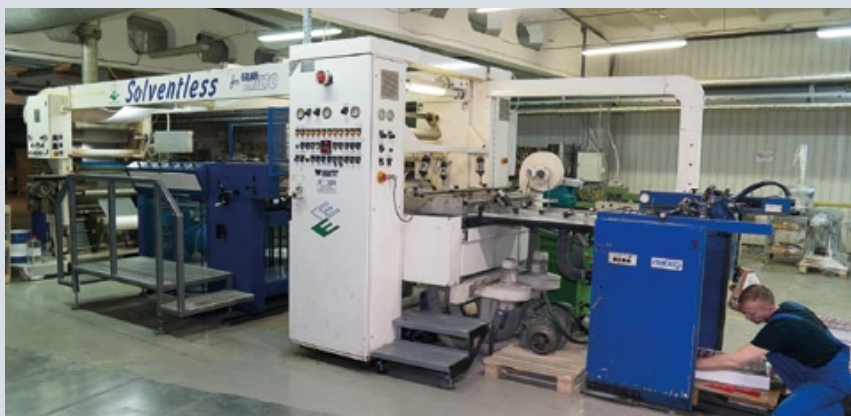
Бессольвентный ламинатор для приклейки пленок на запечатываемый материал
