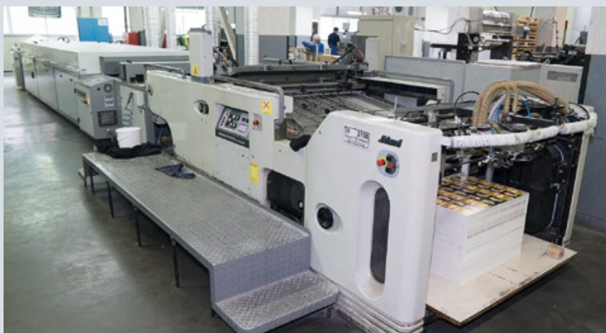
Трафаретная машина с УФ-сушкой используется для печати на непьющих материалах, а также для декоративной отделки картонной упаковки
