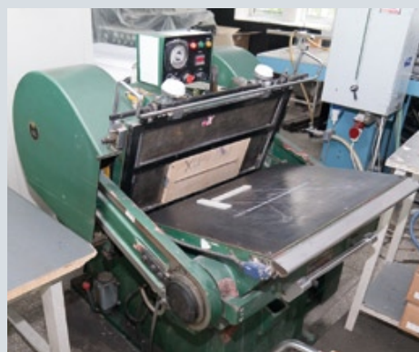
Часть послепечатного комплекса оборудования типографии им. Г. «СКОРИНА»: ламинатор, бумагорезательная машина, тигельный пресс для вырубki заготовок
