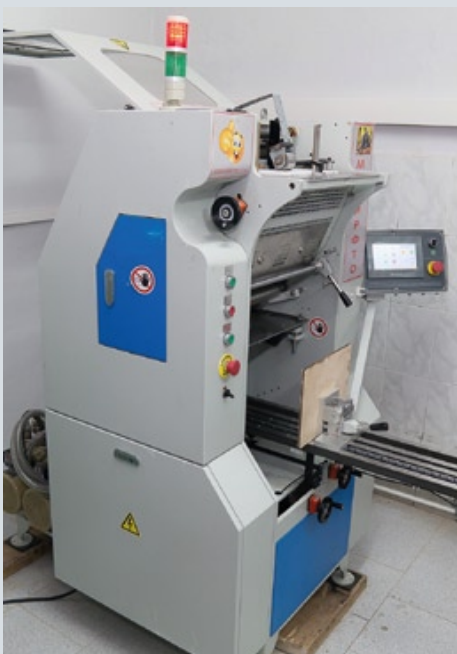
Планшетный режущий плоттер для резки паспарту, картона, пластика, пенокартона. Незаменим для багетной мастерской «АрмавирФото»
