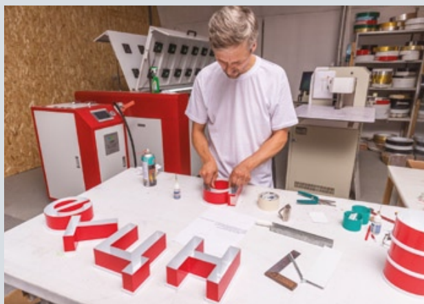
Одним из направлений работы Timer является производство световых вывесок по технологии жидкого литья акрилом
