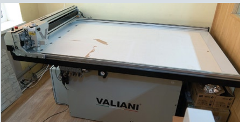
Планшетный режущий плоттер для резки паспарту, картона, пластика, пенокартона. Незаменим для багетной мастерской «АрмавирФото»
