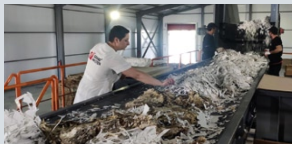
Бумажные отходы от всех видов оборудования по воздушным трубопроводам подаются на линию сортировки. Внедрение системы автоматического удаления отходов позволило добиться чистоты и порядка во всех цехах и обеспечить высокую культуру производства
