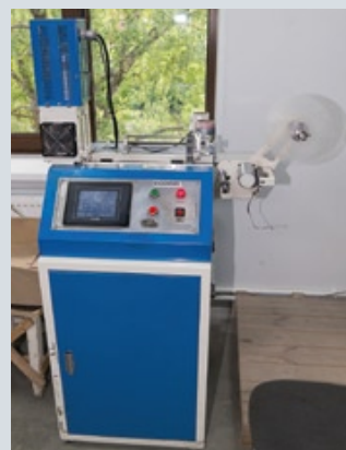
Еще один способ печати вшивной этикетки — метод глубокой печати. Справа: резальная машина с ультразвуковым нагревом ножа для запайки концов тканевой ленты с запечатанными этикетками
