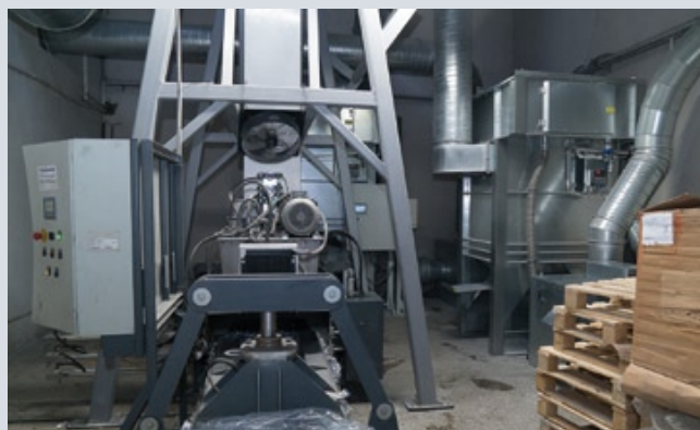
Типография Grand Master серьезное внимание уделяет утилизации отходов. Все оборудование подключено к системам аспирации компании Hunkeler Systeme
