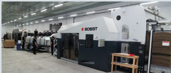
В Grand Master введена в эксплуатацию автоматизированная линия по производству гофроящиков Bobst FFG 8.20 Expertline. Она осуществляет прямую флексопечать по гофрокартону, оснащена секциями прорубки пазов и ротационной высечки, фальцевально-склеивающей линией, модулем обвязки пачек и палетайзером
