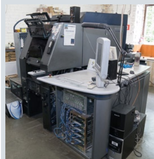
Технология «сухого офсета» на Heidelberg Quickmaster используется для печати вшивных этикеток на синтетических бумагах. Сейчас заметный объем заказов будет переходить с офсета на цифровую печать
