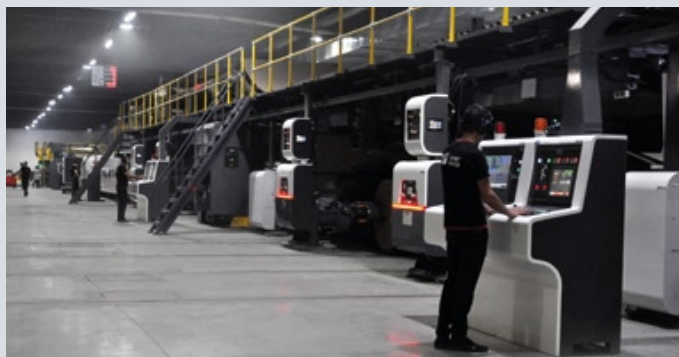
Высокоавтоматизированная линия для производства гофрокартона
