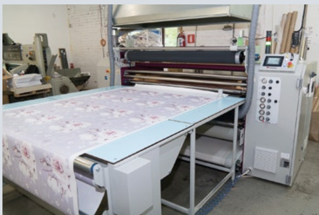
«Первая цифровая типография» — одна из немногих в Иваново, которая предлагает цифровую печать на синтетических тканях. На производстве используется метод сублимационной печати
