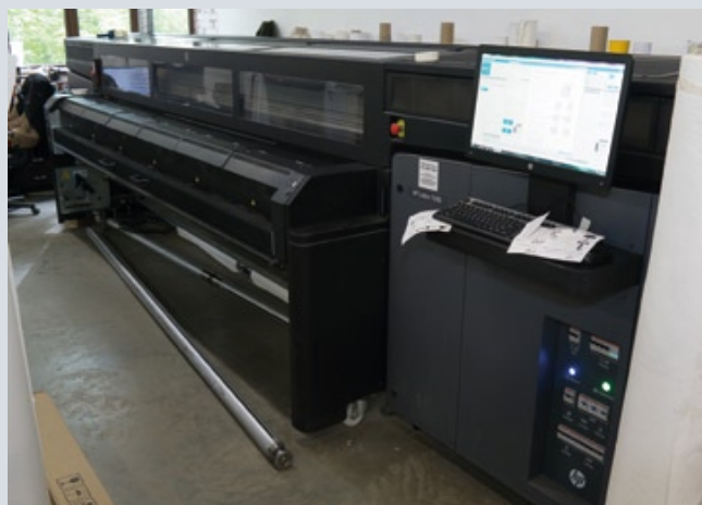
На латексном принтере в типографии запечатывают натуральные ткани. Цифровой способ печати обеспечивает вариативность дизайнов при небольших партиях
