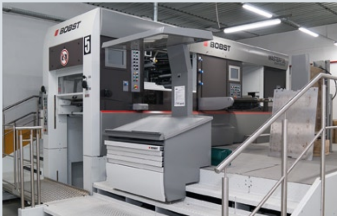
Парк послепечатного оборудования Grand Master представлен десятком единиц оборудования компании Bobst: вырубными прессами серии Expertcut и прессами для горячего тиснения фольгой Masterfoil
