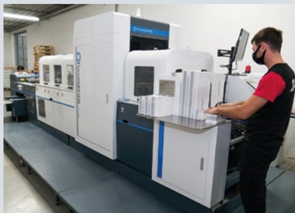
Оборудование для инспекции разверток коробок с целью выявления бракованной продукции
