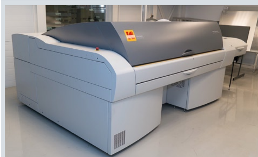
Для вывода печатных форм используются беспроцессные пластины последнего поколения Kodak Sonora Xtra-2
