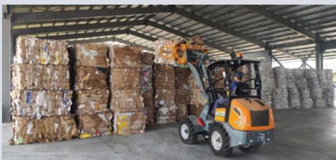
Из макулатурных отходов формируются прессованные тюки, причем отдельно для бурого и белого картона. Так их проще перерабатывать. В скором времени на предприятии планируют запустить производство макулатурного картона из собственного сырья, который, в свою очередь, можно использовать для изготовления упаковки
