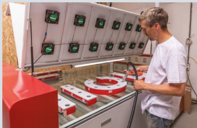
Одним из направлений работы Timer является производство световых вывесок по технологии жидкого литья акрилом
