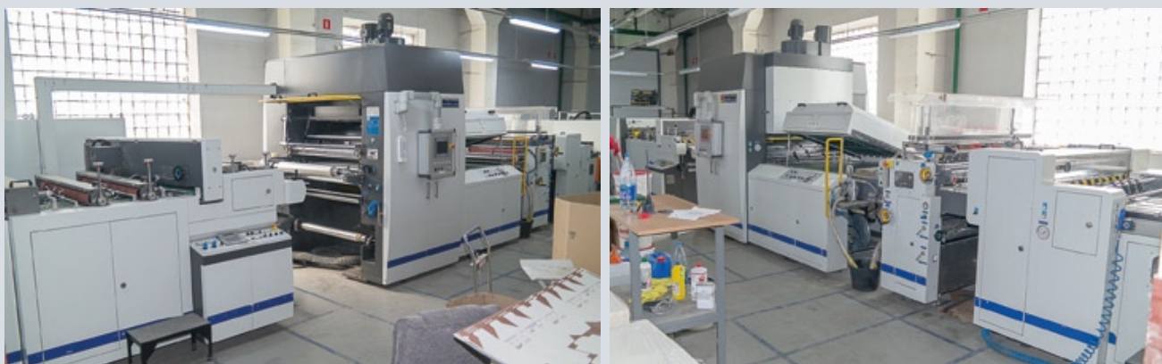
Промышленный ламинатор предназначен для холодной и горячей ламинации, а также для ламинации предварительно вырубленных в картонных коробках окон с нанесением холодного клея на лист. Ламинирование позволяет обеспечить пищевым контейнерам жиро/масло/влагостойкость
