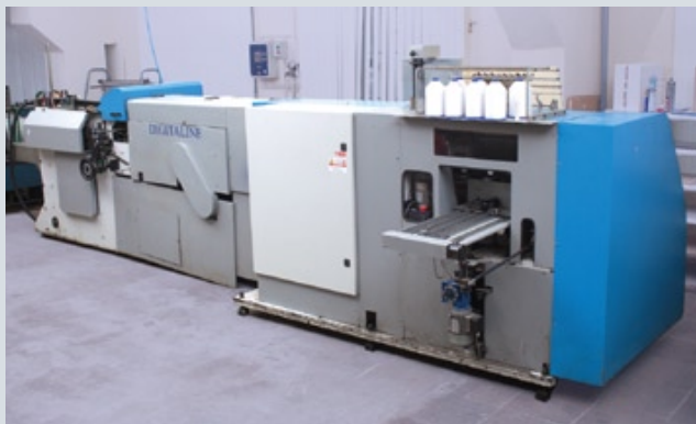
Ниткошвейное оборудование для цифровой и офсетной печати книг, сочетающее фальцовку и шитье блока нитками
