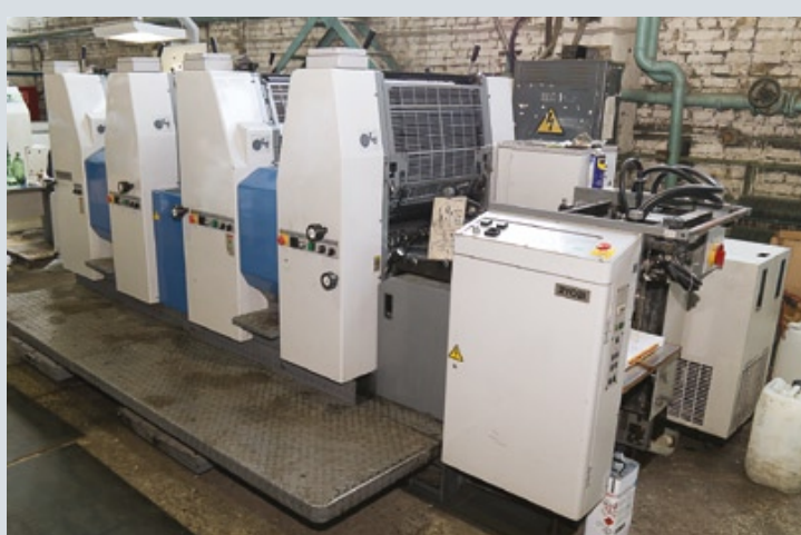
Типография ART Poligrafy имеет разнообразный парк печатного оборудования. Офсетный цех базируется на четырехкрасочной печатной машине Ryobi 524 и двухкрасочной Ryobi 662P
