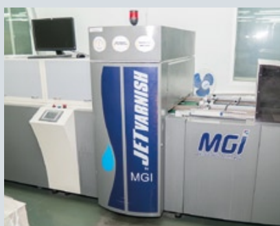
Сплошное или выборочное лакирование выполняется на MGI JetVarnish
