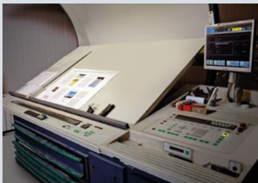
На листовых офсетных машинах — четырехкрасочной Roland 204E и пятикрасочной Roland 905 с секцией ВД-лакирования — в АО «Красная Звезда» печатают высококачественные журналы и коммерческие листовые заказы
