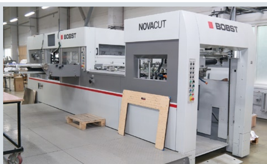
В целях развития упаковочного направления в типографии «Лайт» приобрели новый вырубной пресс NovaCut 106 E 3.0 Autoplaten от компании BOBST. Он имеет высокий уровень автоматизации и оснащен функцией удаления облоя
