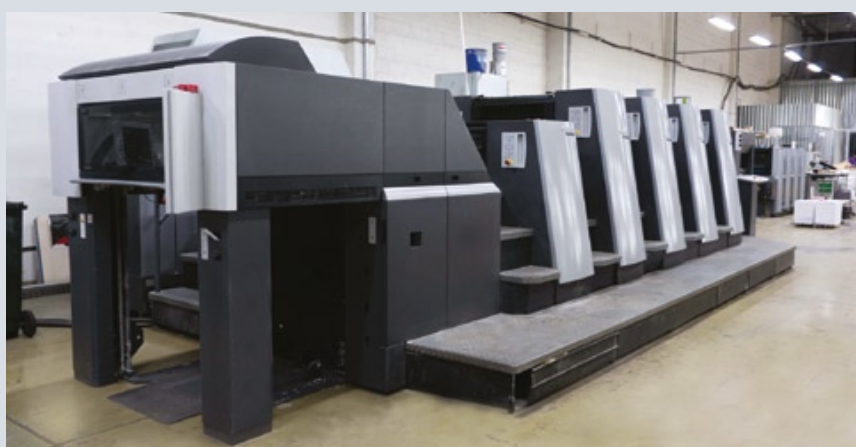
Парк офсетного оборудования типографии «Лайт» представлен печатными машинами компании Heidelberg — Speedmaster 52-4 и Speedmaster XL 75-4+L (на фото)
