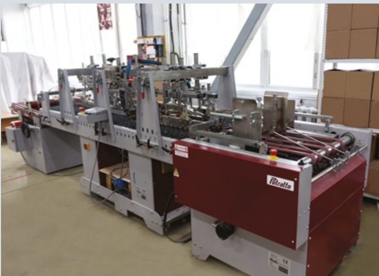
Послепечатный цех оборудования типографии «Лайт» комплектован с учетом производства как рекламно-коммерческой продукции, так и картонной упаковки и этикетки (на фото: листоподборочно-брошюровальный комплекс, машина для клеевого бесшвейного скрепления, фальцевально-склеивающая линия)
