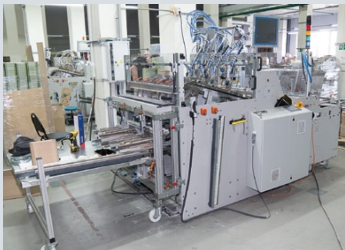
Линии европейского производства (на предприятии их три) для объемной склейки лотков, салатников, коробок под бургеры и т. д.
