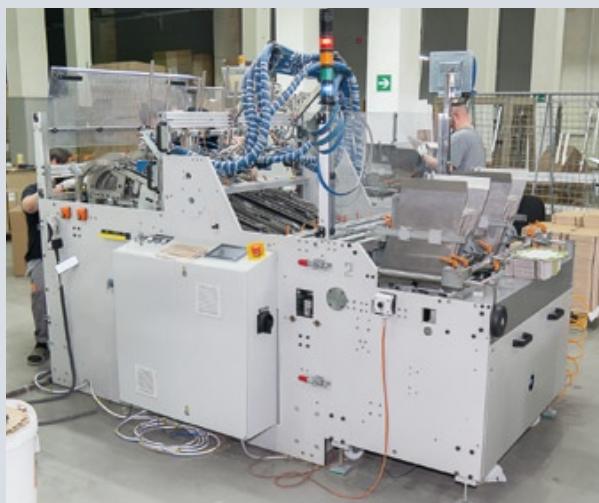
Линии европейского производства (на предприятии их три) для объемной склейки лотков, салатников, коробок под бургеры и т. д.
