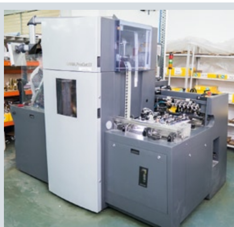
Kata ProCut 53 F предназначен для плоского тиснения фольгой и без фольги, с микро-рельефом, а также конгревного тиснения, надсечки и высечки
