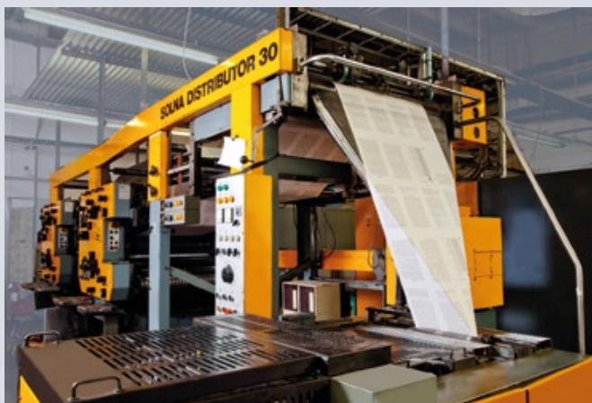
На рулонных офсетных машинах выполняется печать книжно-журнальных изданий в одну или две краски
