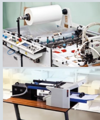
Послепечатный набор оборудования цеха оперативной полиграфии АО «Красная Звезда» позволяет выполнять заказы разной сложности (на фото: линия для производства календарной продукции, пресс для тиснения, ламинатор, биговщик)
