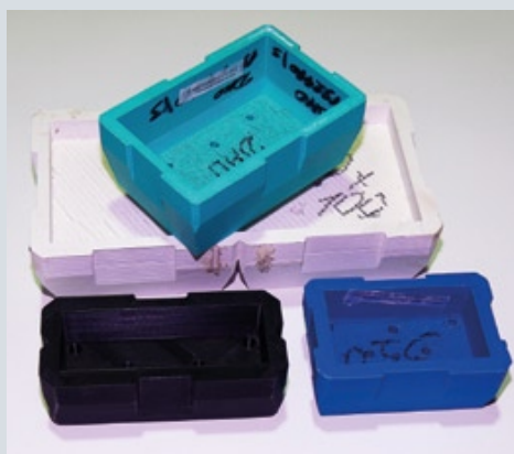
Формы для объемных контейнеров выполняются на 3D-принтере
