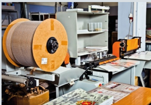
Послепечатный набор оборудования цеха оперативной полиграфии АО «Красная Звезда» позволяет выполнять заказы разной сложности (на фото: линия для производства календарной продукции, пресс для тиснения, ламинатор, биговщик)
