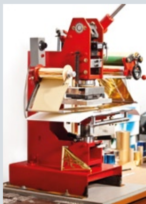
Послепечатный набор оборудования цеха оперативной полиграфии АО «Красная Звезда» позволяет выполнять заказы разной сложности (на фото: линия для производства календарной продукции, пресс для тиснения, ламинатор, биговщик)
