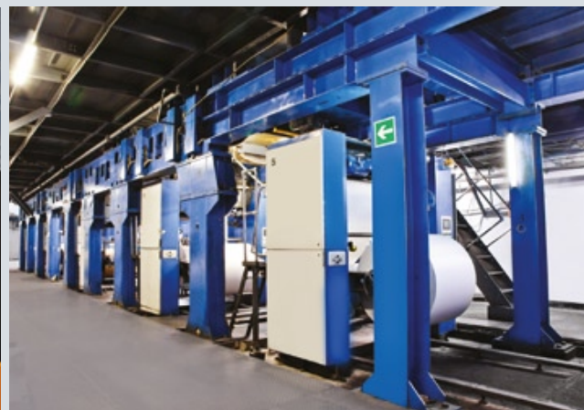
Пятибашенный ПОГ2-84Б-5102 позволяет изготавливать газеты любых форматов, красочности и полосности
