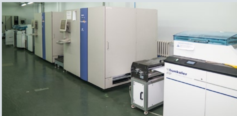
Цифровые печатные мощности типографии представлены струйной рулонной машиной Screen TruepressJet 520EX и листовыми машинами от компании Xerox (на фото iGen4 EXP 110)
