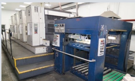
Линия для печати по металлу, оснащенная печатными секциями от Roland 900 и конвекционной сушкой
