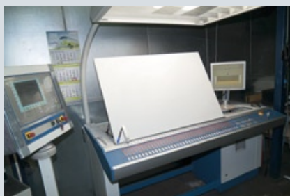
Двухкрасочная печатная машина по металлу с пультом управления красочным аппаратом
