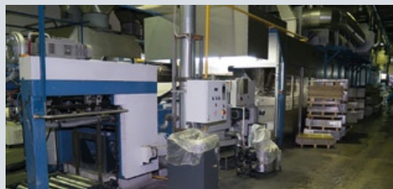
Конвекционная полистная сушка длиной 33 м, где осуществляется закрепление красочного слоя на металле
