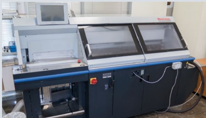
Клеевая машина Horizon Perfect Binder BQ-280PUR. Автоматизированная линия позволяет делать высококачественную продукцию с прочным, легко раскрываемым переплетом
