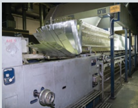
Закрепление лакового слоя происходит в специальных сушильных камерах
