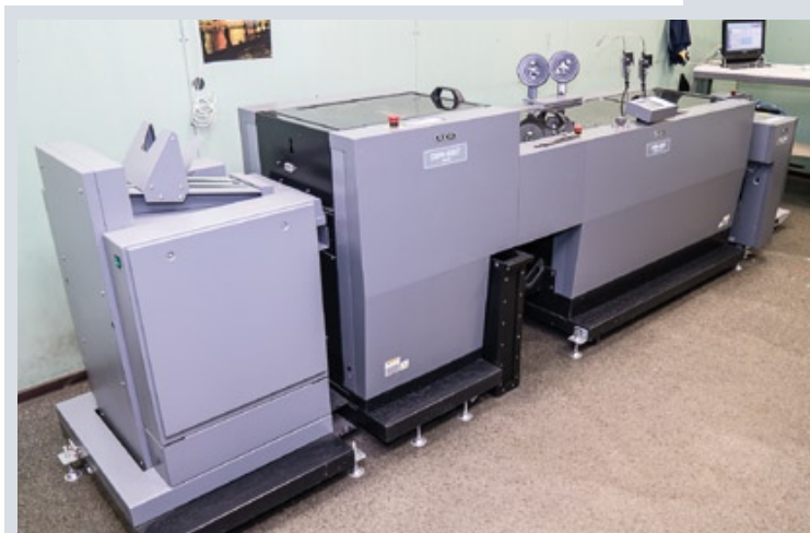
Типография «Эй Пи Трэйд» за последний год инвестировала в послепечатное оборудование. На фото: линия для изготовления брошюр на скоте
