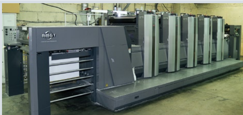
Основную часть заказов в типографии «Пи Квадрат» выполняют на пятикрасочной офсетной машине RMGT 920ST-5. Формат машины наилучшим образом подходит для печати продукции, на которой специализируется предприятие, — рекламной полиграфии и курьерских конвертов
