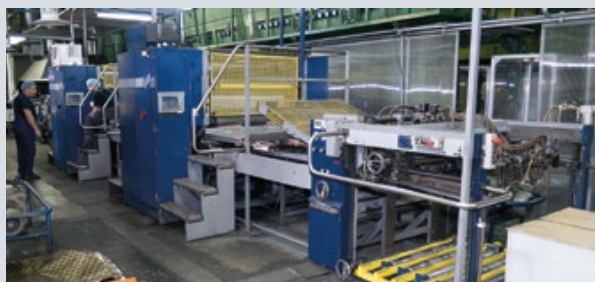
Двухкрасочная печатная машина по металлу с пультом управления красочным аппаратом
