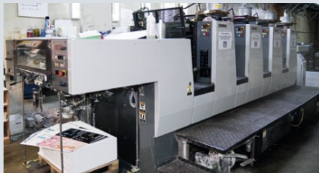
Печатный парк типографии оснащен также четырехкрасочными офсетными машинами немецких и японских производителей
