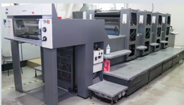
Печатный парк «Тверской фабрики печати» представлен оборудованием компании Heidelberg: однокрасочной Speedmaster SM 74-1, четырехкрасочной Speedmaster SM 74-4H и пятикрасочной с секцией лакирования Speedmaster XL 75-5+L
