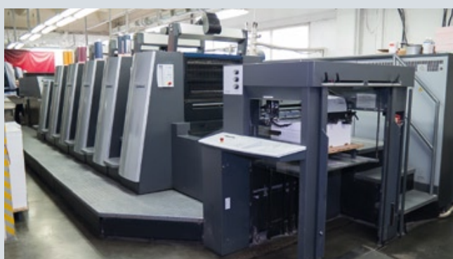
Печатный парк «Тверской фабрики печати» представлен оборудованием компании Heidelberg: однокрасочной Speedmaster SM 74-1, четырехкрасочной Speedmaster SM 74-4H и пятикрасочной с секцией лакирования Speedmaster XL 75-5+L
