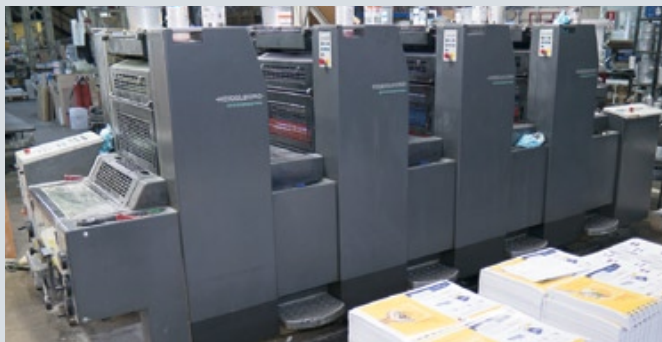
Печатный парк типографии оснащен также четырехкрасочными офсетными машинами немецких и японских производителей
