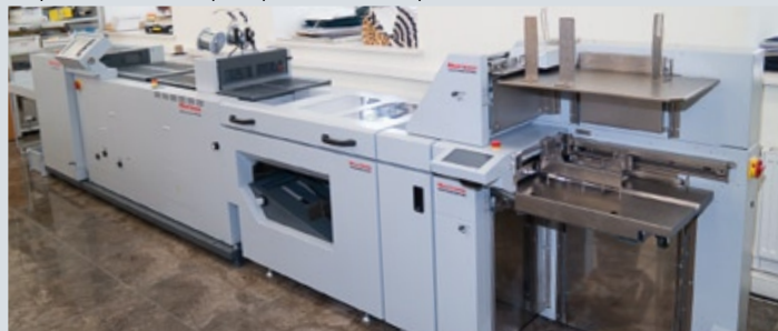
Линия для шитья брошюр проволокой от компании Horizon с модулем подачи цифровых блоков
