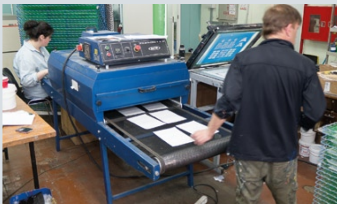
Сушильное устройство для отпечатков, сделанных на трафаретной линии
