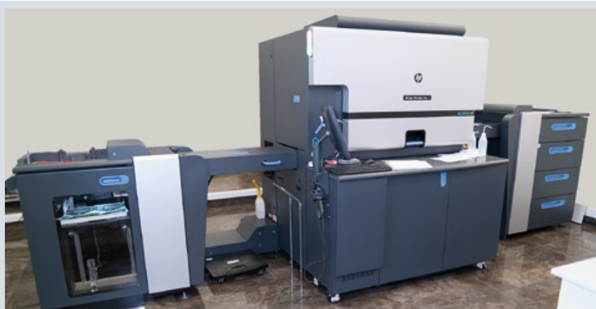
Основой печатного парка типографии является семикрасочная цифровая печатная машина HP Indigo 7900 (слева) в полной комплектации
