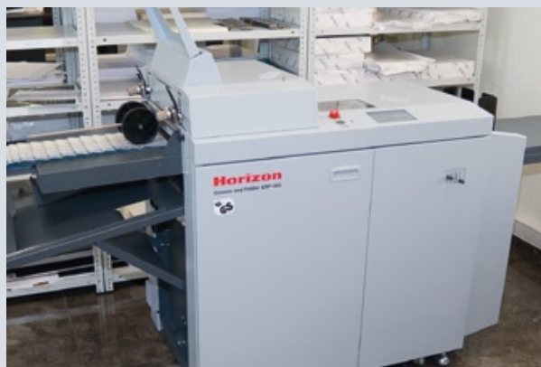
Устройство для биговки и фальцовки Horizon Crease and Folder CRF-362 может работать как с тонкими бумагами, так и с плотными материалами
