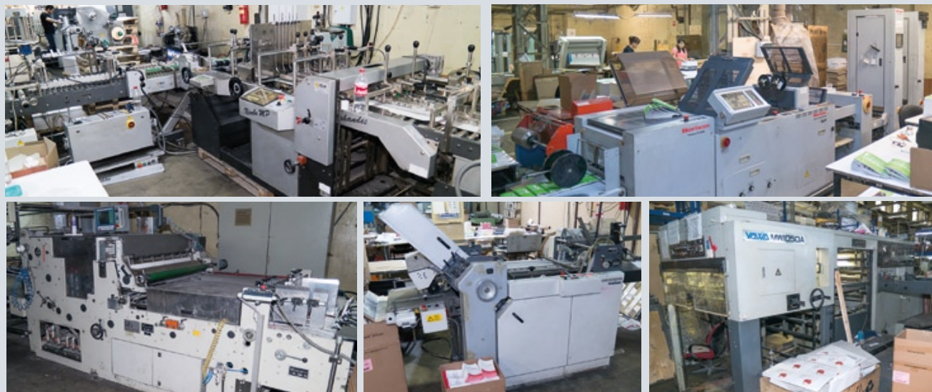
Фальцевально-склеивающая линия Fidia по сборке курьерских конвертов, устройство для вклейки пластиковых окошек, подборочно-швейно-резальное оборудование и многое другое
