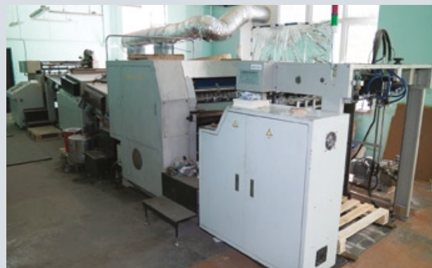
Для придания отпечатанным оттискам декоративности используется ламинатор (слева) для припрессовки пленки, которая к тому же придает продукции прочность на истирание и водоотталкивающие свойства, а также лакировальная машина для нанесения сплошного и выборочного УФ- или ВД-лаков
