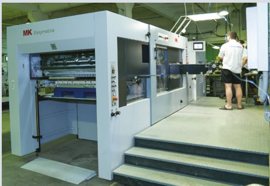
Типография «АПД» в целях усиления своего упаковочного направления приобрела новый вырубной пресс МК Easymatrix, установленный специалистами «Гейдельберг-СНГ». Помимо секции вырубки, данная модель оснащена также секцией удаления облоя, что повышает уровень автоматизации, снижает трудозатраты и увеличивает качество вырубленных заготовок
