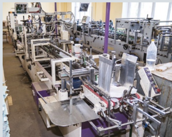
В связи с увеличением объема заказов на упаковку на «Московском комбинате игрушек» была инсталлирована вторая фальцевально-склеивающая линия
