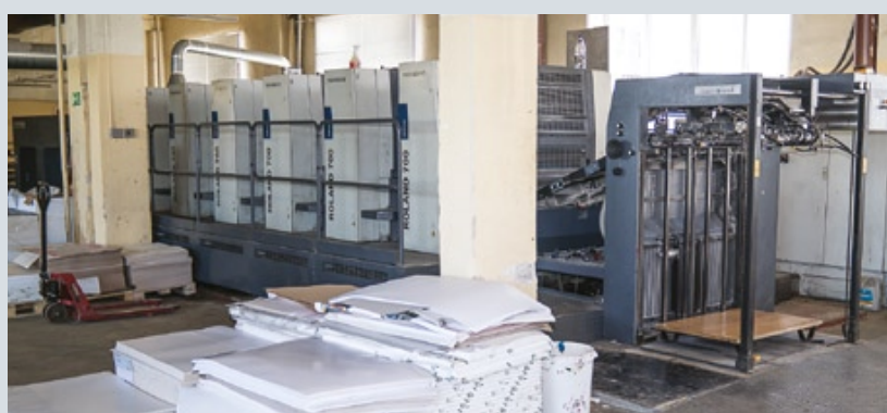
На «Московском комбинате игрушек» работает пятикрасочная офсетная машина manroland 705 LV с секцией для нанесения ВД-лака. Машина позволяет запечатывать расширенный диапазон материалов — как бумаги, так и картона
