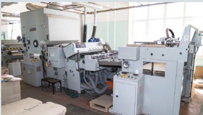
Для придания отпечатанным оттискам декоративности используется ламинатор (слева) для припрессовки пленки, которая к тому же придает продукции прочность на истирание и водоотталкивающие свойства, а также лакировальная машина для нанесения сплошного и выборочного УФ- или ВД-лаков
