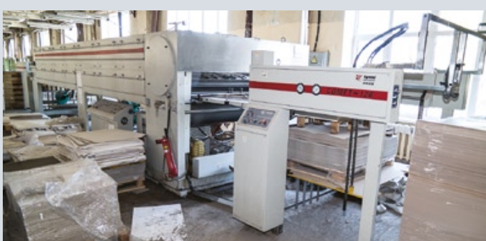
При изготовлении продукции для детей запрещается использование вредных материалов, в частности УФ-лаков. В качестве альтернативной технологии здесь применяют каландрирование залакированных ВД-лаком оттисков
