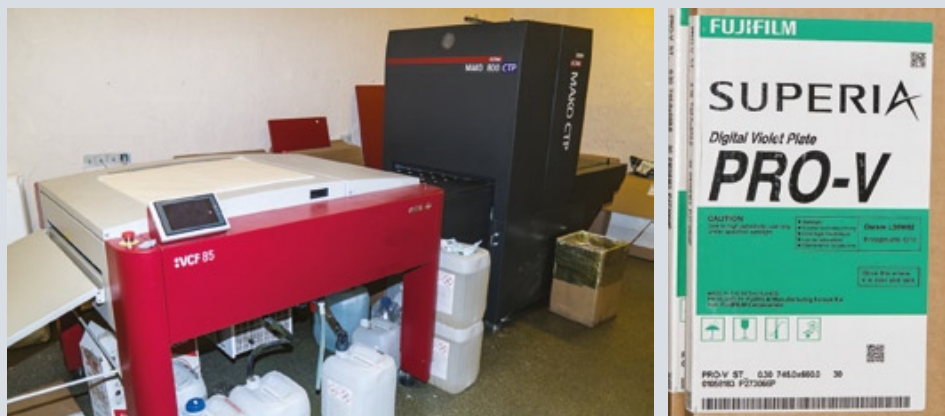
В результате обновления допечатного участка в типографии установили CtP-комплекс на базе ECRM Mako 800. Для вывода форм используются фиолетовые пластины Fujifilm от компании «ЯМ Интернешнл»
