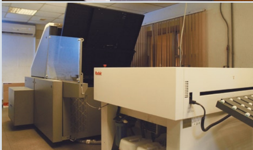
Недавно в типографии «Прайм Принт Екатеринбург» был установлен новый CtP-комплекс Kodak Trendsetter News SCU. Он специально разработан для газетных типографий и обладает высоким уровнем автоматизации
