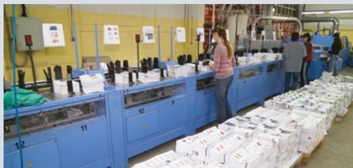
Недавно в типографии приобрели линию для клеевого бесшвейного скрепления Pantera от Muller Martini, которая позволяет качественно выполнять скрепление печатного блока рекламной многополосной продукции
