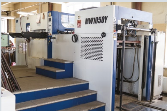
Производство игровых комплектов и упаковки требует большого количества вырубных операций. Штанцевальная машина позволяет выполнять вырубку, биговку, перфорацию и конгревное тиснение
