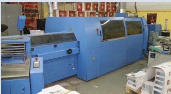
Недавно в типографии приобрели линию для клеевого бесшвейного скрепления Pantera от Muller Martini, которая позволяет качественно выполнять скрепление печатного блока рекламной многополосной продукции
