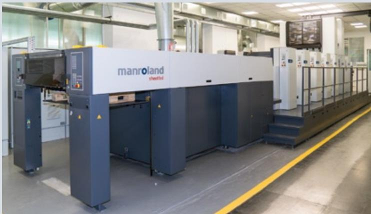
Новая печатная машина типографии «Картон-Полиграф» — Roland 706 HiPrint последнего поколения с секцией лакирования, модулем холодного тиснения фольгой (InlineFoiler), новым эргономичным пультом управления и полным набором автоматики
