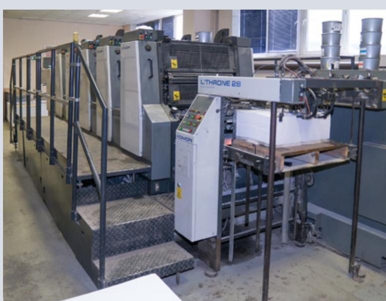
Со всем объемом заказов типографии «А2» сейчас справляется одна печатная машина Komori Lithrone 28
