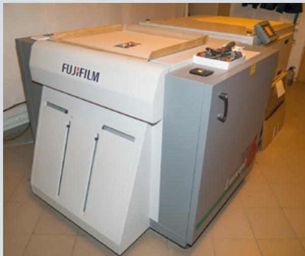
Покупка собственного выводного устройства для экспонирования пластин Fujifilm Luxel V6 позволила не только обеспечить формами собственное производство, но и выводить формы на сторону
