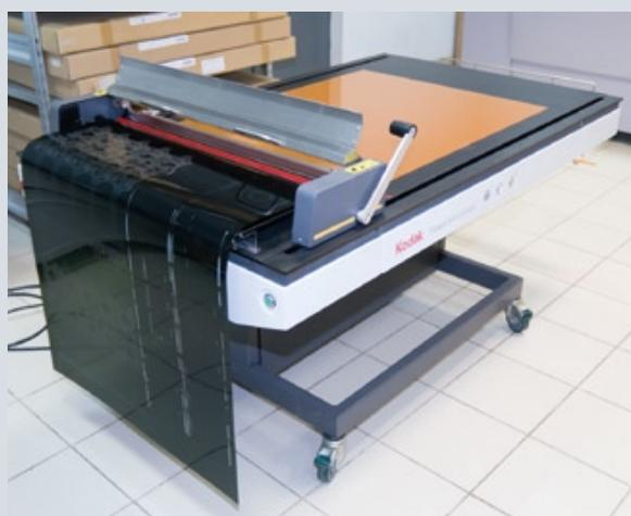
Комплект оборудования Kodak Flexcel NX (цифровое экспонирующее устройство и ламинатор) используется на предприятии для изготовления печатных форм самого высокого качества
