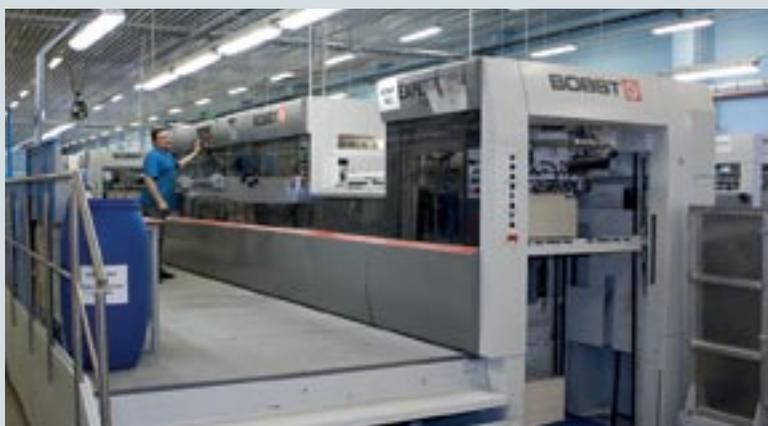
В типографии «ПЕЧАТНЯ» установлены вырубные прессы BOBST разных поколений. Сначала это были прессы серии SPERIA, позднее к ним добавились новейшие EXPERTCUT с системой позиционирования по изображению PowerRegister, разделением заготовок и удалением облоя
