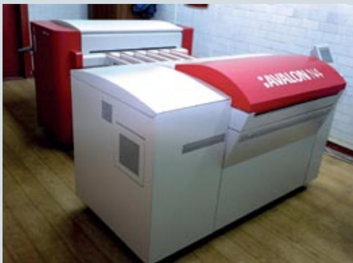
Система вывода печатных форм Agfa Avalon N4 с промывочной секцией для химически чистых печатных форм Azuga
