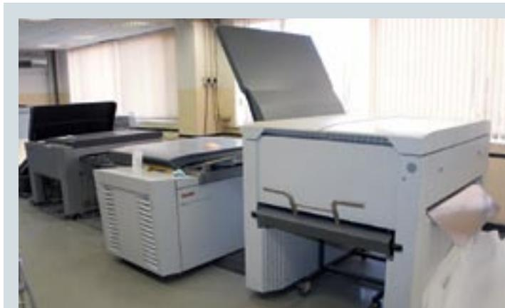
В допечатном цехе работает CtP-система Kodak Magnus 800 Quantum с автоматической загрузкой пластин разного формата и системой управления рабочими потоками Kodak Prinergy
