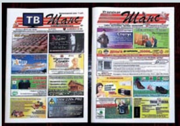
Комбинированная газетная продукция: обложка и часть внутреннего блока печатается на мелованной бумаге на листовой машине, а остальная часть блока — на газетной бумаге на рулонной машине
