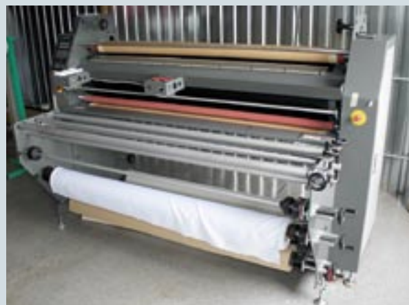
Для сублимационной печати по ткани применяется широкоформатный струйный плоттер Mimaki JV5 160S (слева), на котором изображение сначала печатается на специальной бумаге, а затем в каландере (справа) переносится на рулонную ткань
