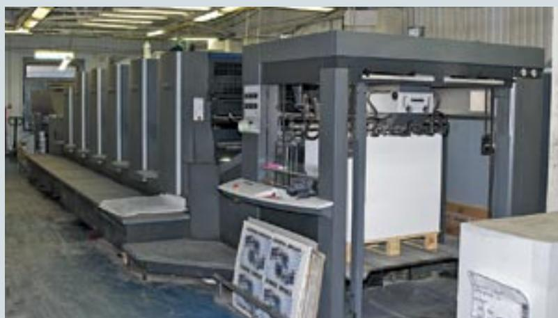
Парк печатного оборудования типографии «Арбат»: шестикрасочная машина с лаковой секцией KBA Rapida 105 для УФ-печати и пятикрасочная машина с лаковой секцией Heidelberg Speedmaster CD 102
