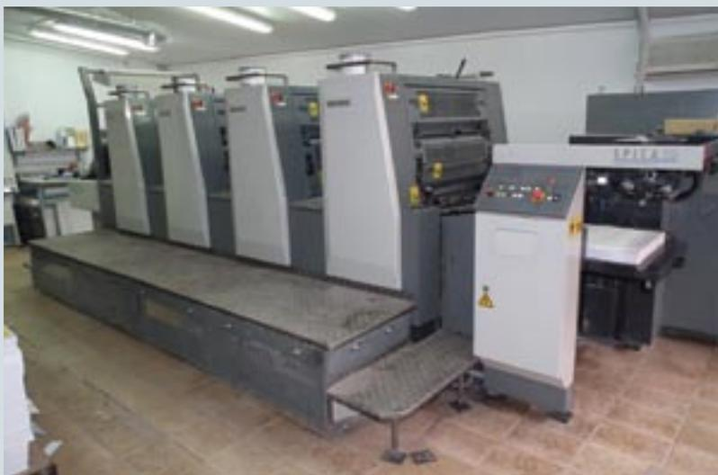
В типографии «КАСП-ПЛЮС» с 2008 г. печатают на четырехкрасочной машине Komori Spica 29
