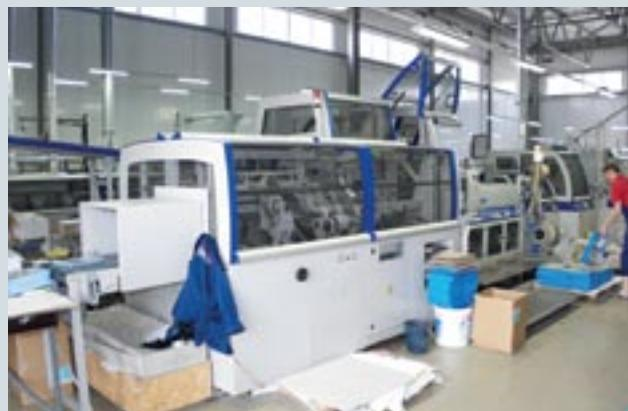
В типографии сформирован самый современный парк послепечатного оборудования: есть и ВШРА (слева), и линия для изготовления книг в твердом переплете (справа)
