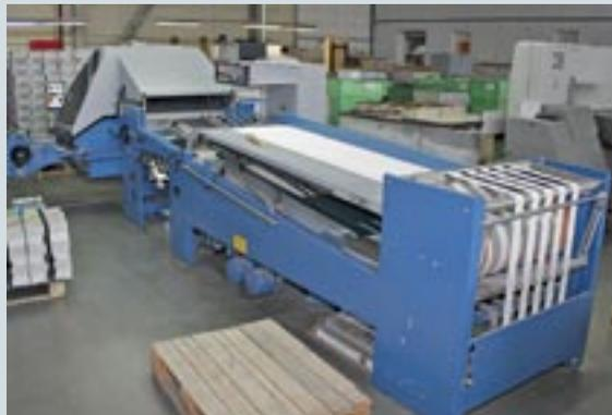
Фальцевально-склеивающая линия Fidia используется для изготовления интегрального переплета, а новая комбинированная фальцовка МВО с круглостapelным самонакладом – для высокопроизводительной фальцовки
