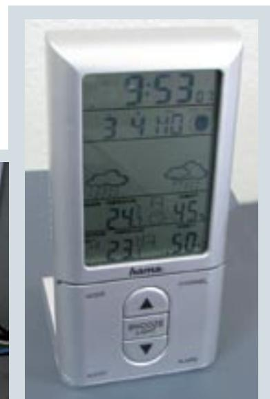
*Для стабильной работы оборудования в типографии создали оптимальные климатические условия. Метеостанция позволяет постоянно контролировать уровень влажности и температуры, а от перепадов напряжения предохраняет автоматический стабилизатор напряжения переменного тока*
