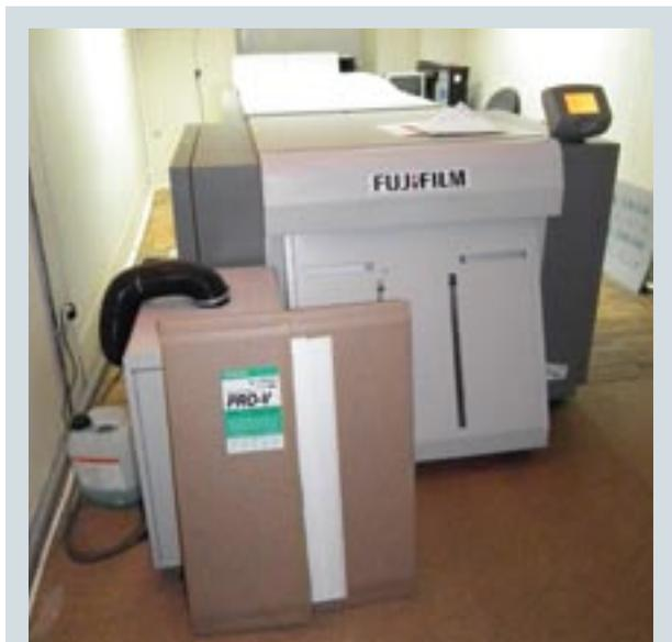
Печатные формы изготавливаются на СтР Fujifilm Cxhel V-6 с использованием малохимических пластин Fujifilm Brillia PRO-V
