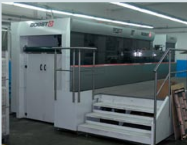
Печать на машине KBA, вырубка на современном прессе Bobst — в последнее время такая комбинация становится практически стандартной для успешного производителя упаковки
