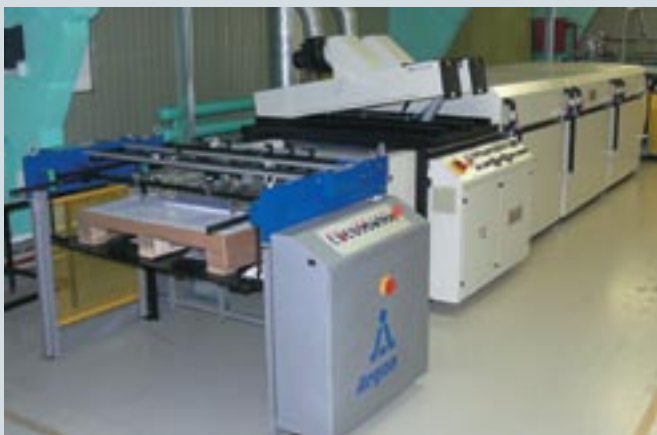
Оборудование трафаретной печати применяется для нанесения кроющих красок, грунтов и лаков. В зависимости от тиража используется либо производительное оборудование (слева), либо более компактное и простое (справа)
