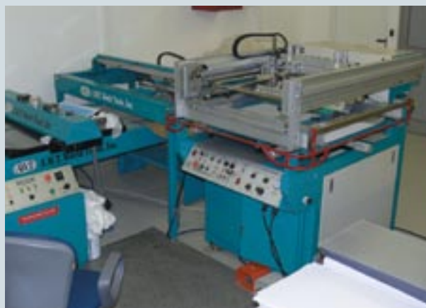
Оборудование трафаретной печати применяется для нанесения кроющих красок, грунтов и лаков. В зависимости от тиража используется либо производительное оборудование (слева), либо более компактное и простое (справа)
