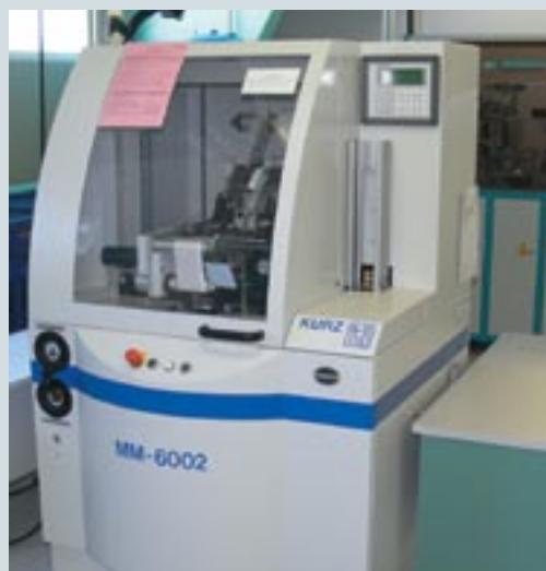
Оборудование для нанесения дополнительных элементов на карточки: голограмм, полос для подписи и т. д.
