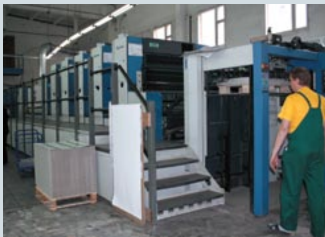
Печать на машине KBA, вырубка на современном прессе Bobst — в последнее время такая комбинация становится практически стандартной для успешного производителя упаковки
