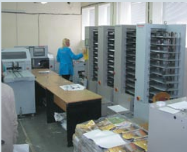
Послепечатный процесс в типографии предполагает полистную технологию подборки, что несколько неудобно при производстве периодики. Поэтому в ближайшей перспективе в «Акварель Принт» планируется замена послепечатного оборудования
