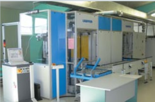
Оборудование для спекания листов пластика (слева) и для вырубки заготовок будущих карт (справа)
