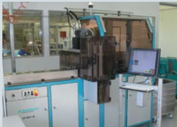
Оборудование для спекания листов пластика (слева) и для вырубки заготовок будущих карт (справа)
