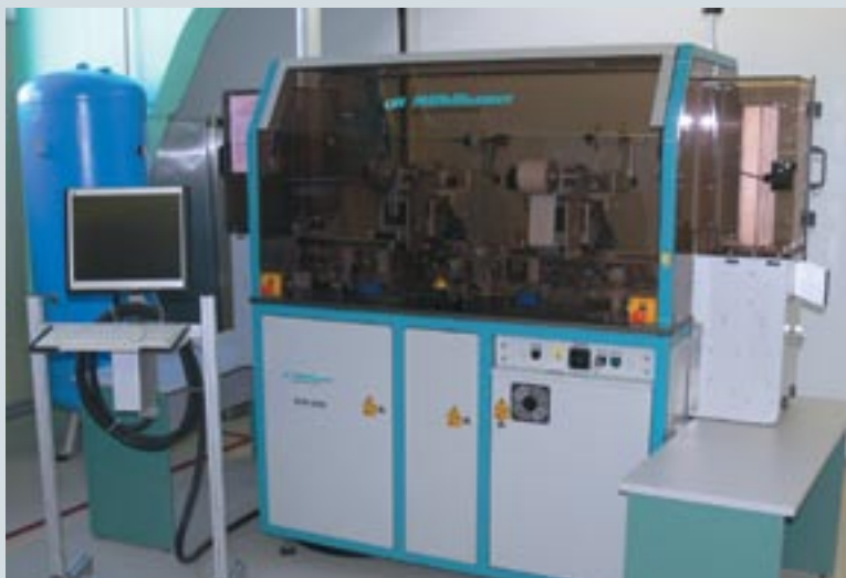
Оборудование для нанесения дополнительных элементов на карточки: голограмм, полос для подписи и т. д.
