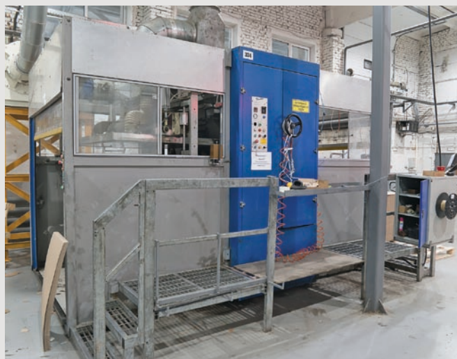
Два валковых пресса применяются для высечки заготовок с использованием плоских штампов
