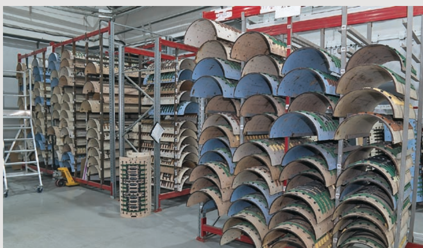
В компании большая коллекция штампов для высечки, позволяющая быстро организовать производство самых разных по конструкции коробок
