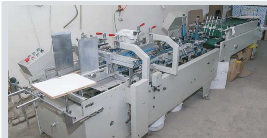
Высечка и тиснение на тигельном прессе и своя фальцовка-склейка позволяют производить картонную упаковку
