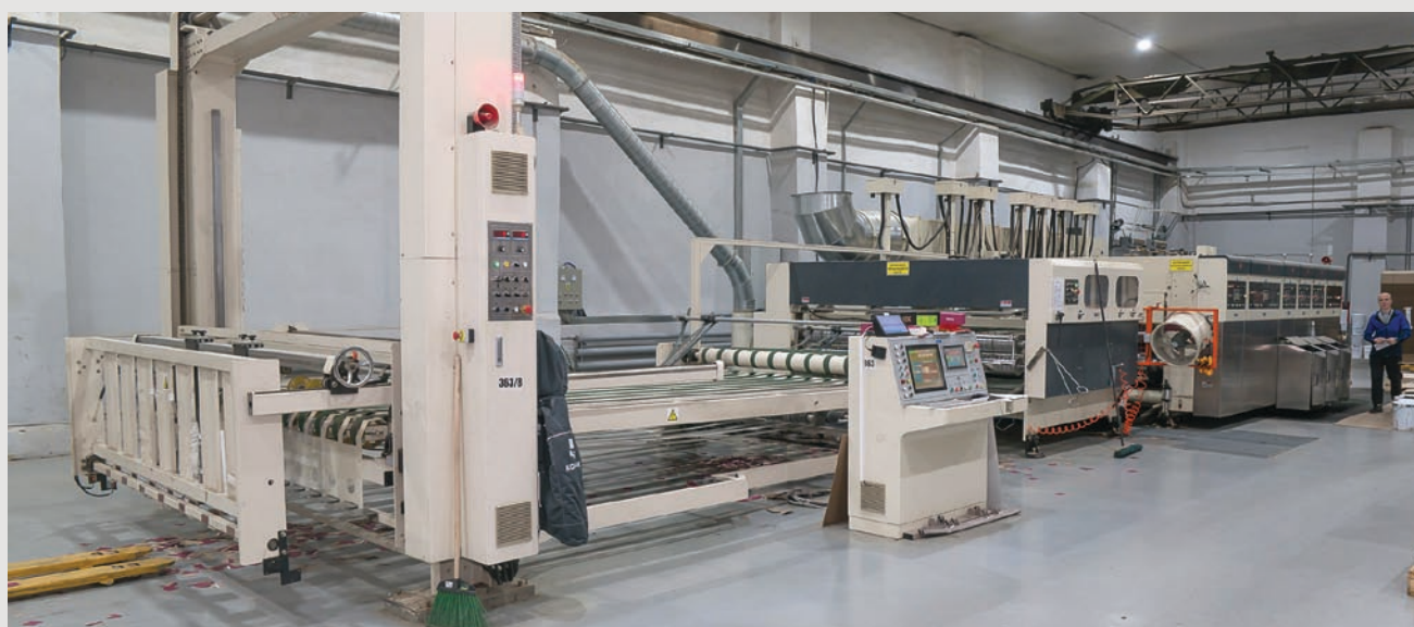
Ротационная флексографская печатная машина, объединенная с секцией высечки, позволяет «Комупак» выпускать брендированные коробки разных конструкций
