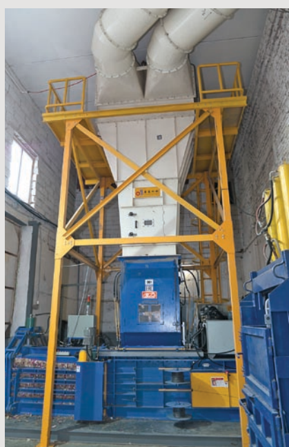
В новом цехе смонтирована современная автоматизированная система аспирации бумажных и картонных отходов
