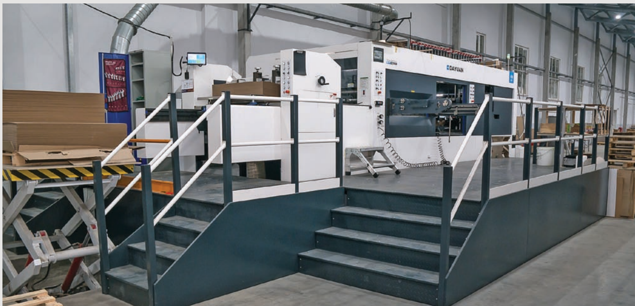
Новое приобретение компании — современный пресс для высечки большого формата Dayuan BHT-1650 FC
