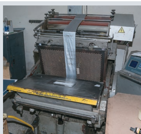
Высечка и тиснение на тигельном прессе и своя фальцовка-склейка позволяют производить картонную упаковку
