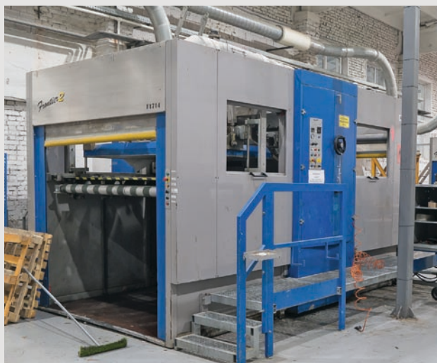
Два валковых пресса применяются для высечки заготовок с использованием плоских штампов
