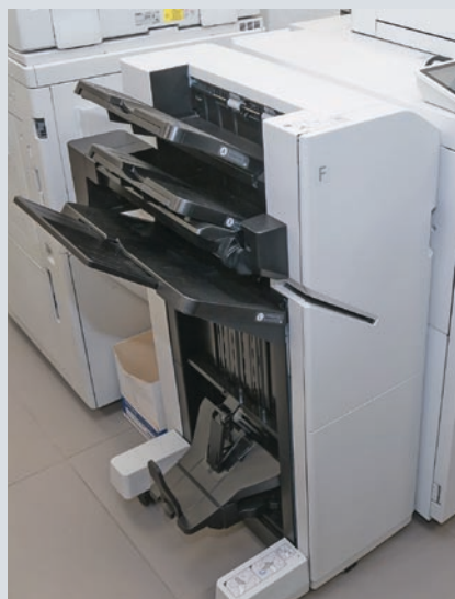
Большинство машин Canon оснащены послепечатным модулем, осуществляющим различные виды скрепления проволокой и экостеплирование (без скрепок)
