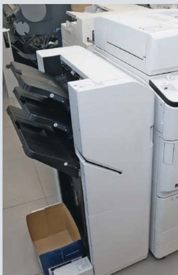
Большинство машин Canon оснащены послепечатным модулем, осуществляющим различные виды скрепления проволокой и экостеплирование (без скрепок)
