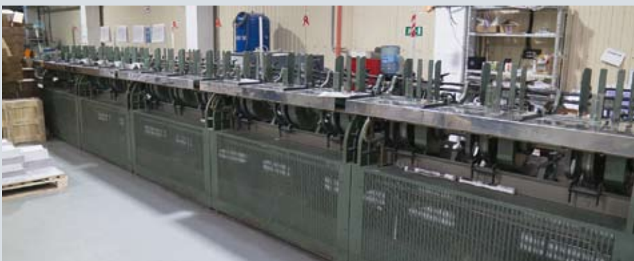
Комплект оборудования для производства объемных изданий: подборка и две машины клеевого бесшвейного скрепления
