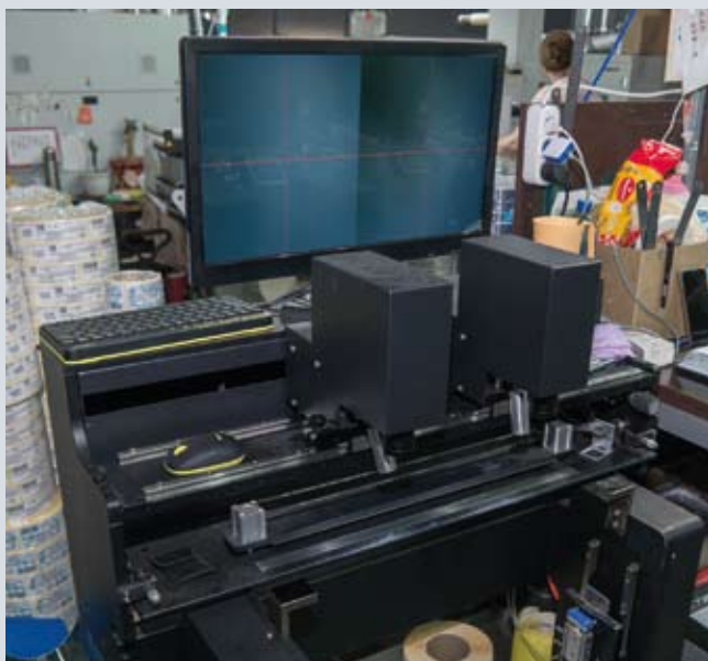
В комплекте с печатной машиней Label Source типография получила систему высокоточного монтажа форм на печатный цилиндр с видеоконтролем
