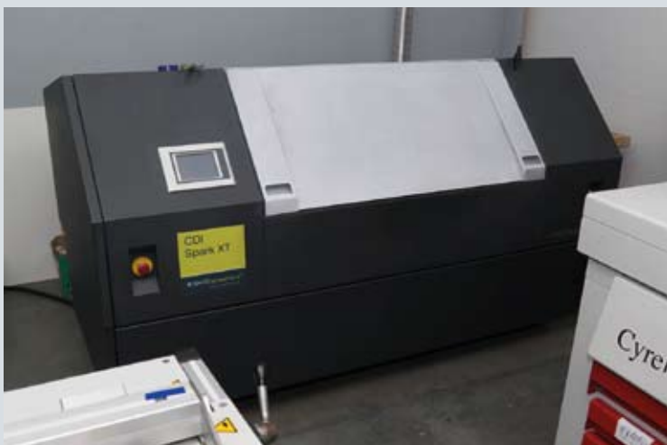
В типографии есть собственный комплекс оборудования для изготовления флексографских печатных форм
