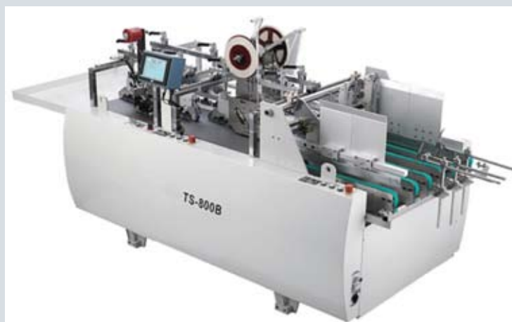
Устройство приклейки скотча и разрывной ленты. Справа аппликатор скотча
