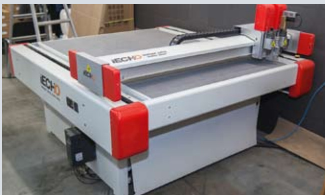
В типографии есть режущий плоттер iECHO для «цифровой высадки» пробных и тестовых экземпляров упаковки, а также устройство для вывода офсетных печатных форм
