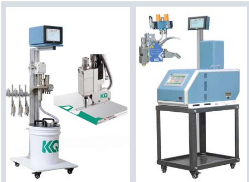
Спреевая система KQ для холодного (слева) и горячего клея
