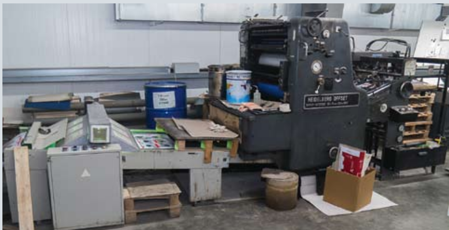
Однокрасочная печатная машина, переделанная в машину для УФ-лакирования
