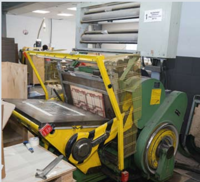
До недавнего времени высечка заготовок коробок проводилась на тигельных прессах, а фальцовка/склейка — на специализированном оборудовании.
