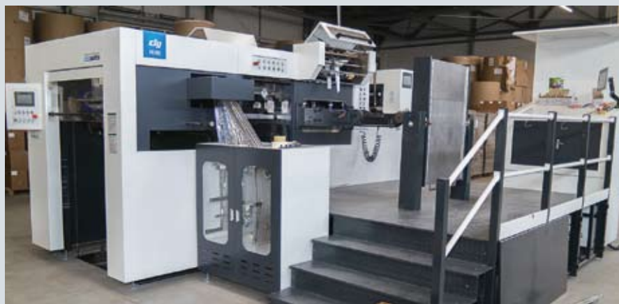
Некоторое время назад в типографии были установлены сразу два новых пресса компании Dayuan. Один — предназначен для высечки заготовок из картона и гофрокартона, другой — для тиснения фольгой по картону и лайнеру
