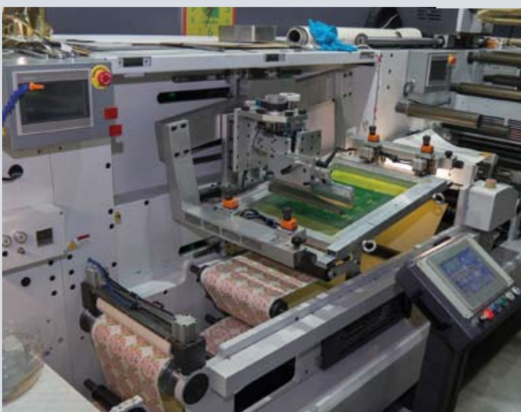
Для отделки оттисков, отпечатанных на офсетной рулонной или на прежних флексографских машинах, в типографии используется печатно-отделочная линия с плоским модулем трафаретной печати
