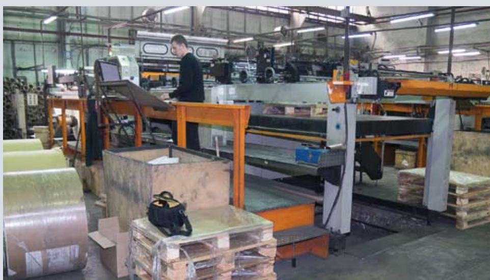
На производстве «Смарт-НН» работает несколько листорезальных машин Goodstrong с верхним вращающимся и нижним неподвижным ножами, предназначенных для высокоточной резки бумаги и картона. Они гарантируют чистый и четкий рез без волокон и пыли
