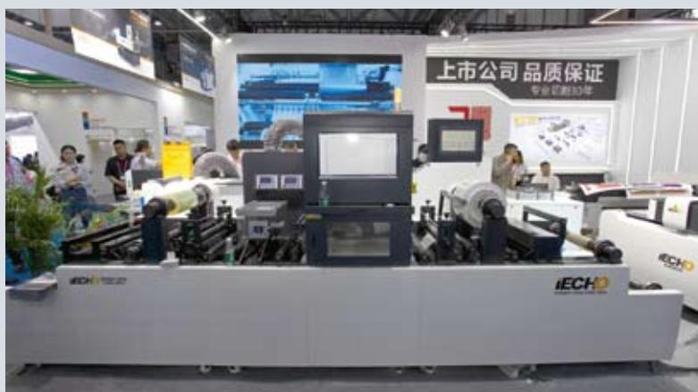
Слева: одноножевое устройство для надсечки этикеток с рулонной подачей. Помимо надсечки, возможна нарезка на отдельные листы. Справа: лазерное устройство надсечки этикеток с возможностью ламинации и удаления облоя
