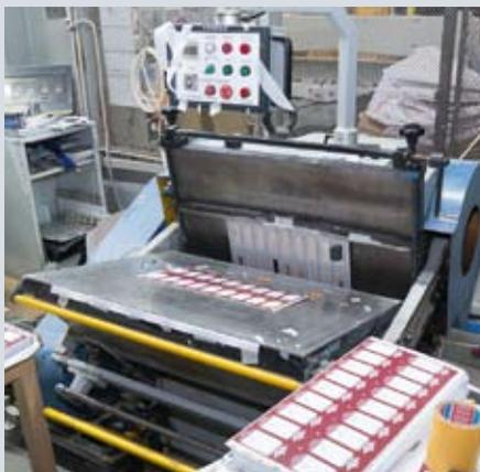
Для высечки заготовок из картона в типографии используются разные тигельные прессы
