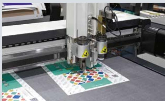
Слева: планшетное режущее устройство с автоматической подачей листов и выкладом. Справа: рабочие инструменты планшетных режущих плоттеров
