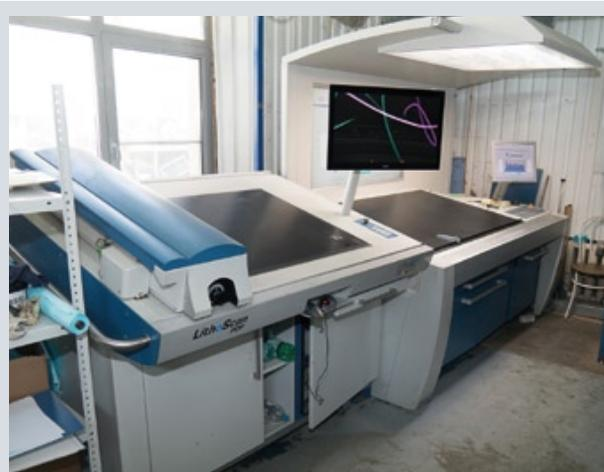
Обе машины Koenig & Bauer оснащены системами автоматического контроля качества печати производства Lithex, состоящими из сканирующего стола (на фото) и модуля автоматического считывания полей контрольной шкалы
