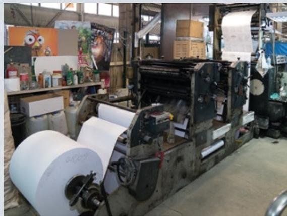
Рулонный печатный парк типографии позволяет снизить себестоимость изготовления многополосной продукции
