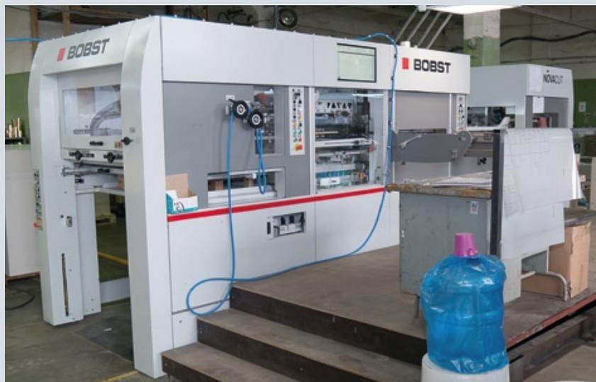
Фальцевально-склеивающая линия VisionFold 80A2 и пресс для высечки Novacut 106 E для производства картонной упаковки установлены в типографии «АПД»
