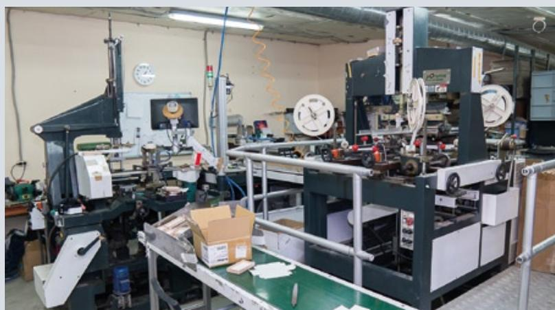
Специализированное оборудование для производства картонных коробок крышка-дно. Справа — тигельный пресс для вырубки
