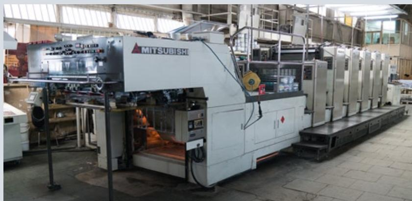
В типографии «Финтрекс» установлены печатные машины первого формата японского производителя Mitsubishi — четырехкрасочная и пятикрасочная с секцией лакирования Mitsubishi Diamond 3000S. Они позволяют работать с большим диапазоном бумаг (от тонких до плотного картона) в режиме частой смены заказов
