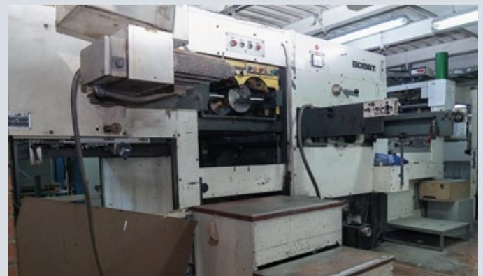
Парк послепечатного оборудования типографии «Арбат» для производства упаковочной продукции. На фото — вырубной пресс и пресс для тиснения фольгой от компании Bobst
