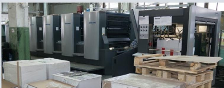
Парк печатных машин типографии «АПД» представлен оборудованием компании Heidelberg: четырех- и пятикрасочными офсетными машинами Speedmaster формата А2 и А1
