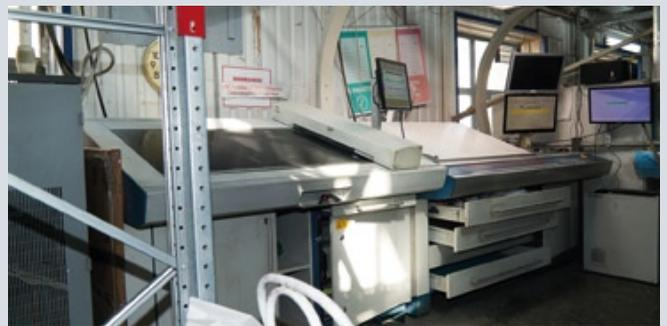
Шестикрасочная печатная машина Rapida RA105ZF-6+L CX ALV2 переориентирована на печать упаковки традиционными масляными красками, чтобы иметь возможность предлагать клиентам разные технологии производства картонной упаковки. Машина также оснащена системой контроля качества печати от Lithes
