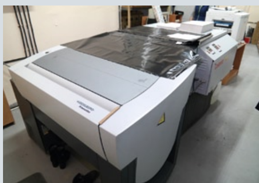
В типографии «Ника» организован собственный участок вывода офсетных форм на базе CtP от компании Heidelberg
