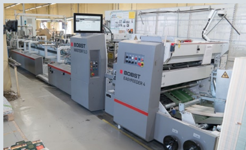
Одна из недавних инсталляций — фальцевально-склеивающая линия Bobst Masterfold 75 A1 в максимальной комплектации, оснащенная автоматизированными системами. В частности, устройством подачи заготовок Easy Feeder, устройством упаковки готовой продукции в гофрокороба Carton Pack, системой видеоконтроля, а также системой считывания штрих-кодов. С появлением этого оборудования типография получила запас прочности по производительности
