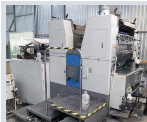
Офсетная печатная машина с устройством переворота листа используется для изготовления инструкций к лекарственным препаратам
