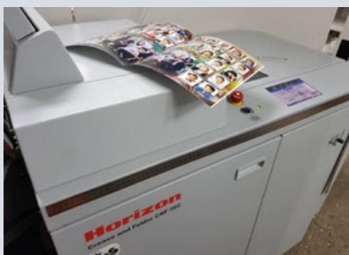
Часть комплекса послепечатного оборудования «Фото Фиера» — биговально-фальцевальная машина для цифровых отпечатков, вырубной пресс, ламинаторы и т. д.
