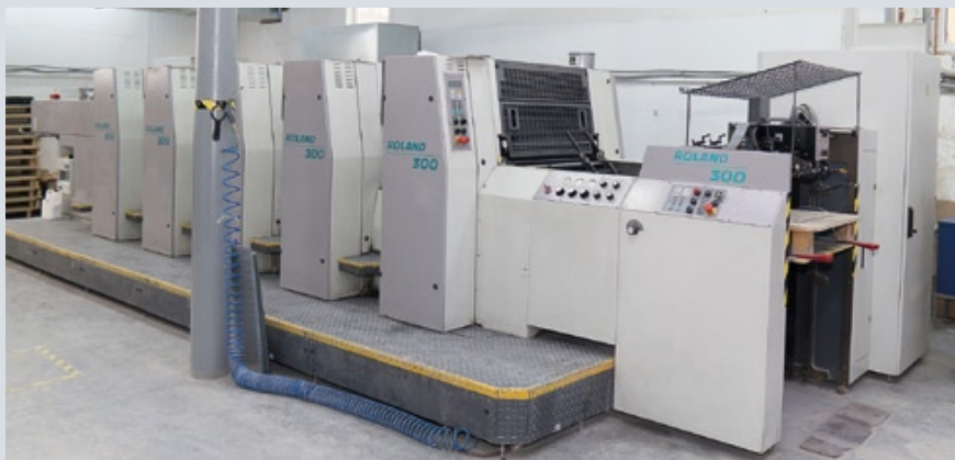
Пятикрасочная печатная машина Roland 300 максимально отвечает потребностям типографии «Ника» в производстве малоформатной упаковки, в том числе для фармацевтической отрасли
