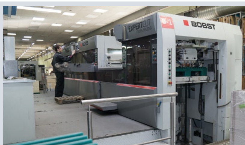
Для вырубки заготовок картонной упаковки в «Индустрии цвета» используют вырубные прессы компании Bobst разных моделей
