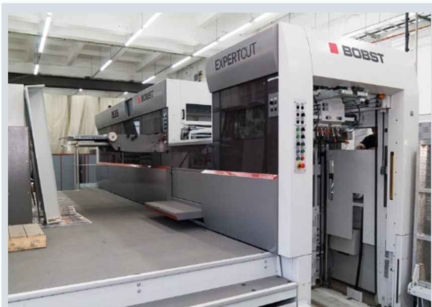
В этом году в типографии «Индустрия цвета» приобрели новый вырубной пресс Bobst Expertcut 106 LER 3.0. Вырубной пресс обладает высокой автоматизацией, что позволит заметно повысить производительность на данном участке, сократить количество отходов и обеспечить быструю перенастройку
