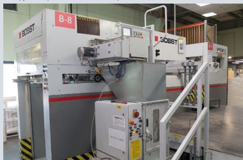
Пресс для горячего тиснения фольгой Bobst Visionfoil 104H оснащен опцией для работы с приводной голограммой. Он позволяет работать одновременно с шестью потоками голографической фольги. Таким образом, за один прогон можно выполнить любую по сложности декорирования работу
