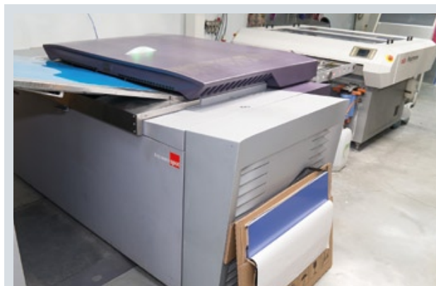
Собственный участок допечатной подготовки оснащен двумя термальными СтР-устройствами с онлайн проявкой. Для вывода печатных форм используются пластины Agfa
