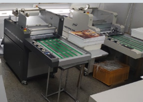
Часть комплекса послепечатного оборудования «Фото Фиера» — биговально-фальцевальная машина для цифровых отпечатков, вырубной пресс, ламинаторы и т. д.
