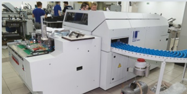
Для изготовления переплетных крышек работают современные крышкоделательные машины Kolbus, одна из которых установлена совсем недавно
