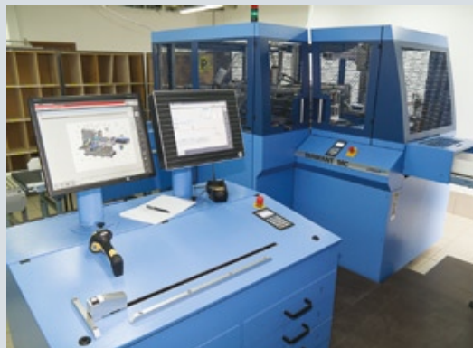
В компании «Фотоэксперт» установлена уникальная книжная линия Muller Martini Diamant MC Book Of One, многие возможности которой специально проработаны для задач компании «Фотоэксперт»
