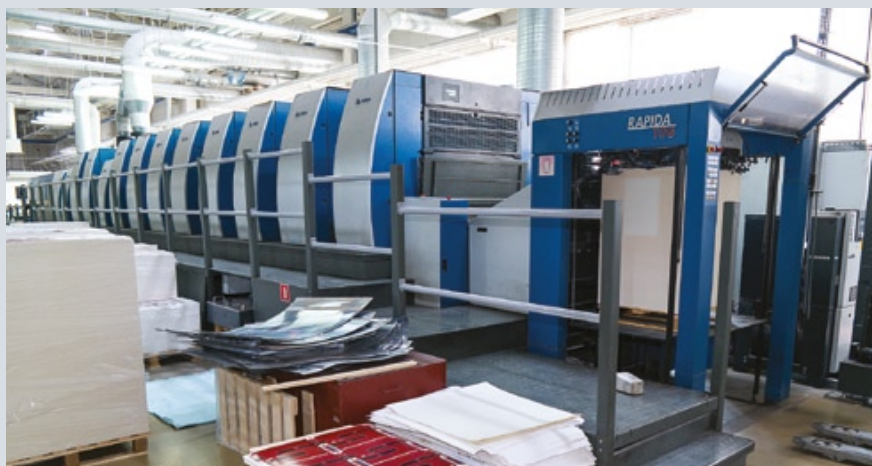
В «Графобал-Дон» недавно установлена восьмикрасочная печатная машина Rapida 106 с двумя секциями лакирования
