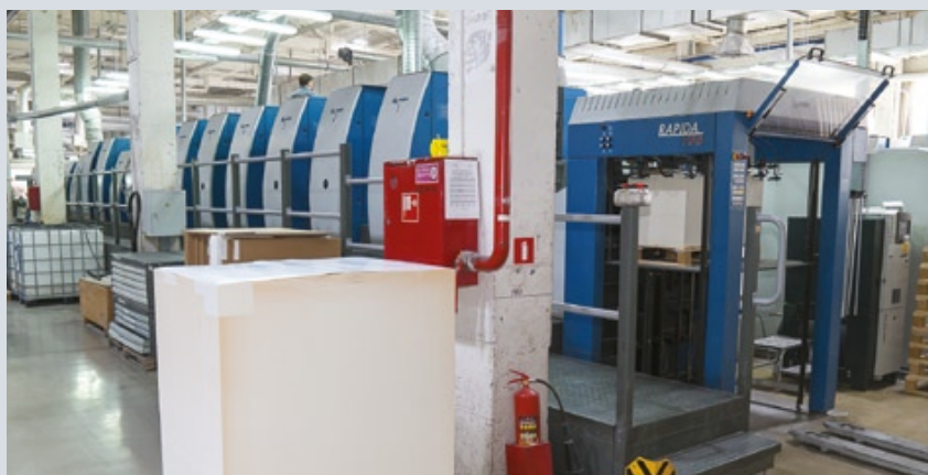
На предприятии работают три печатные машины Koenig&Bauer в серьезной комплектации, как для работы с УФ-красками, так и с традиционными масляными
