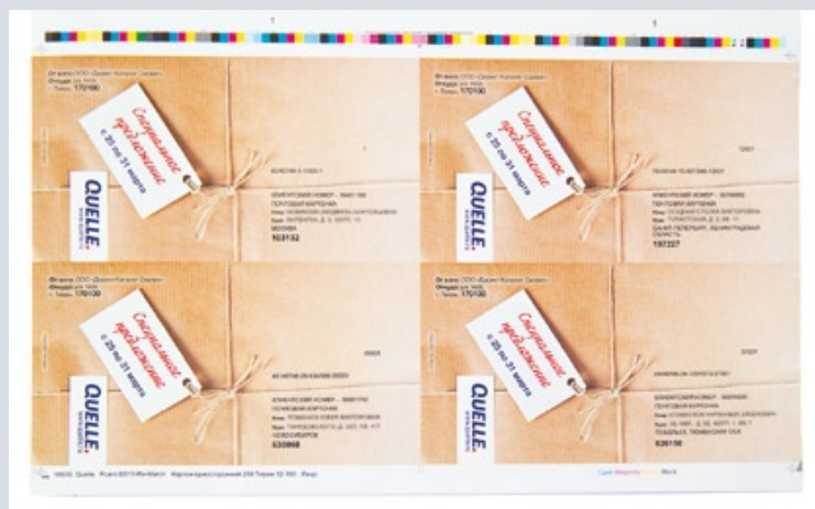
Пример использования персонализации на объемных конвертах. Информация впечатывается на цифровой машине Versafire CM (Ricoh PRO 8110 E)
