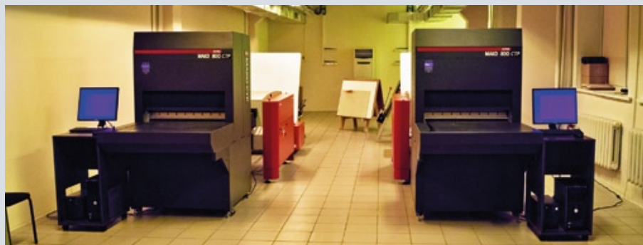
С 2011 г. на предприятии полностью обновили допечатный участок и перешли на бесхимическую технологию изготовления офсетных форм, благодаря которой удалось добиться желаемых показателей экономичности и тиражестойкости
