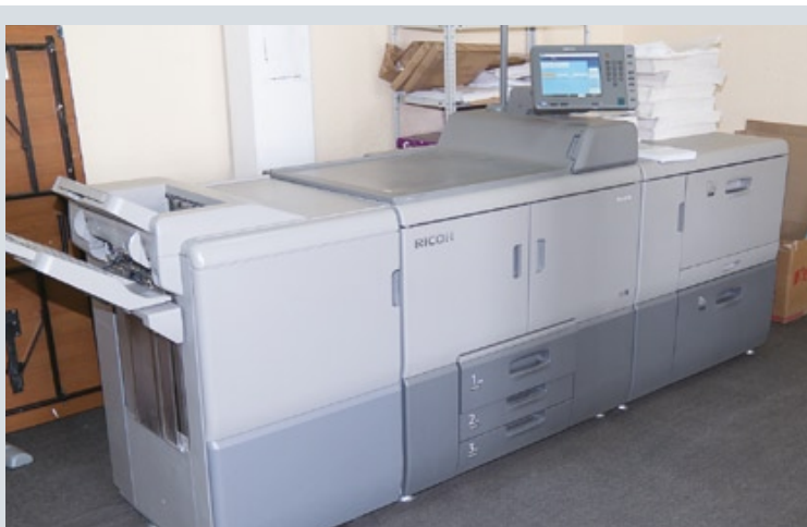
В типографии заметно увеличился объем заказов, требующих впечатления дополнительной персонализированной информации. Для этого специально приобрели монохромную цифровую машину Versafire CM (Ricoh PRO 8110 E), которая печатает и на тонкой бумаге, и на плотном картоне, и на заготовках промокоробок и конвертов
