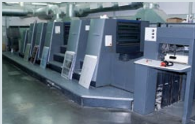
Печатный парк оборудования типографии «Шар» представлен машинами Heidelberg. Одно из последних приобретений — печатная машина первого формата Heidelberg Speedmaster CD 102-6+L (слева)
