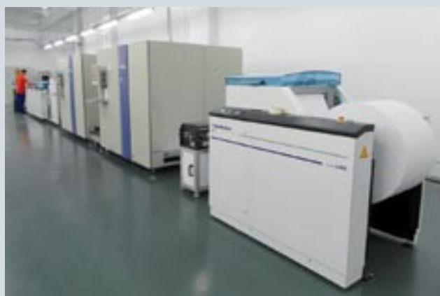
Первая в России рулонная цифровая машина Screen Truepress Jet 520EX установлена на новой полиграфической площадке Издательства «Известия». Она позволит оперативно и рентабельно изготавливать книги любым тиражом
