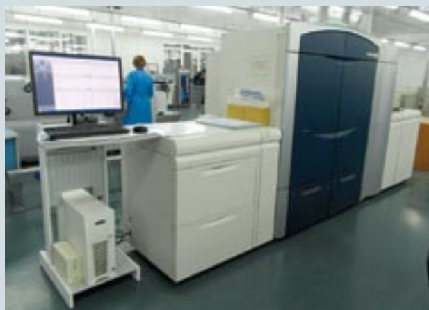
Для печати полноцветной продукции (в частности, цветных обложек книг, рекламных каталогов, брошюр и т. д.) в типографии используется оборудование компании Xerox — цифровые машины Xerox iGen4 и Xerox Color 800
