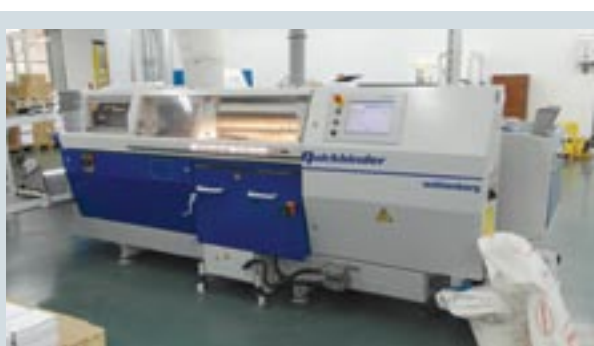
Машина для клеевого бесшвейного скрепления Wohlenberg Quickbinder позволяет автоматически получать проклеенные книжные блоки, а также производить подготовку корешка для твердого переплета и наносить марлю на книжный блок
