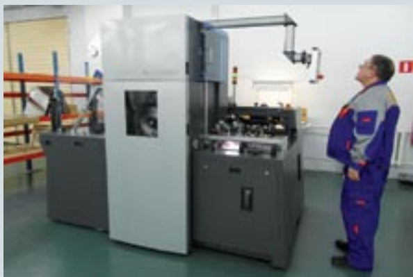
Универсальный автомат KAMA ProCut 53F для высечки, биговки, перфорации, конгрева и горячего тиснения фольгой
