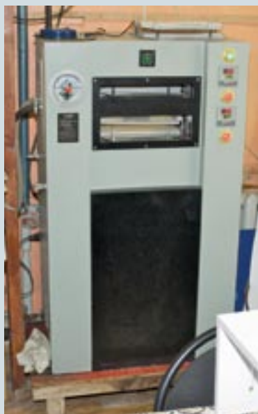
Оборудование для производства пластиковых и картонных карт: печь для спекания листов пластика, вырубной пресс и устройство для нанесения скретч-полосы
