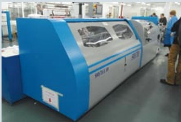
Фальцевально-швейный аппарат Smyth F-145 DigitalLine специально предназначен для фальцевания и подборки листов/тетрадей, отпечатанных цифровым способом
