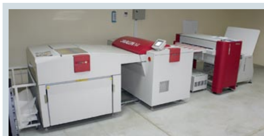
Бесхимический автоматизированный комплекс Agfa :Avalon N4 для экспонирования термальных офсетных пластин инсталлирован в типографии в прошлом году
