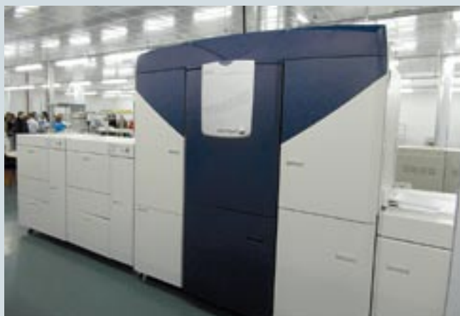
Для печати полноцветной продукции (в частности, цветных обложек книг, рекламных каталогов, брошюр и т. д.) в типографии используется оборудование компании Xerox — цифровые машины Xerox iGen4 и Xerox Color 800
