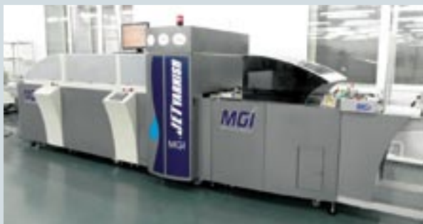
Цифровая машина MGI JET Varnish предназначена для сплошного и выборочного УФ-лакирования цифровых оттисков. На ней можно получать рельефные эффекты
