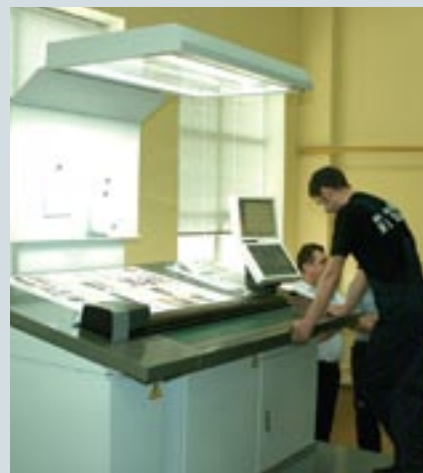
Новинка комбината — восьмикрасочный суперперфектор Komori Lithrone 444SP формата 820x1130 мм и центральный пульт управления со спектрофотометрическим контролем оттисков
