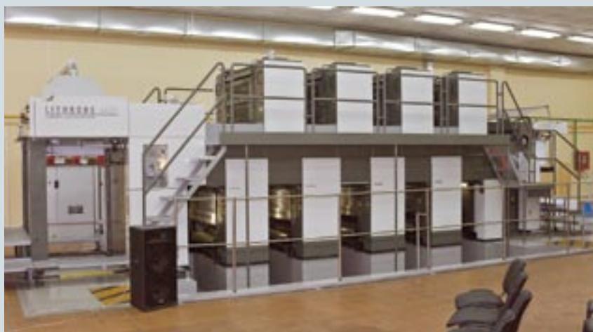
Новинка комбината — восьмикрасочный суперперфектор Komori Lithrone 444SP формата 820x1130 мм и центральный пульт управления со спектрофотометрическим контролем оттисков
