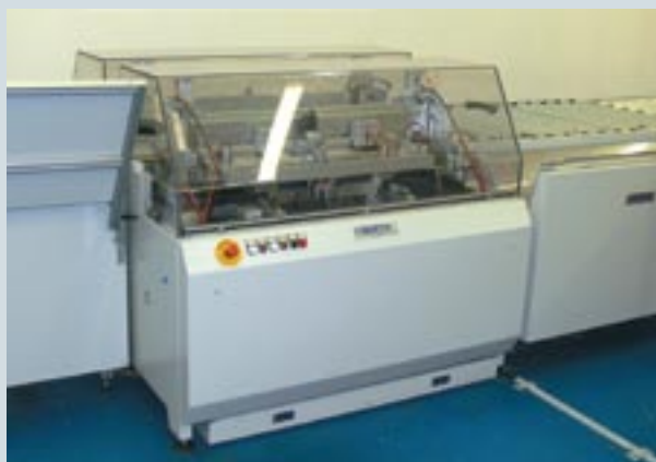
Одна из двух систем CtP Agfa Avalon с on-line проявочным процессором (слева) и система автоматической пробивки штифтовых отверстий в готовых формах (справа), позиционирующая пластины «по изображению». После такой пробивки регулировка приводки на печатной машине практически не требуется
