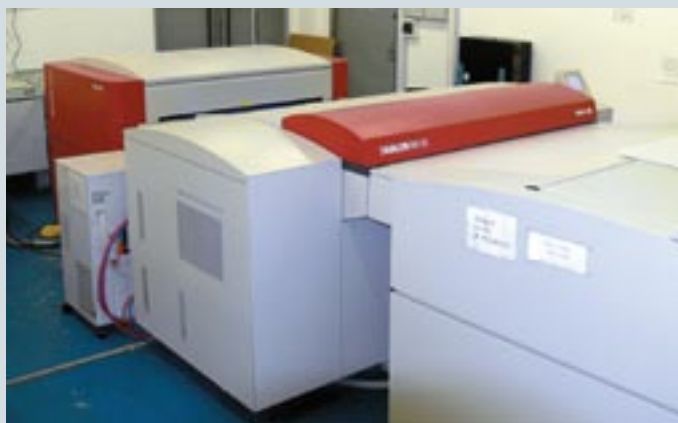
Одна из двух систем CtP Agfa Avalon с on-line проявочным процессором (слева) и система автоматической пробивки штифтовых отверстий в готовых формах (справа), позиционирующая пластины «по изображению». После такой пробивки регулировка приводки на печатной машине практически не требуется
