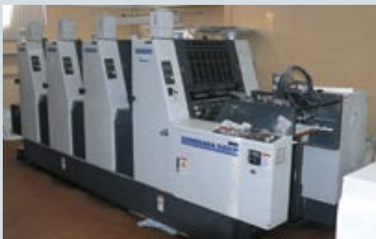
Часть офсетной технологии изготовления продукции для метрополитена: одна из двух офсетных машин, печатающих фольевыми красками, и устройство фотовывода. Переходить на технологию СтР в типографии «Базил» не планируют. Наличие большого объема работ трафаретной печати вынуждает иметь фотовывод, а поддерживать две технологии работы накладно
