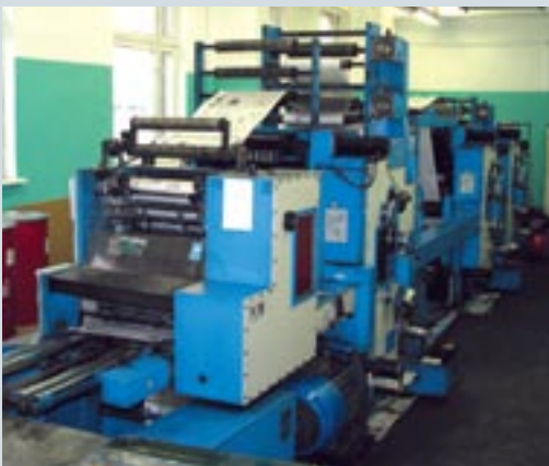
Небольшие по формату и объему газеты типография печатает на газетной машине с шириной рулона 420 мм. Формат ограничивает область применения машины, зато она компактная
