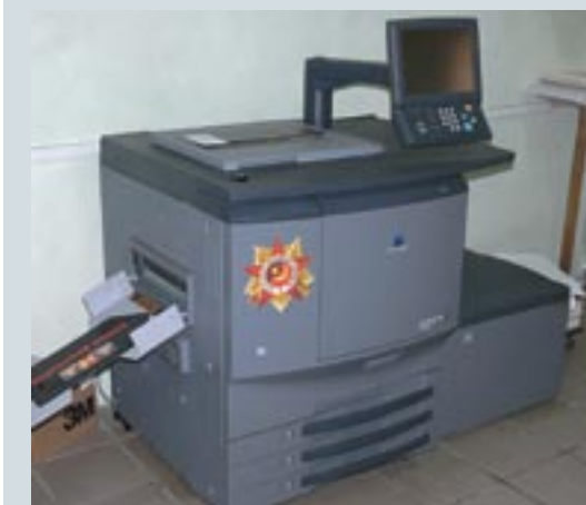
Вверху: то самое МФУ, на котором проводились первые эксперименты по печати на сложных полимерах. Внизу: Konica Minolta bizhub Pro 6500 с переделанным выкладом, на которой сейчас печатается основная масса метростикеров цифровым способом
