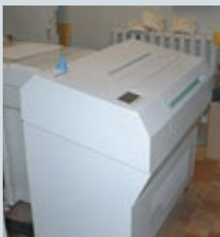
Часть офсетной технологии изготовления продукции для метрополитена: одна из двух офсетных машин, печатающих фольевыми красками, и устройство фотовывода. Переходить на технологию СтР в типографии «Базил» не планируют. Наличие большого объема работ трафаретной печати вынуждает иметь фотовывод, а поддерживать две технологии работы накладно
