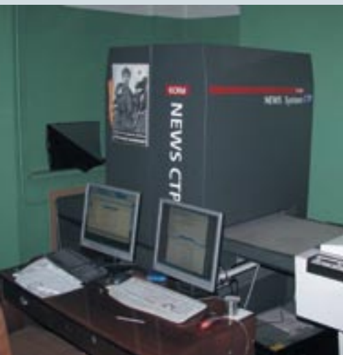
Печатные формы для всех рулонных и листовых машин в типографии изготавливают при помощи CtP-системы фирмы ECRM. И хотя установленное устройство считается чисто газетным, оно вполне успешно справляется с изготовлением форм и для коммерческой продукции
