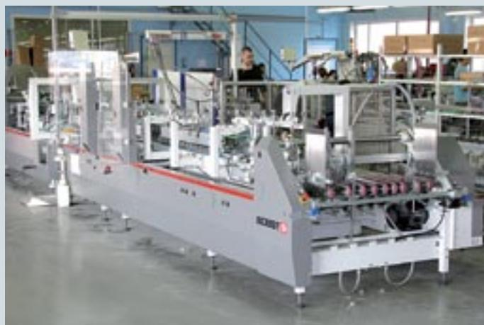
*Вся послепечатная обработка упаковки (вырубка, фальцовка и склейка) в «Типографии «Печатня» проводится на оборудовании компании Bobst. Вверху — вырубной пресс Bobst Speria 106, внизу — две разные модели фальцевально-склеивающих машин Mistral и ExpertFold*
