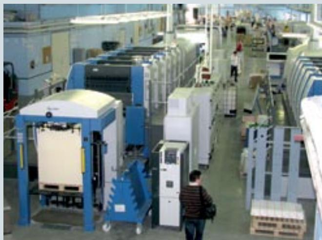
В просторных цехах типографии работают несколько печатных машин KBA. На новой машине (слева) можно рассмотреть специальный высокий загрузочный стапель
