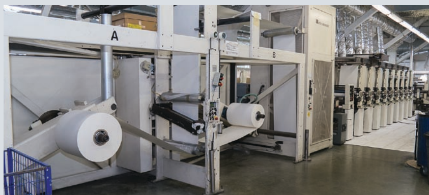
Печатный парк флексографского оборудования компании «Флексознак» состоит из трех флексографских машин Mark Andy Comco с устройствами ротационной высечки на выходе
