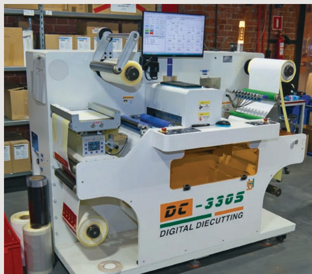
Рулонная цифровая печатная машина для печати на самоклеящихся материалах (слева) и машина для механической надсечки этикеток
