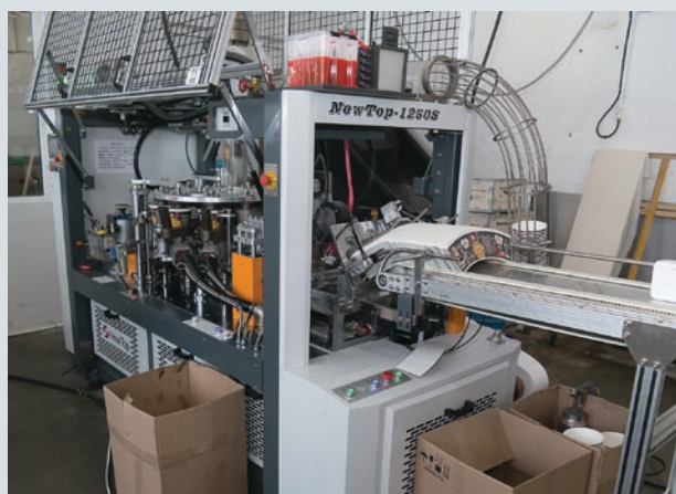
В прошлом году в компании было установлено несколько единиц оборудования для формирования стаканов различных типов, они используются и для напитков, и в качестве упаковки продуктов питания
