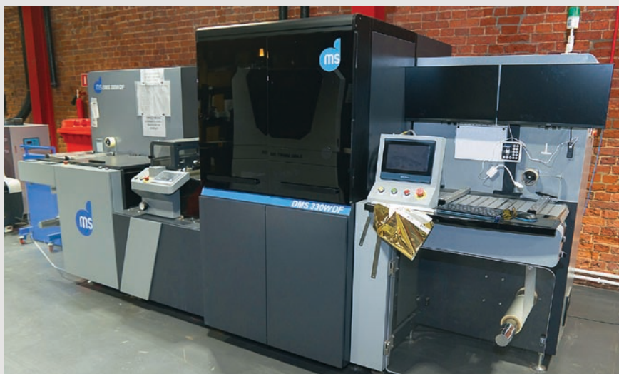
Машина для цифровой отделки (сплошной и выборочный лак, фольга) рулонной продукции, отпечатанной на цифровой машине
