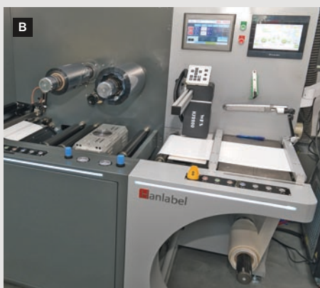
Узлы машины: а) узел размотки, склейки, выравнивания полотна и обработки коронным разрядом; б) узел струйной печати лаком; в) узел тиснения фольгой, купольной металлизации, видеоконтроля качества и намотка готовой продукции
