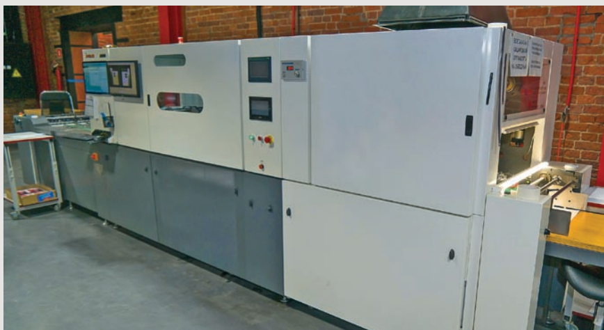
Машина для цифровой отделки (сплошной и выборочный лак, фольга) листовой продукции. Сейчас используется для отделки оттисков, отпечатанных офсетным способом
