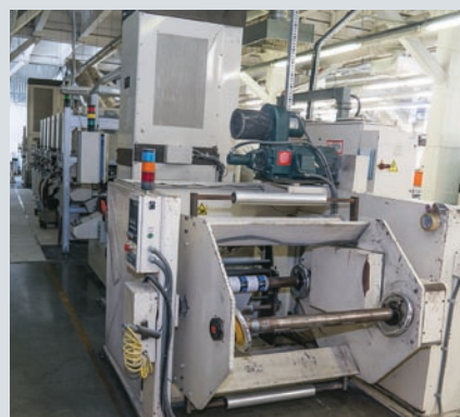
Печатный парк флексографского оборудования компании «Флексознак» состоит из трех флексографских машин Mark Andy Comco с устройствами ротационной высечки на выходе
