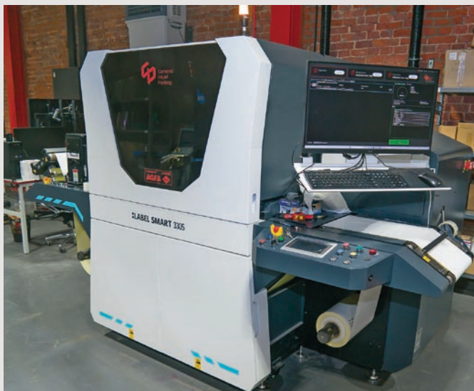
Рулонная цифровая печатная машина для печати на самоклеящихся материалах (слева) и машина для механической надсечки этикеток
