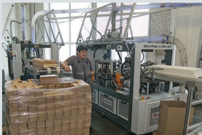
В прошлом году в компании было установлено несколько единиц оборудования для формирования стаканов различных типов, они используются и для напитков, и в качестве упаковки продуктов питания
