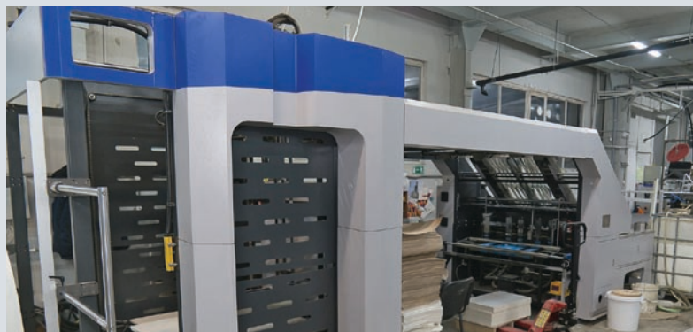
Собственный гофроагрегат и кашировальная линия позволяют типографии производить кашированную гофроупаковку
