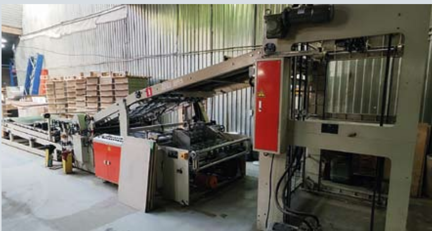
Гофроагрегат и кашировальная машина позволяют производить гофроупаковку
