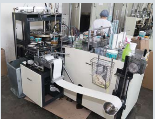
Машина для формирования чаш (слева) и станок для формирования чаш для салатов
