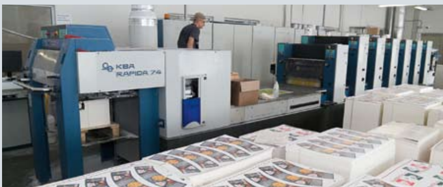
Участок офсетной печати: листовая машина KBA Rapida 74
