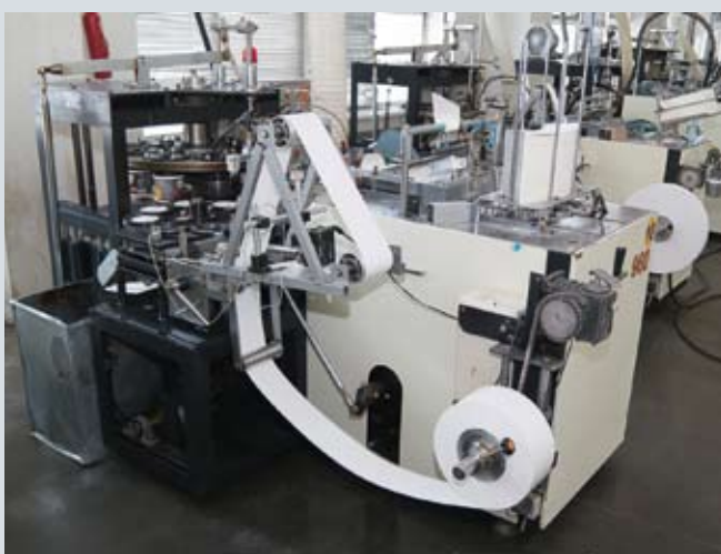
Машина для формирования чаш (слева) и станок для формирования чаш для салатов
