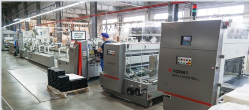
На Калужской площадке работает уникальная фальцевально-склеивающая линия Bobst MasterFold 75A1 в очень серьезной конфигурации
