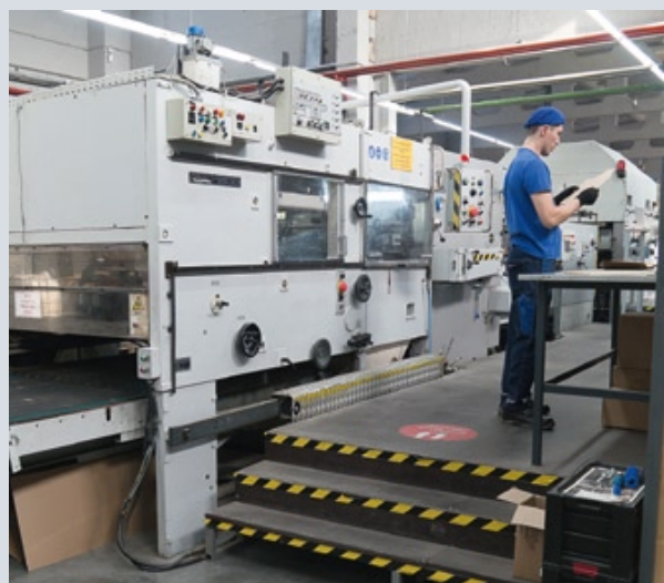
Для изготовления упаковки из гофрокартона в компании установлена линия Bobst SPO Flexo 160, состоящая из флексографской машины, пресса для высечки и брейкера
