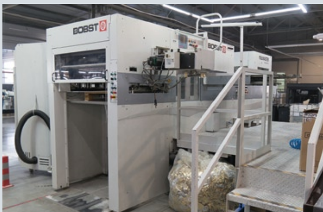
Пресс для тиснения фольгой SP 104 FoilMaster от компании Bobst
