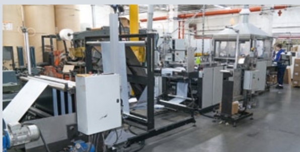
Вверху: линия для производства бумажных конвертов, внизу: линия для изготовления почтовых конвертов из полиэтилена
