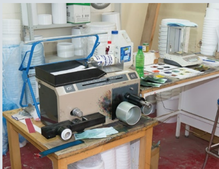
В московском филиале: слева — станция смешения красок и машинка для выкрасов, справа — заточка ножей для резаков
