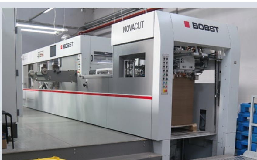
Некоторое время назад на калужской производственной площадке холдинга «Курт» появился новый вырубной пресс Bobst NovaCut 106ER с разделением заготовок, который используется для производства картонной упаковки
