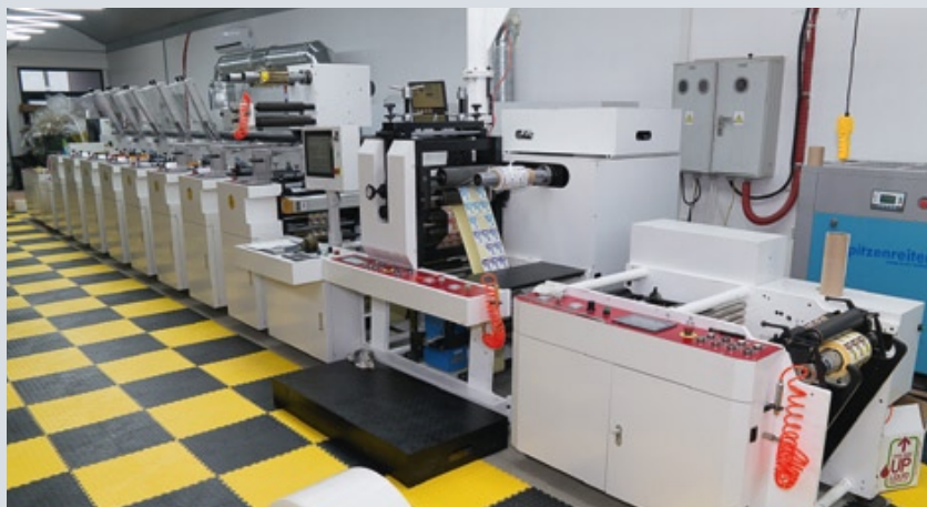
Установленная во «Флексе» восьмикрасочная машина DongHeng DHF20350-8 позволяет запечатывать широкий спектр материалов: от тонких пленок до картона
