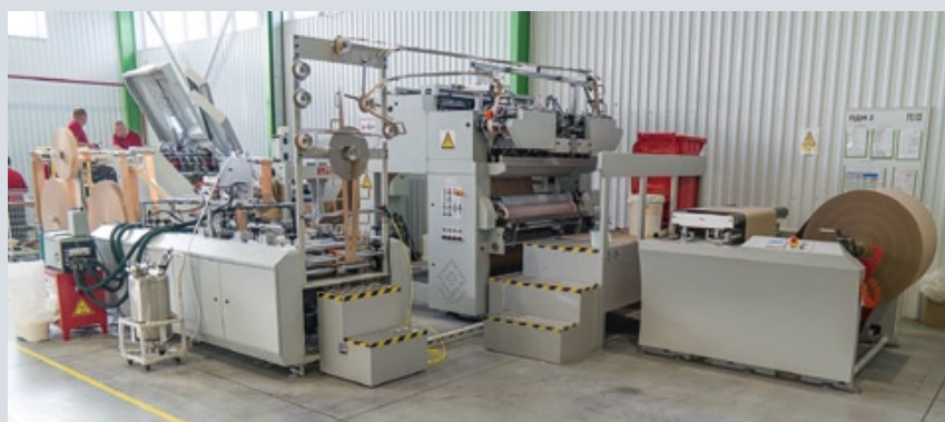
В ПЗБМ недавно были установлены восьмикрасочная флексографская машина и современные линии Ruizhi по выпуску пакетов разных размеров
