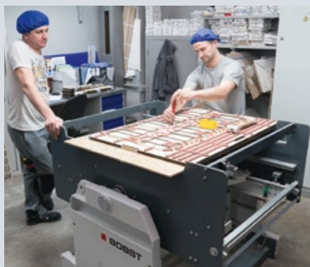
На предприятии есть собственное подразделение по подготовке, ремонту и модернизации штампов для высечки
