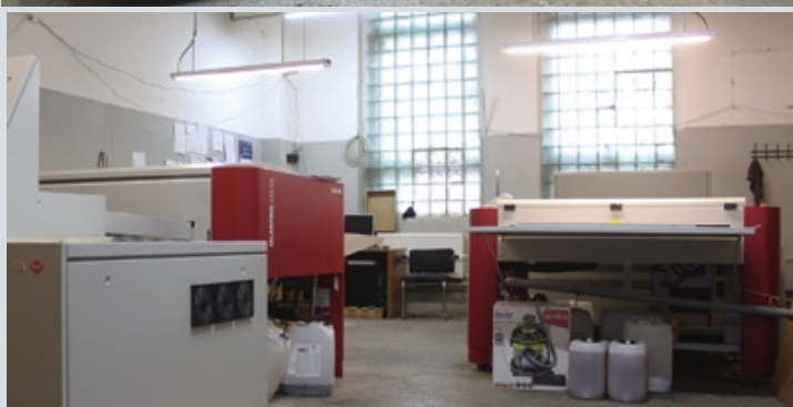
В петербургском филиале «Полиграф-Клуб» работает репроцентр, где на Agfa Avalon делают формные пластины на заказ
