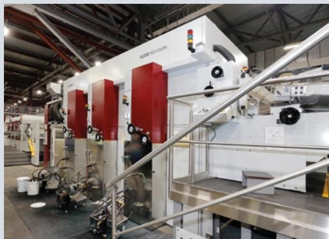
Флексографская машина Flexo-160 Vision на ППГК стала 100-й машиной, установленной в мире от компании Bobst. Машина имеет три печатные секции с возможностью апгрейда до пяти
