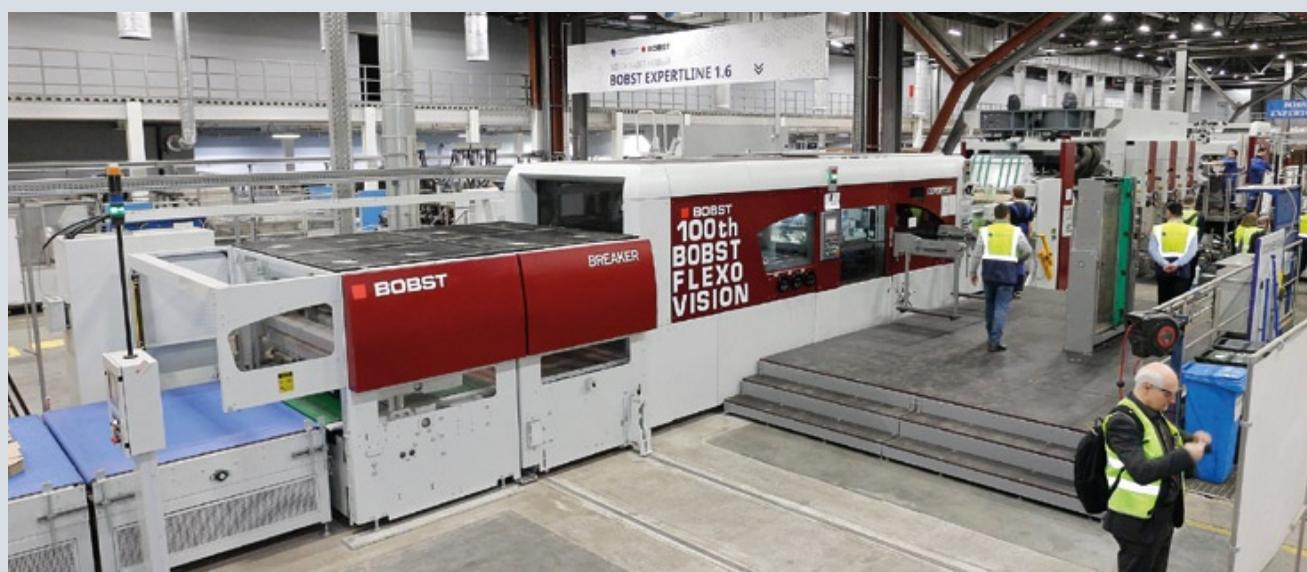
Линия Bobst Expertline 1.6, установленная на «Павлово-Посадском Гофрокомбинате», для изготовления гофрокартонных коробок. В состав линии входит устройство автоматической подачи листа Loader AF, флексографская машина Flexo-160 Vision, плоский высекальный пресс Expertcut 1.6 и устройство разделения заготовок Breaker
