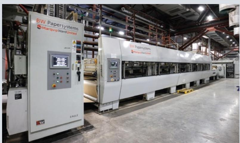
Гофроагрегат BW Papersystems для производства трехслойного и пятислойного гофрокартона форматом 2500 мм
