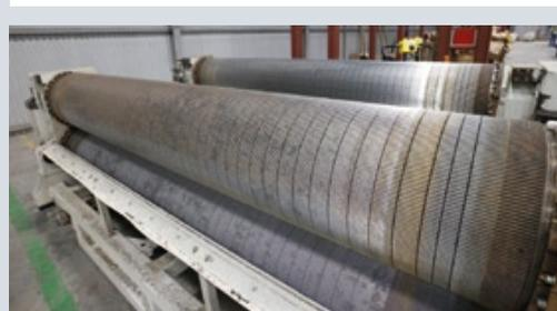
Гофрирующие валы для изготовления гофрокартона различных профилей
