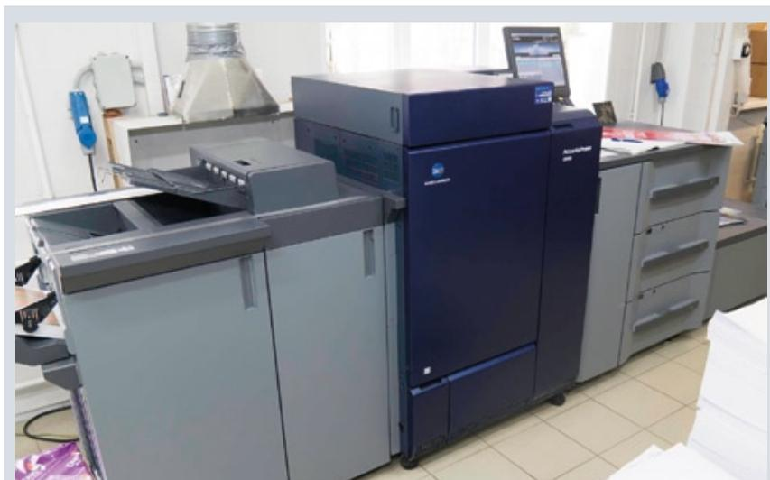
Недавно в «Типографии Лесник» установили новую машину Konica Minolta AccurioPress C6100. Она позволяет печатать на широком ассортименте материалов — на плотном картоне, специализированных и самоклеящихся бумагах и т. д. Обеспечивает профессиональный уровень цифрового производства, стабильность и высокое качество изображения
