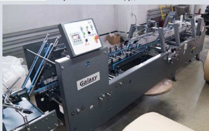
Освоение производства картонной упаковки потребовало дополнительного оборудования. В конце прошлого года на предприятии приобрели стопцилиндровый пресс Heidelberg Cylinder и фальцевально-склеивающую линию
