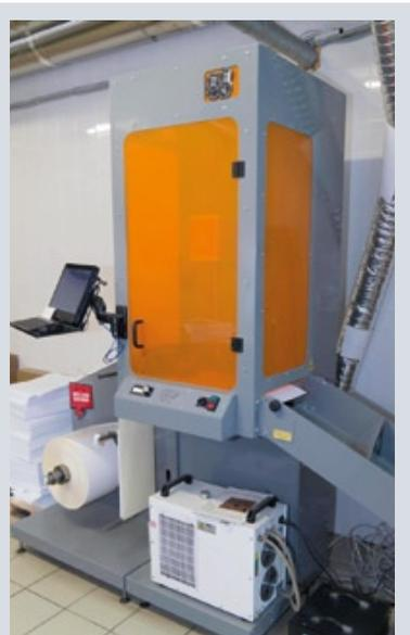
Устройство лазерной резки для изготовления самоклеящейся этикетки. Изделия сначала надсекаются лазером, а затем листы подаются в цифровую печатную машину для запечатывания
