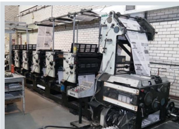
В типографии работает парк рулонных офсетных печатных машин для производства газет
