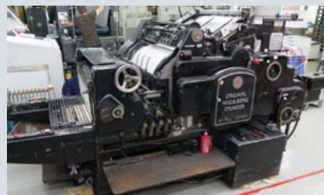
Среди послепечатной техники довольно много единиц оборудования от *Heidelberg*: линия *КБС Eurobind*, резальная машина *Polar 92x*, а также две стопцилиндровые машины *Heidelberg Cylinder* для вырубki, биговки и перфорирования
