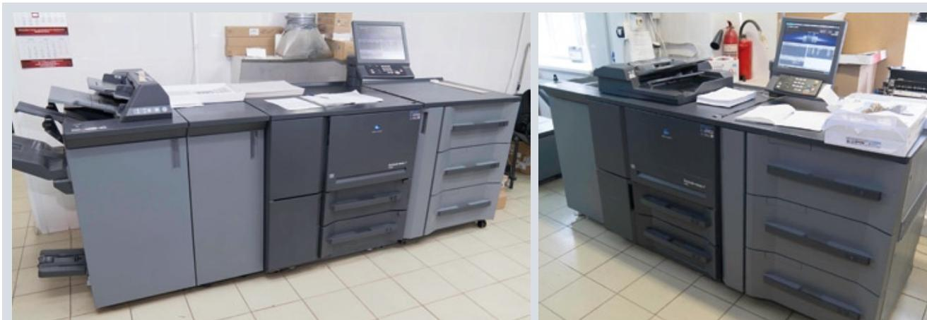
В «Типографии Лесник» работают четыре цифровые печатные машины Konica Minolta. На фото: устройства монохромной печати bizhub PRESS 1250P и bizhub PRESS 1052
