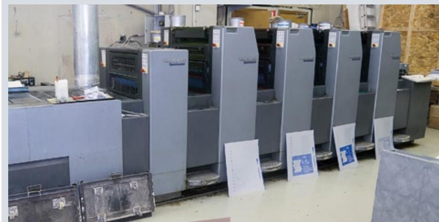
Офсетный парк полиграфической компании Stampa Viva строится на базе печатных машин компании Heidelberg. На фото: однокрасочная Heidelberg SORM второго формата, двухкрасочный Speedmaster третьего формата и четырехкрасочный Speedmaster с секцией лакирования для печати полноцветной продукции с отделкой в линию
