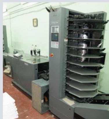
Послепечатное оборудование позволяет типографии «Перфектум» изготавливать много-полосные издания с разными видами скрепления. На фото: машина клеевого бесшвейного скрепления, ниткошвейная машина, листоподборочная линия со скреплением на скобу
