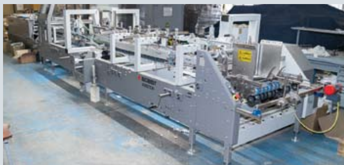
Новая фальцевально-склеивающая линия BOBST Ambition 106 — многофункциональная и высокопроизводительная машина, позволяющая обрабатывать коробки из картона и микрофроктона
