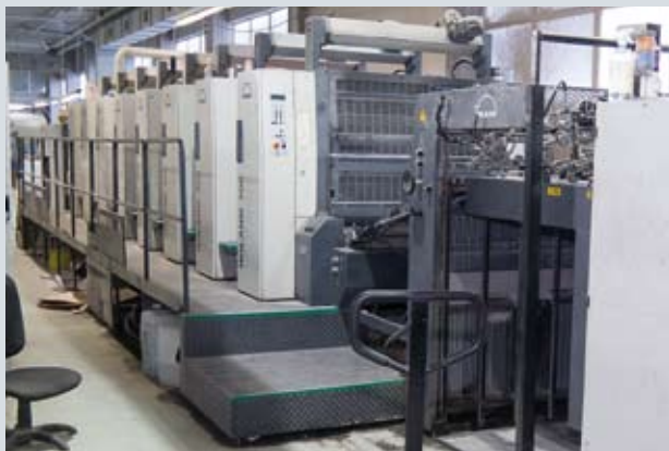
Восьмикрасочный Roland 700 HiPrint также с устройством переворота листа. Общая производительность двух машин manroland — до 400 тыс. оттисков формата А1 в сутки
