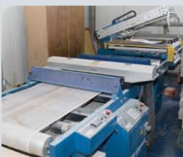
Трафаретная машина для декоративной отделки оттисков
