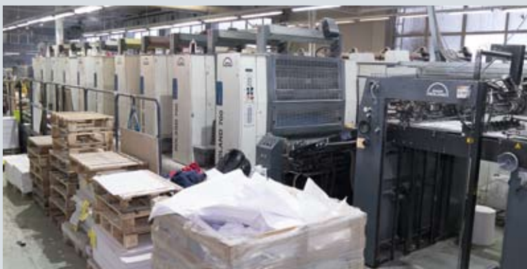
В типографии «ЛД-ПРИНТ» работают три печатные машины. Две основные из них Roland 700 HiPrint от компании manroland. На фото справа — десятикрасочная машина с секцией ВД-лакирования и устройством переворота листа
