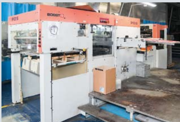
На предприятии с самого начала используют оборудование BOBST. На фото: высекальный пресс BOBST SP 102-SE и фальцевально-склеивающая линия BOBST Media 100-A-III
