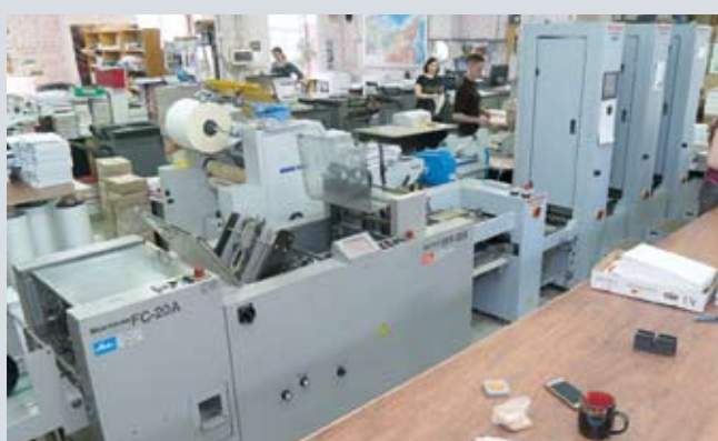
На предприятии работают две листоподборочные линии Horizon для подготовки книжных блоков
