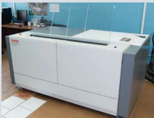
Процесс вывода печатных форм осуществляется на CtP-системе Kodak
