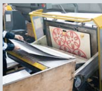
Тигельный пресс для вырубki заготовок
