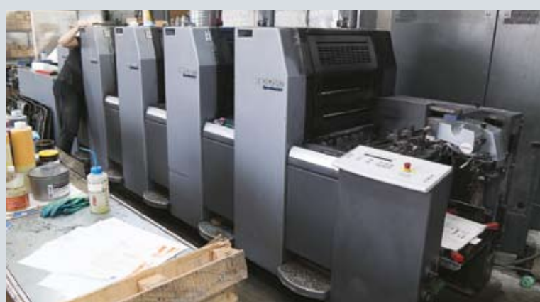
При развитых цифровых возможностях на предприятии не собираются отказываться от офсетной печати, считая ее основой стабильного и высокого качества полноцветной печати. На фото — первый в России Speedmaster SM 52-4 Anicolor производства Heidelberg, который был установлен в типографии «Формула Цвета»
