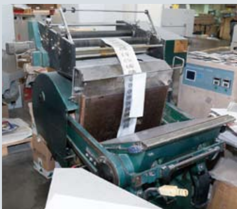
Часть оборудования для отделки продукции (ламинатор и пресс для тиснения)
