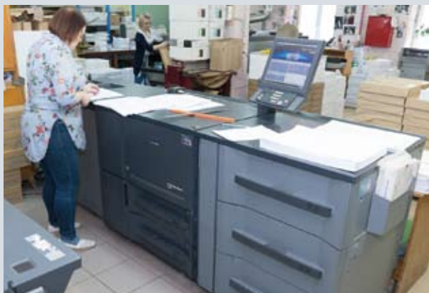
Парк печатного оборудования типографии «Канцлер» представлен цифровыми машинами Konica Minolta. На фото: оборудование серии bizhub PRESS 1250P для монохромной печати, преимущественно книжных блоков
