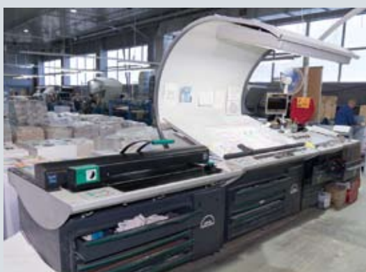
В типографии «ЛД-ПРИНТ» работают три печатные машины. Две основные из них Roland 700 HiPrint от компании manroland. На фото справа — десятикрасочная машина с секцией ВД-лакирования и устройством переворота листа
