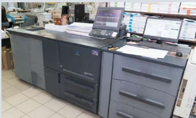
Парк печатного оборудования типографии «Канцлер» представлен цифровыми машинами Konica Minolta. На фото: оборудование серии bizhub PRESS 1250P для монохромной печати, преимущественно книжных блоков
