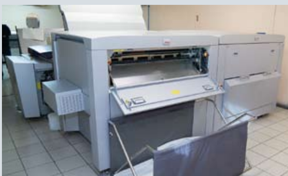
В типографии «ЛД-ПРИНТ» установлены два СтР-устройства Kodak Magnus 800. В прошлом году одну из линий (слева) полностью перевели на экологичную беспроцессную технологию экспонирования форм, демонтировав проявочную машину
