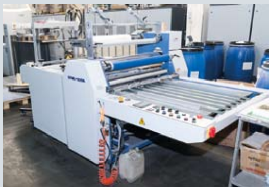
Часть оборудования для отделки продукции (ламинатор и пресс для тиснения)
