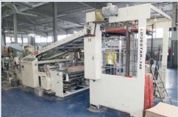
Кашировальная машина для приклейки верхнего запечатанного слоя (лайнера) к картону
