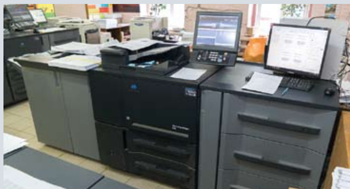
Высокопроизводительная монохромная ЦПМ Konica Minolta AccurioPress 6136 автоматически производит настройку ряда параметров печати
