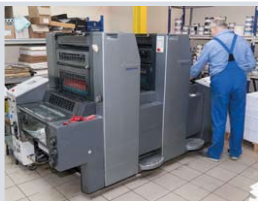
Двухкрасочная машина Speedmaster SM 52-2-P
