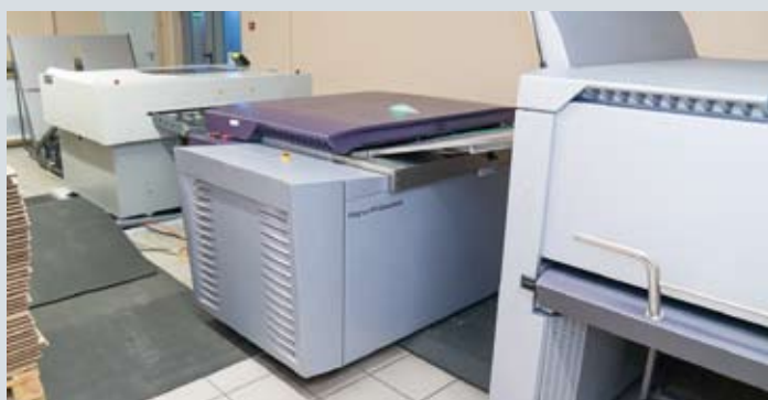
В типографии «ЛД-ПРИНТ» установлены два СтР-устройства Kodak Magnus 800. В прошлом году одну из линий (слева) полностью перевели на экологичную беспроцессную технологию экспонирования форм, демонтировав проявочную машину
