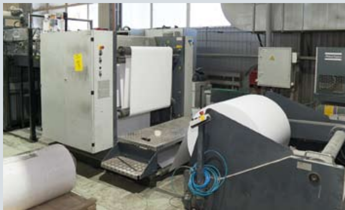
Для снижения себестоимости производства машины оснащены модулем работы с рулонными бумагами. Он разматывает рулон, режет его на листы заданного формата и подает на самонаклад
