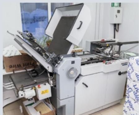
Послепечатный комплекс оборудования для производства книг как в твердом переплете с шитьем нитками, так и в мягкой обложке с КБС, а также брошюр на скобе
