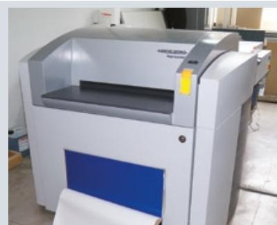
Для изготовления форм используются два одинаковых CtP SupraSetter A 75
