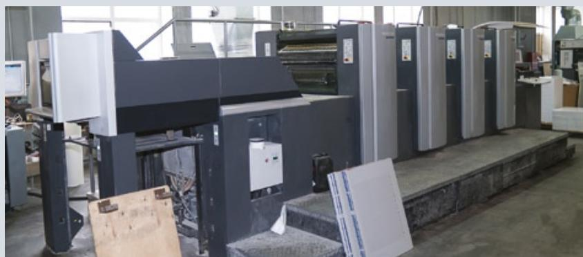
В «Юнион Принт» работают только машины Heidelberg: Printmaster PM-74-4, Speedmaster SM 74-5 и Speedmaster SX 74-4-H, что позволяет печатать быстро и качественно. Все три машины оснащены системами измерения и контроля цвета
