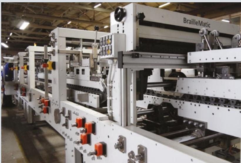
Фальцевально-склеивающая машина Versor Serto 80 оснащена системой считывания штрихкодов
