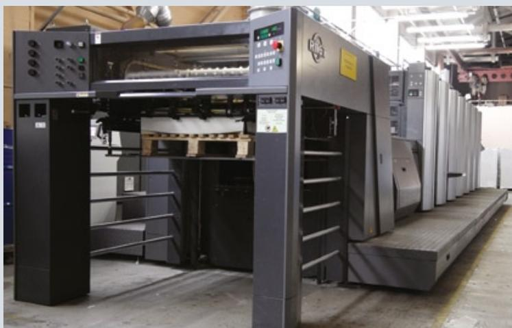
В типографии «Премиум Стандарт» установлена шестикрасочная печатная машина RMGT 790ST-6 с секцией лакирования, специально предназначенная для изготовления упаковочной продукции
