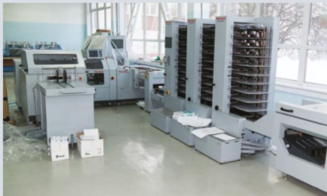
Комплекс полиграфического оборудования для изготовления многостраничной продукции (фальцевальная машина, листоподборочная линия, термоклеевая машина)
