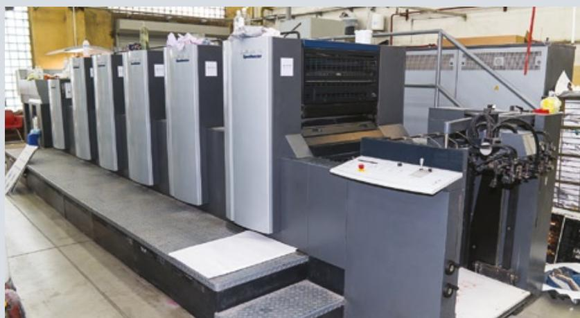
«Компания Боргес» обладает современным парком печатного оборудования на базе технологий Heidelberg. Здесь работают две офсетные машины: четырехкрасочная и пятикрасочная с секцией лакирования. Дублирование технологий позволяет избегать производственных нештатных ситуаций, чтобы они не сказывались на исполнении обязательств перед клиентами
