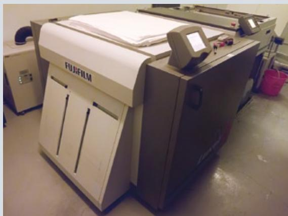
Для изготовления форм используется CtP-устройство Fujifilm и пластины Supperia Pro-V этого же производителя, поставляемые компанией «ЯМ Интернешнл»
