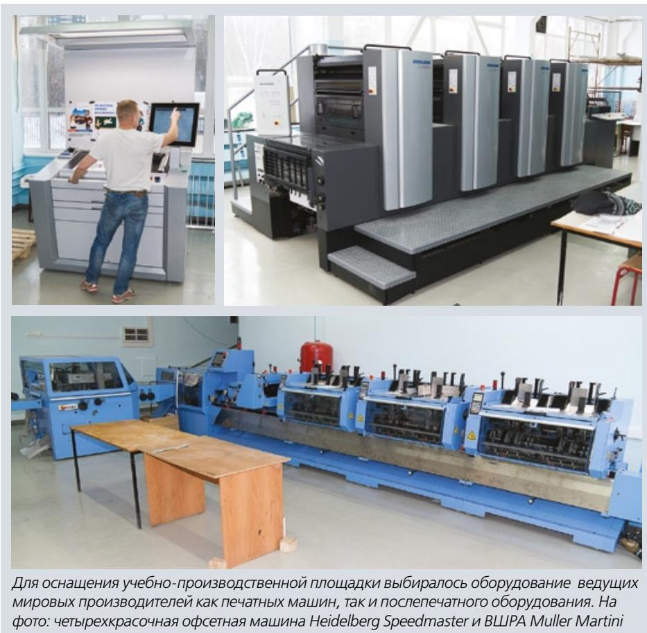
Для оснащения учебно-производственной площадки выбиралось оборудование ведущих мировых производителей как печатных машин, так и послепечатного оборудования. На фото: четырехкрасочная офсетная машина Heidelberg Speedmaster и ВЛШПА Muller Martini
