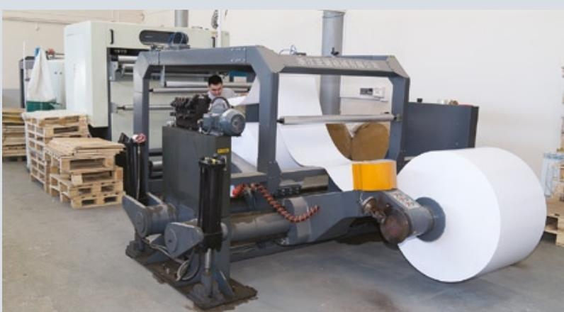
Типография в основном работает в сегменте производства рекламной полиграфии, которая отличается разнообразием форматов, поэтому на предприятии самостоятельно режут бумагу в ролях на листы требуемого формата
