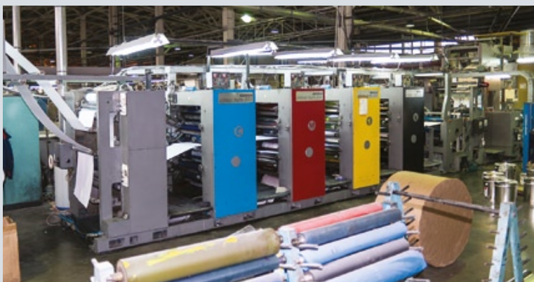
Для изготовления некоторых видов белой продукции используется рулонная офсетная печать с фальцовкой на выходе
