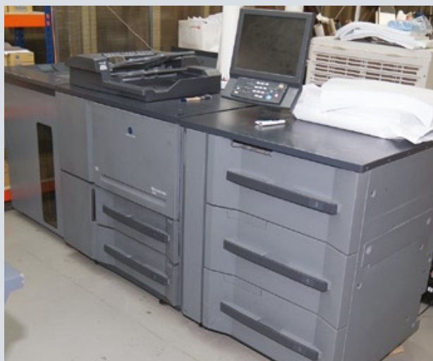
Монохромные книжные блоки выгоднее печатать на цифровых машинах черно-белой печати, таких как Konica Minolta bizhub PRESS 1250P и bizhub PRO 1051
