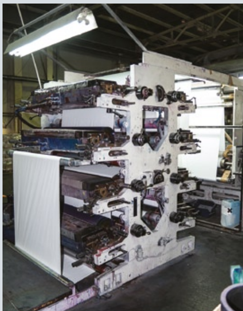
Изготовление тетрадей ведется на автоматизированной производственной линии, которая сначала линует рулонную бумагу, используя флексографские печатные секции (слева), а затем подбирает нарубленные листы и сшивает блоки проволокой (справа)
