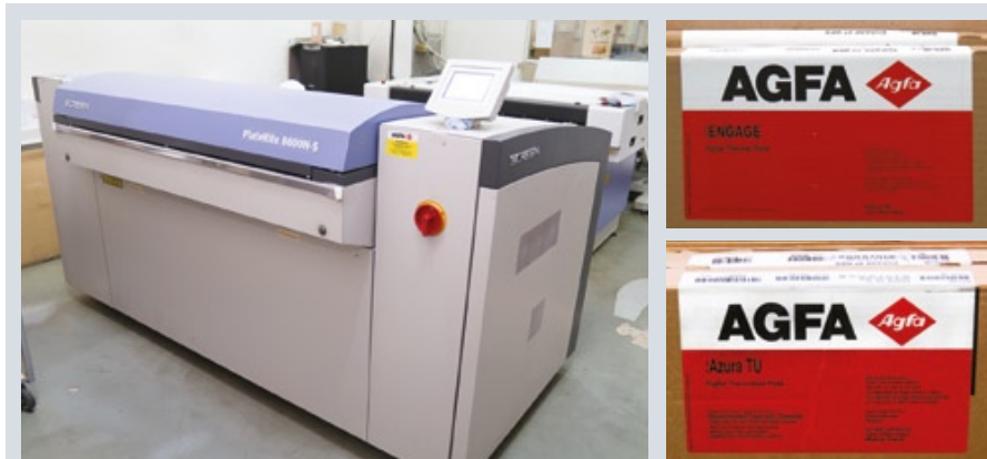
Изготовление форм в типографии «КЕМ» осуществляется на термальном выводном устройстве с использованием пластин компании Agfa. В настоящее время основной объем работ ведется на обычных термальных пластинах (Engage), но при этом начался процесс по переходу на экологичные бесхимические пластины (Azura)
