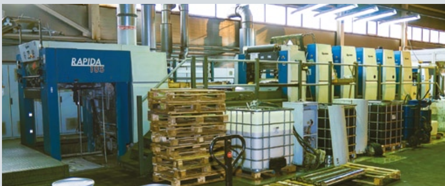
Печать тетрадных обложек и другой продукции ведется на офсетной машине KBA Rapida 105
