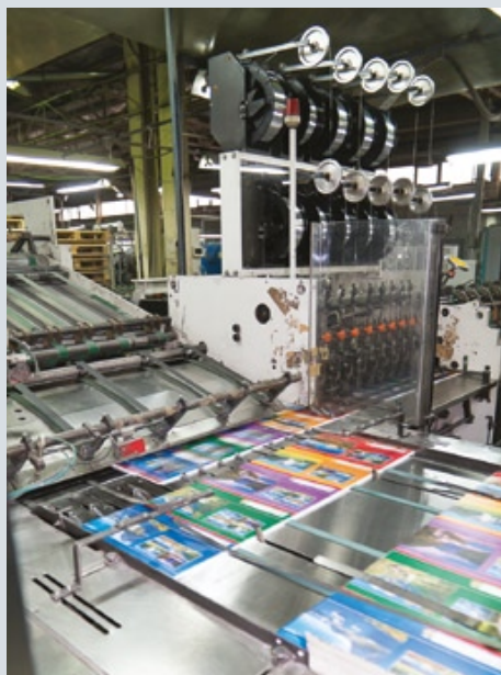
Изготовление тетрадей ведется на автоматизированной производственной линии, которая сначала линует рулонную бумагу, используя флексографские печатные секции (слева), а затем подбирает нарубленные листы и сшивает блоки проволокой (справа)
