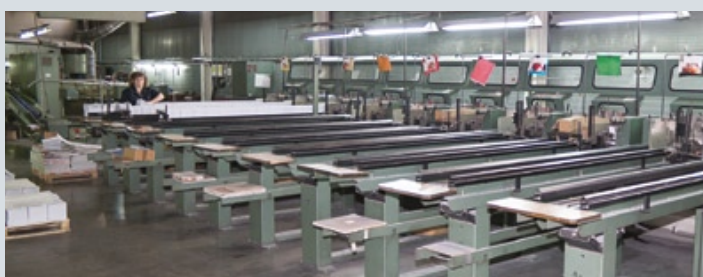
В компании Hatber отлажена технология изготовления толстых тетрадей методом бесшвейного скрепления
