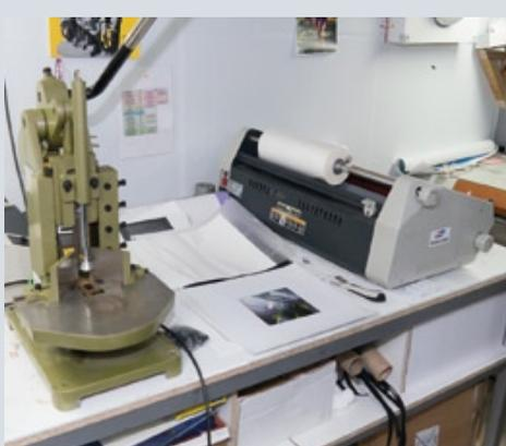
Процесс изготовления фотокниг основан на ручных операциях с использованием простого пооперационного оборудования, что оправданно, поскольку тиражи небольшие
