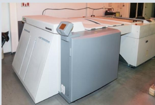
В типографии используются две технологии изготовления печатных форм: термальная и фиолетовая. Соответственно, и два типа формных пластин, все это малохимические материалы последнего поколения
