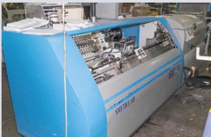
В типографии активно эксплуатируются ниткошвейные машины, предназначенные для работы с «цифровыми» отпечатками...
