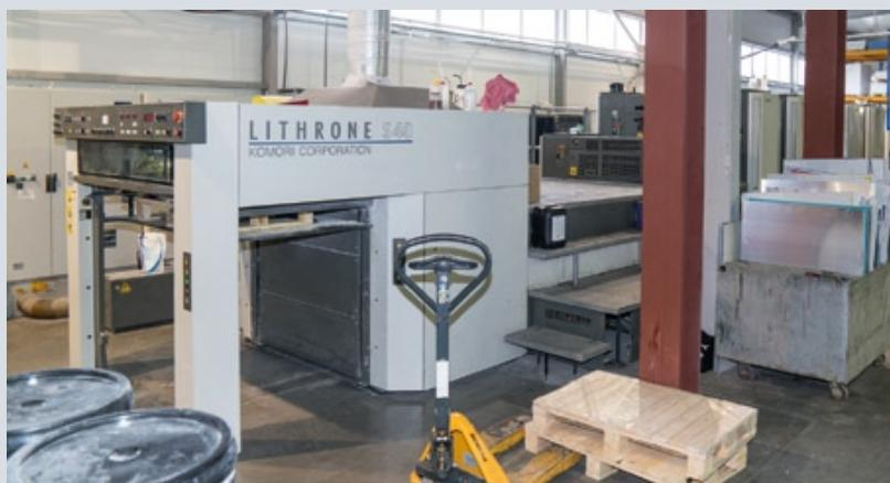
Печатный парк типографии UVI-Print состоит из двух печатных машин: восьмисекционной Komori Lithrone S29 с секцией холодного тиснения фольгой и возможностью УФ-печати, а также пятикрасочной Komori Lithrone S40
