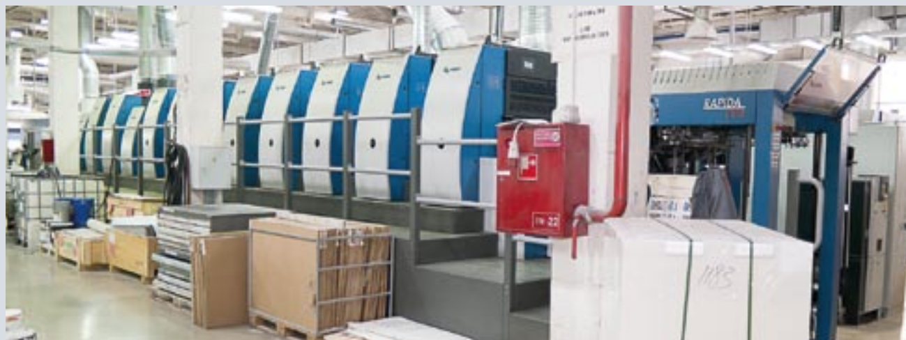
Дальнейшее развитие печатного производства Grafobal-Don было связано с печатными машинами концерна KBA. В типографии установлено две восьмикрасочные с двумя лакировальными секциями машины KBA Rapida 106
