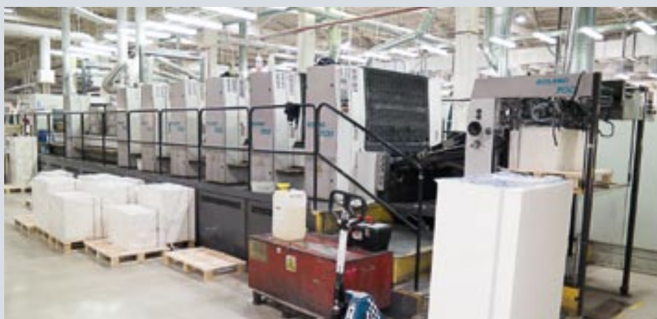
Производство сигаретной пачки на заводе Grafobal-Don началось с печатных машин Roland и вырубных прессов BOBST, привезенных в Ростов-на-Дону из европейской типографии
