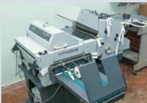
Комплекс послепечатного оборудования Horizon, приобретенный вместе с цифровыми печатными машинами, позволяет выполнять все необходимые послепечатные операции по превращению отпечатанных листов в книги или брошюры
