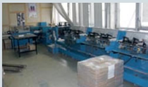
В типографии «КЕМ» есть все виды послепечатной обработки: фальцовка, шитье нитками, а также потетрадная подборка и скрепление проволочными скобами
