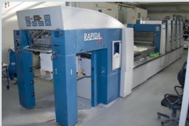
Вся печатная техника в типографии «Триада ЛТД» произведена концерном KBA. Вначале здесь использовались полуформатные машины, но затем была установлена машина формат 105x74
