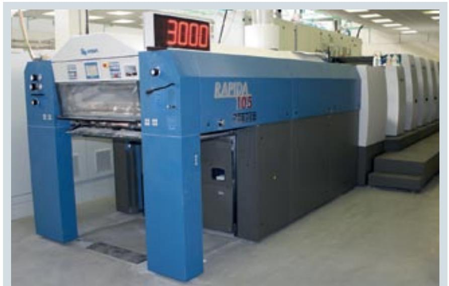
Установленная пятисекционная KBA Rapida 105 имеет максимальный формат 1040x740 мм и позволяет печатать листы формата A1+. Скорость печати достигает 18 000 отт./ч. Перенастройка на другой тираж занимает 10 мин
