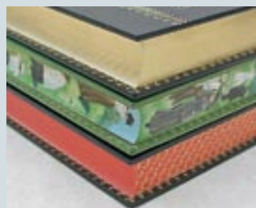
Виды декорирования книжных обрезов — окраска, тиснение золотом вручную
