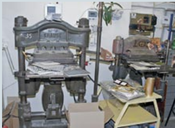
Слева: цех ручного тиснения, справа: прессы для тиснения и обжима блоков (этому оборудованию более 100 лет)
