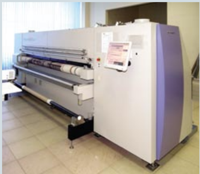
Широкоформатный струйный УФ-принтер Screen Truepress Jet2500UV, установленный в типографии «Печатный двор Кубани». Он позволяет запечатывать как традиционные для полиграфии материалы, так и любые сложные поверхности (стекло, дерево, пластик и т. д.) толщиной до 5 см. С появлением этого УФ-принтера началось развитие совершенно нового для типографии бизнес-направления. Это позволило предлагать услуги по печати широкоформатной рекламы и интерьерной графики, в том числе на нестандартных носителях
