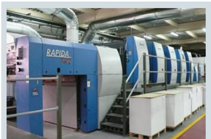
На производстве компании «ПРИЗМА» установлена пятикрасочная машина KBA Rapida 142 с секцией лакирования. Она ориентирована главным образом на производство картонной упаковки. Большой формат машины позволяет печатать листы картона размером до 1020x1420 мм
