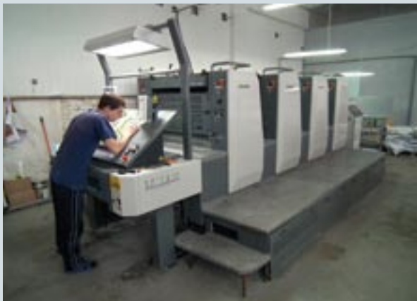
В типографии «Аркол» установлены две четырехкрасочные машины Komori: Spica 29 (слева) и Lithrone S29 (справа)
