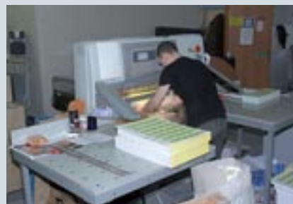
В выборе послепечатной техники «Зетапринт» также делает ставку на оборудование марки Heidelberg: здесь установлены линия KBC Eurobind 1300, фальцевальная машина Stahlfolder и резальные машины Polar
