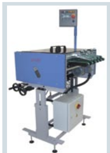
Ножевой фальцаппарат для «дофальцовывания» тетрадей или фальцовки по линии шитья при изготовлении брошюр
