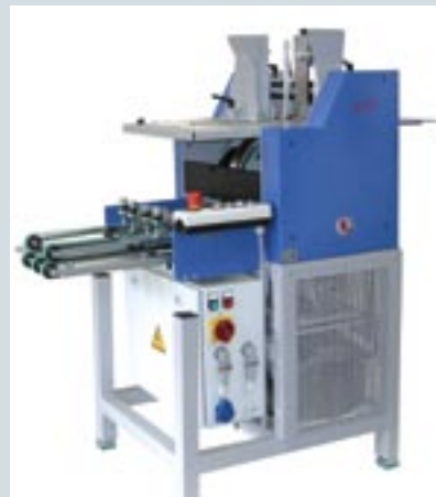
Устройство для подачи сфальцованных тетрадей или готовых шитых брошюр на дальнейшую обработку (например, вырубку, разрезку или дофальцовку)
