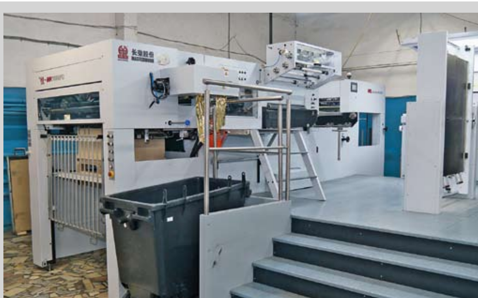
Новое приобретение типографии «Харменс Молоково» — автоматизированный пресс для тиснения фольгой Masterwork EcoFoil 106FC
