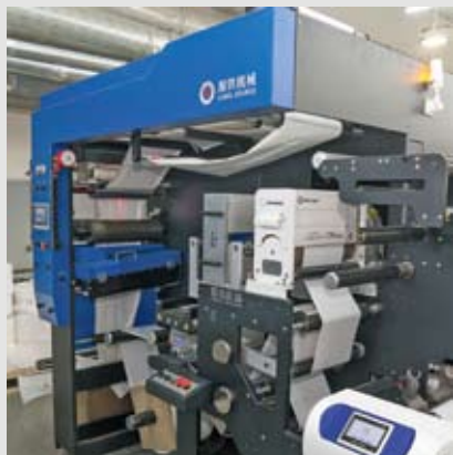
В 2024 г. типография приобрела машину Label Source YTP-F6-370-12C с автосклейкой и уникальной системой сбора и прессования облоя
