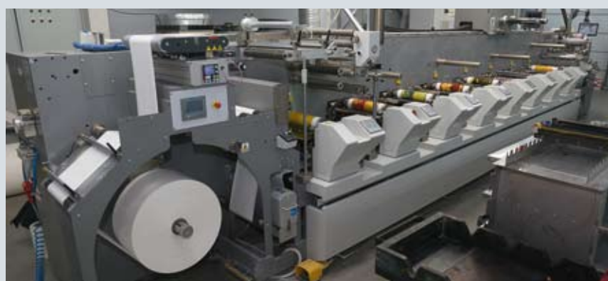
Машина Bobst M5 в типографии KiMa Flex и станция для монтажа печатных форм на формный цилиндр
