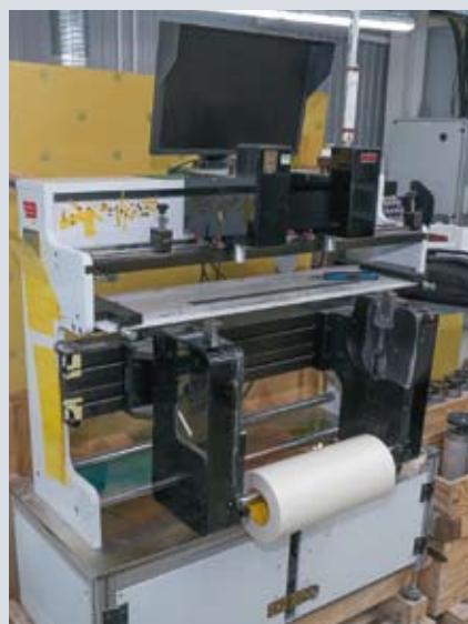
Машина Bobst M5 в типографии KiMa Flex и станция для монтажа печатных форм на формный цилиндр
