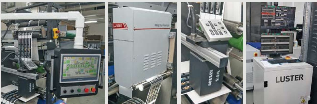
Система автоматического видеоконтроля качества продукции компании Luster интегрирована во вторую машину LabelSource
