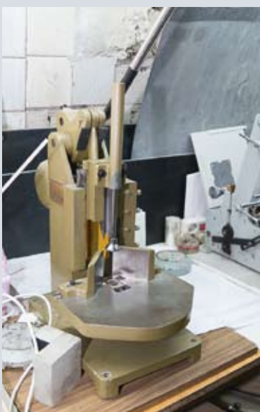
Ручные станки позволяют осуществлять разные отделочные операции для цифровых отпечатков: вырубку, тиснение, конгрев и т.д.
