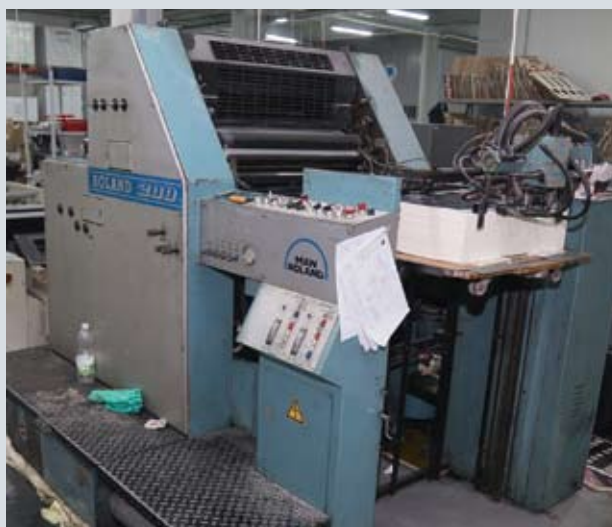
В типографии множество различного оборудования для изготовления коммерческой продукции. Однокрасочная печатная машина переделана в машину УФ-лакирования
