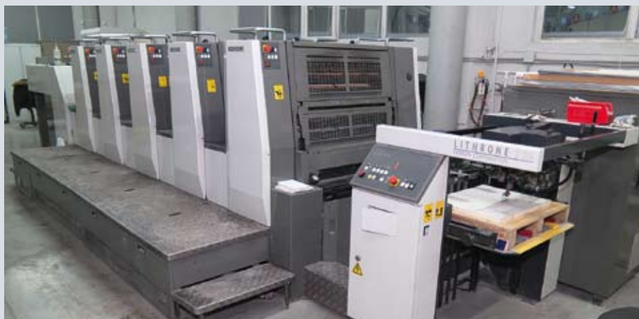
Подразделение офсетной печати «Типографии ВК» укомплектовано четырех- и пятикрасочными печатными машинами японского производства
