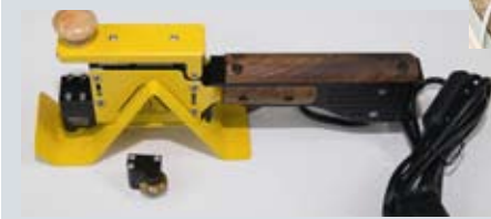
Ручные станки позволяют осуществлять разные отделочные операции для цифровых отпечатков: вырубку, тиснение, конгрев и т.д.
