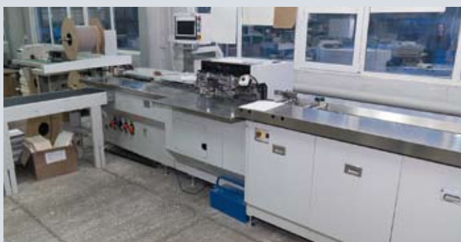
В типографии множество различного оборудования для изготовления коммерческой продукции. Однокрасочная печатная машина переделана в машину УФ-лакирования
